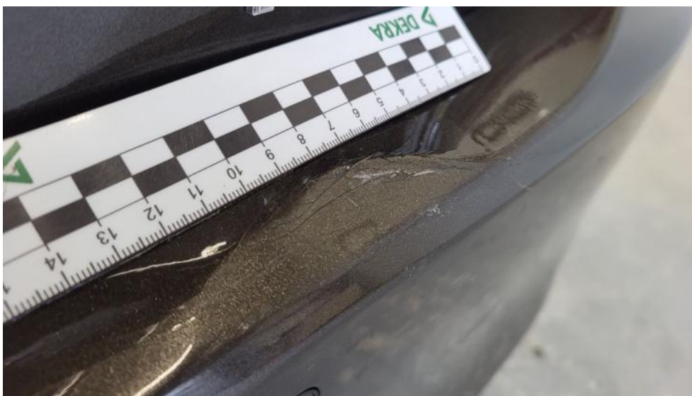
Fot. 59. Zderzak tylny - Pęknięcie/rozerwanie 1
