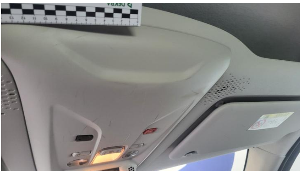
Fot. 62. Włączniki/przeł. podsufitki - Rysa/odprysk 1
