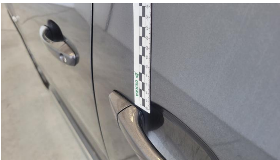
Fot. 52. Drzwi tylne L - Rysa/odprysk 1
