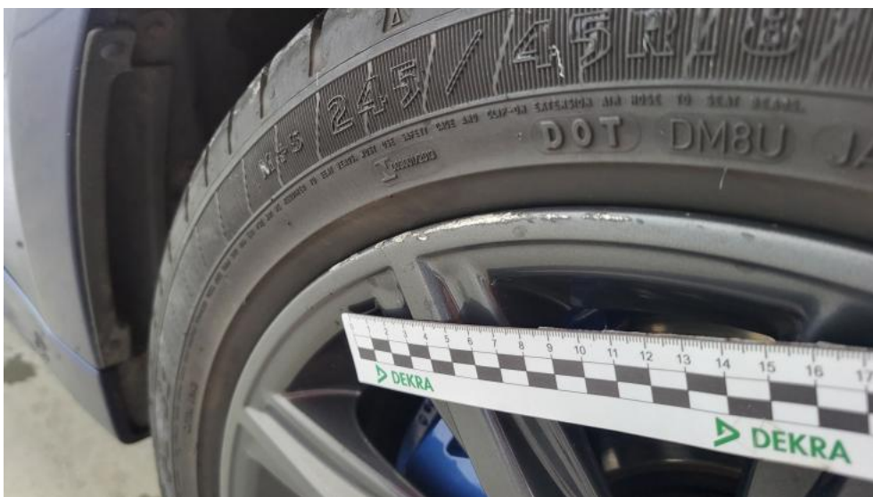
Fot. 52. Felga aluminiowa przednia P - Rysa/odprysk 1
