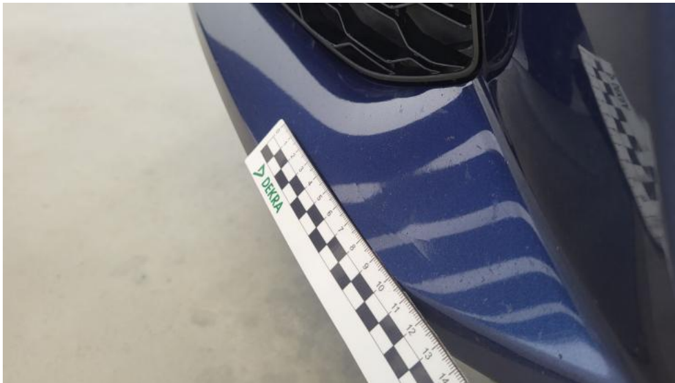
Fot. 51. Zderzak - Pęknięcie/rozerwanie 2
