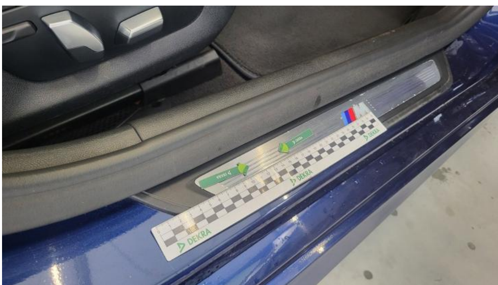
Fot. 56. Próg P - Wgniecenie/odkształcenie 1
