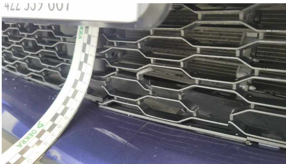
Fot. 42. Krata zderzaka prz. - Pęknięcie/rozerwanie 1
