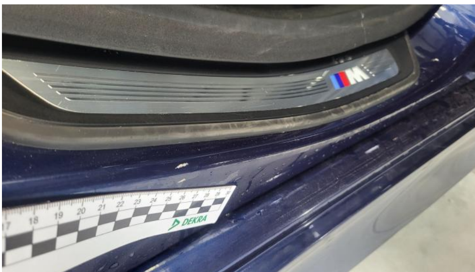
Fot. 55. Próg P - Rysa/odprysk 1
