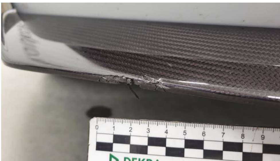
Photo 75. Spoiler zderzaka przedniego() - Pęknięcie/rozerwanie 3
