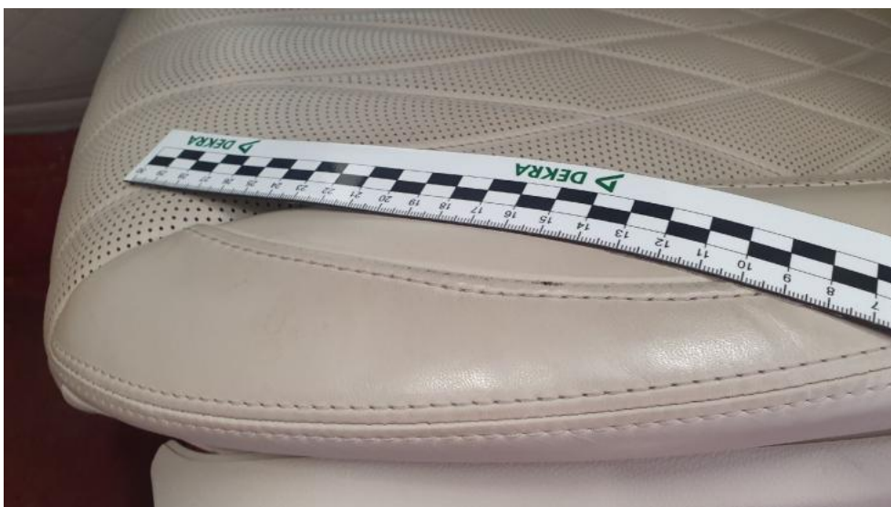
Photo 64. Fotel prz. lew. - Rysa/odprysk 1
