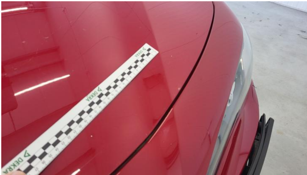
Fot. 47. Pokrywa komory silnika - Rysa/odprysk 1
