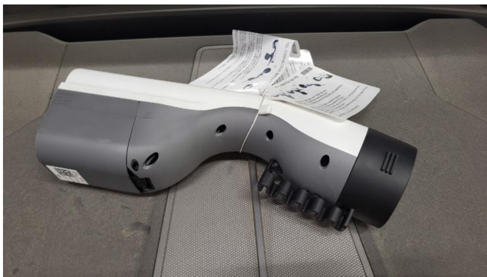
Fot. 36. Przewód ładowania baterii trakcyjnej
