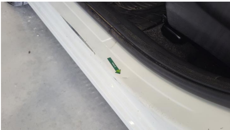
Photo 62. Próg L - Wgniecenie/odkształcenie 1
