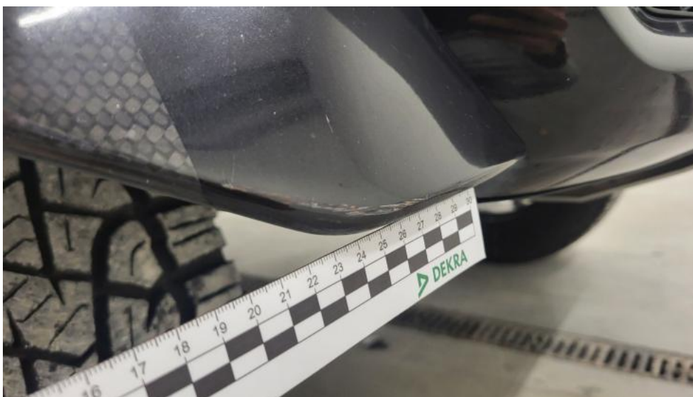
Photo 71. Nadkole przednie P - Rysa/odprysk 1
