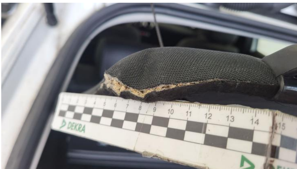
Photo 61. Półka/roleta tylna - Pęknięcie/rozerwanie 1
