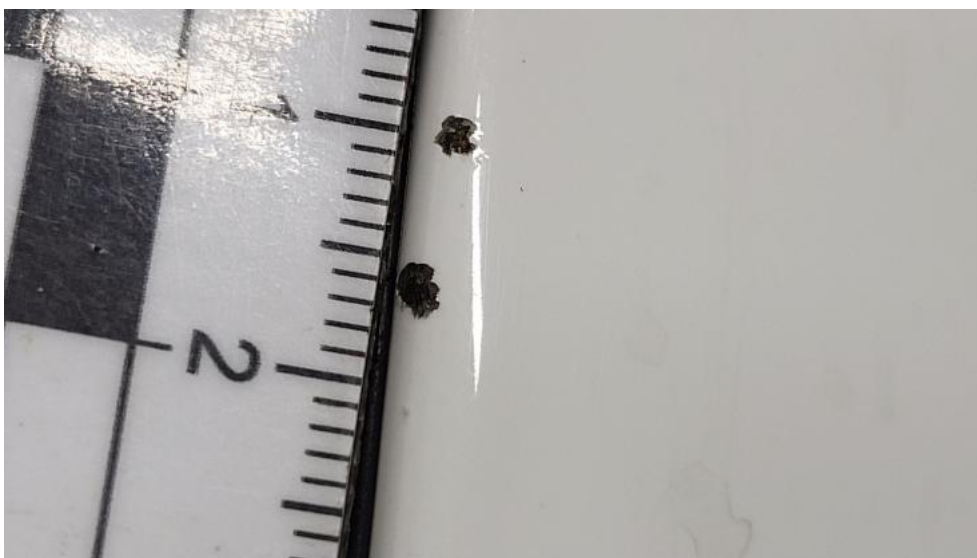
Photo 56. Stupek przedni L - Rysa/odprysk 2
