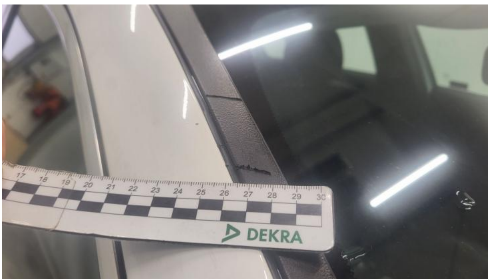
Photo 39. Uszczelka/listwa szyby czołowej - Rysa/odprysk 1
