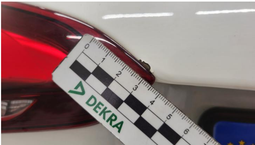
Photo 45. Pokrywy bagażnika - Rysa/odprysk 1
