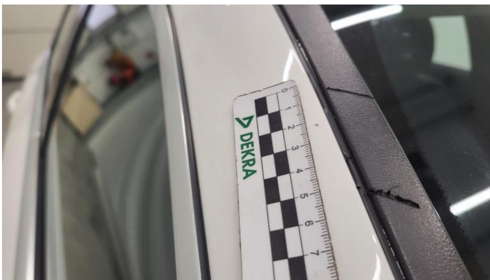
Photo 41. Stupek przedni P - Rysa/odprysk 1
