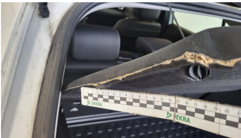
Photo 62. Półka/roleta tylna - Pęknięcie/rozerwanie 2
