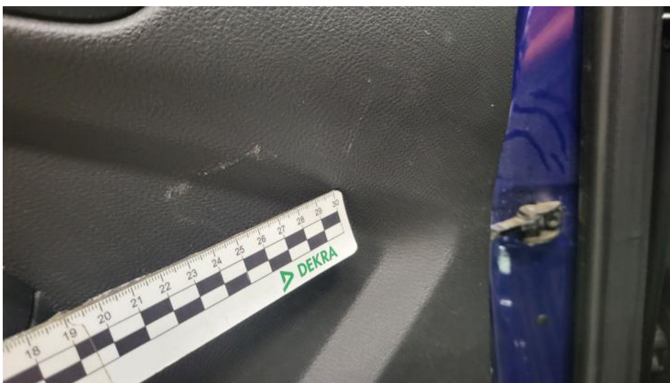
Photo 60. Tapicerka drzwi tylnych L - Rysa/odprysk 1
