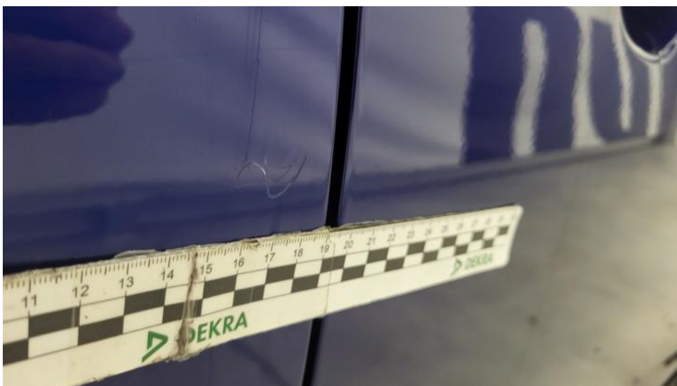
Photo 44. Drzwi tylne P - Rysa/odprysk 1
