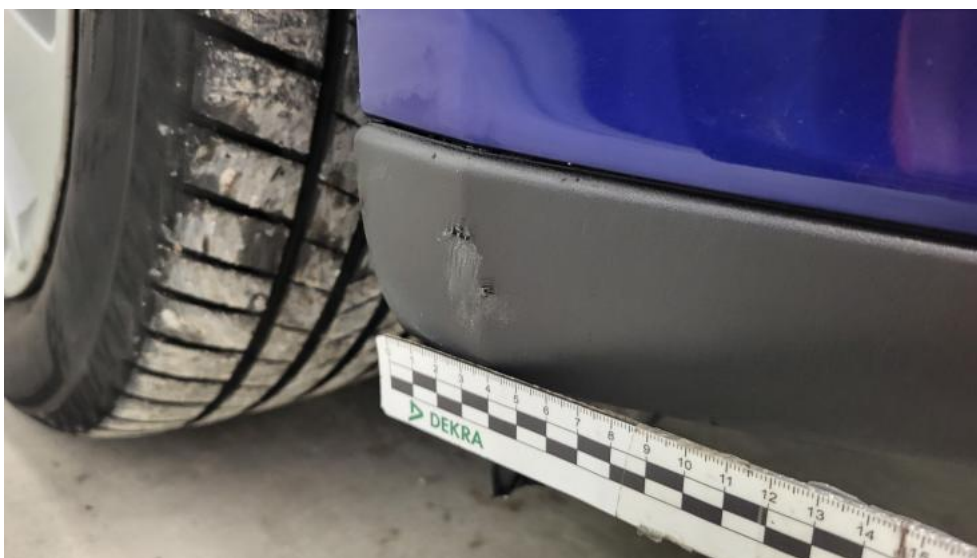
Photo 42. Zderzak przedni cz dolna - Rysa/odprysk 1
