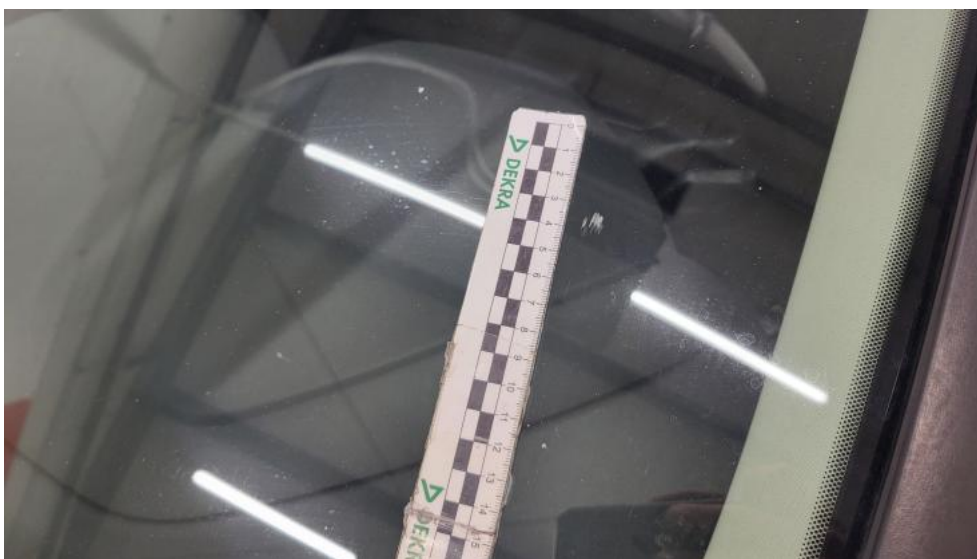
Photo 39. Szyba czołowa - Rysa/odprysk 1
