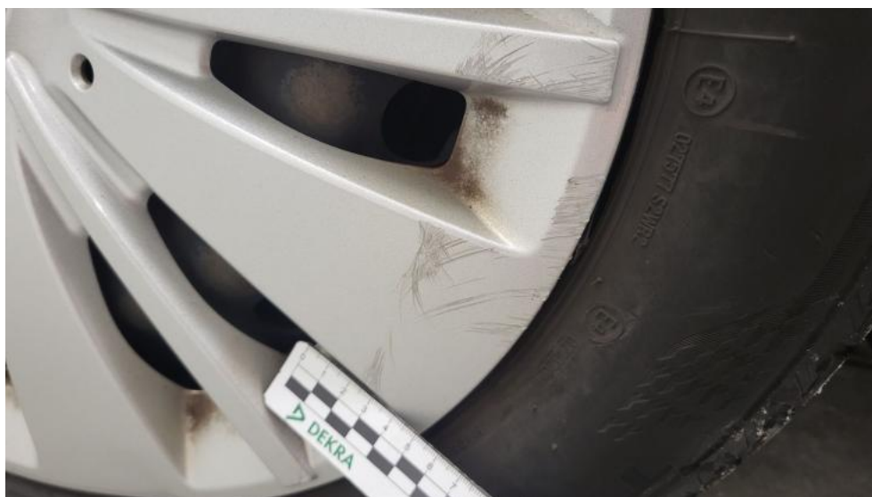
Photo 56. Kołpak przedni L - Rysa/odprysk 1
