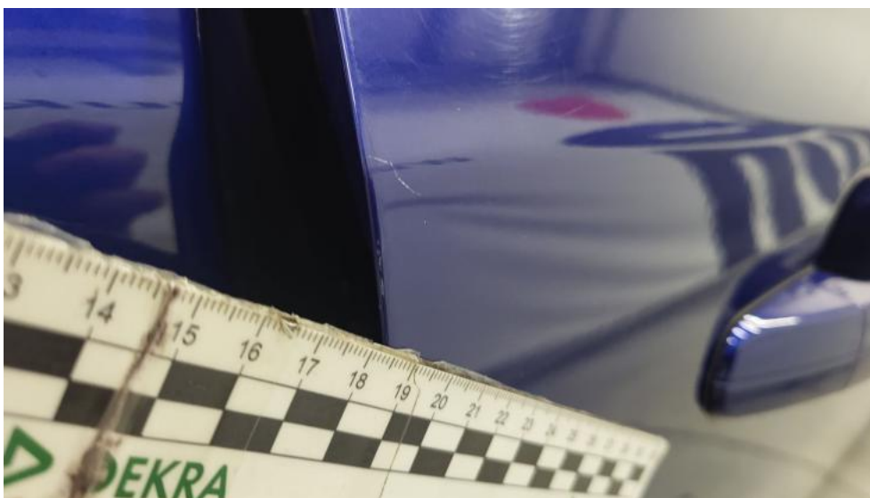
Photo 45. Drzwi tylne P - Rysa/odprysk 2
