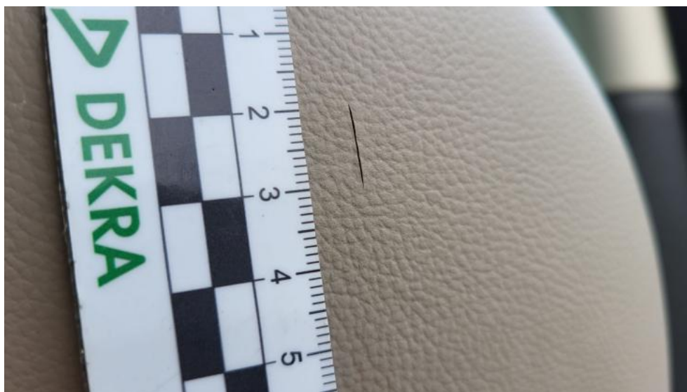
Photo 61. Fotel prz. praw. - Pęknięcie/rozerwanie 2
