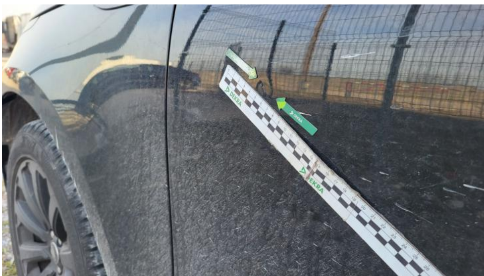
Photo 54. Drzwi przed L - Wgniecenie/odkształcenie 2
