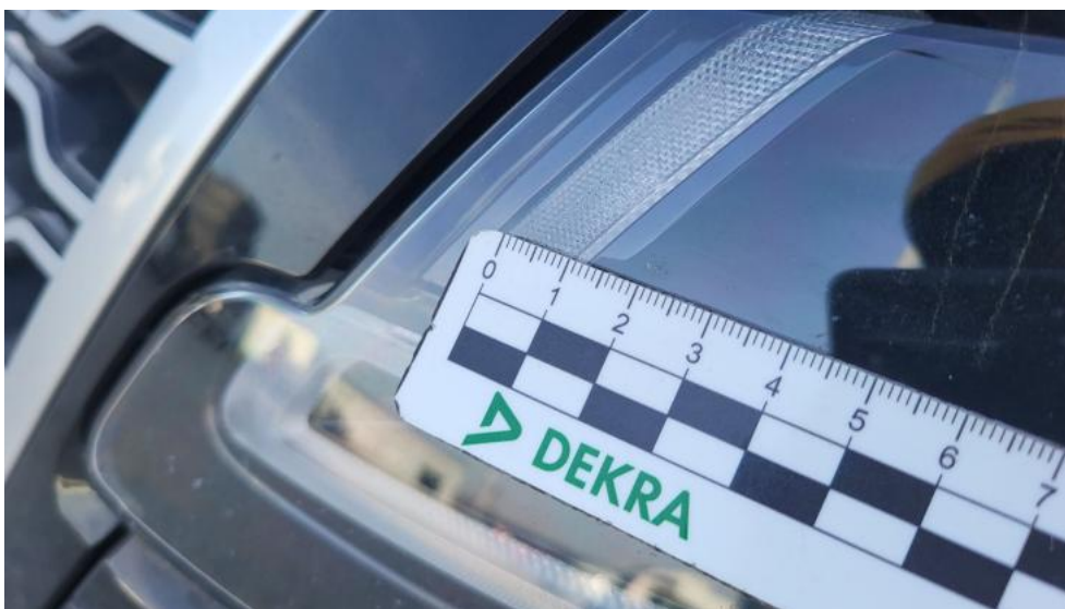
Photo 55. Reflektor L - Rysa/odprysk 1
