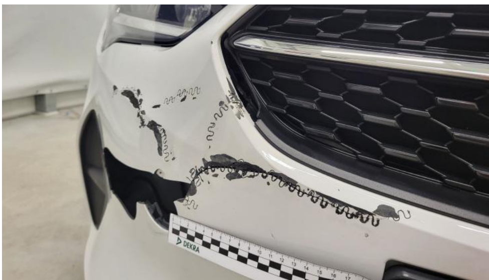
Fot. 47. Zderzak - Rysa/odprysk 1
