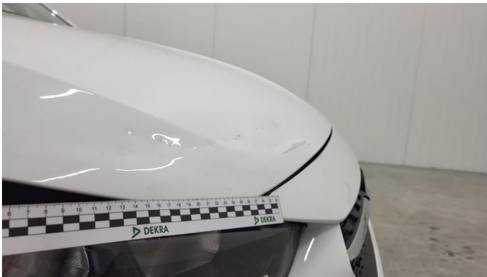
Fot. 45. Pokrywa komory silnika() - Wgniecenie/odkształcenie 3
