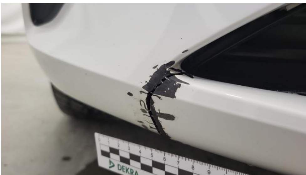
Fot. 54. Zderzak() - Pęknięcie/rozerwanie 3
