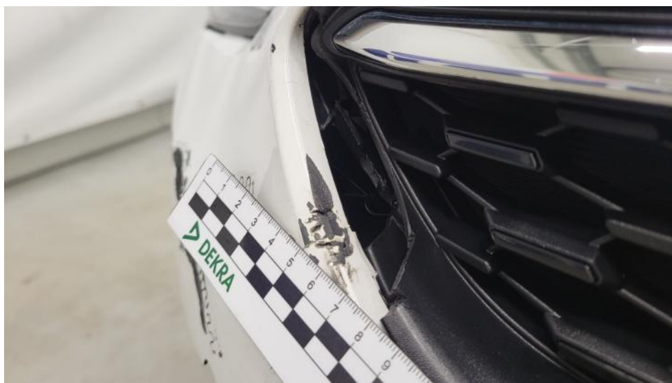
Fot. 38. Atrapa przednia - Pęknięcie/rozerwanie 1
