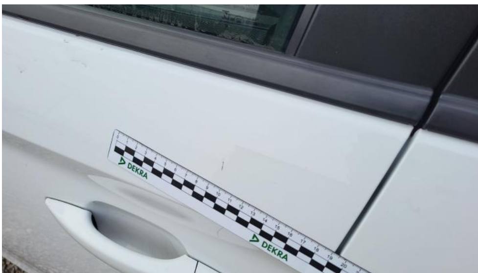
Fot. 69. Drzwi przed L - Wgniecenie/odkształcenie 1
