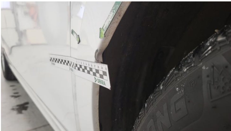
Fot. 57. Błotnik przedni P - Wgniecenie/odkształcenie 1
