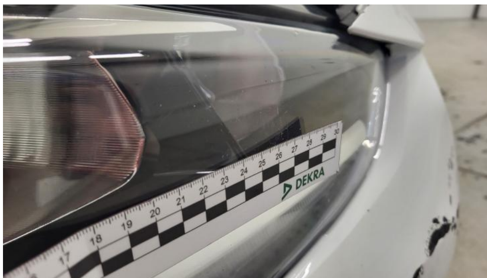
Fot. 59. Reflektor P - Rysa/odprysk 1
