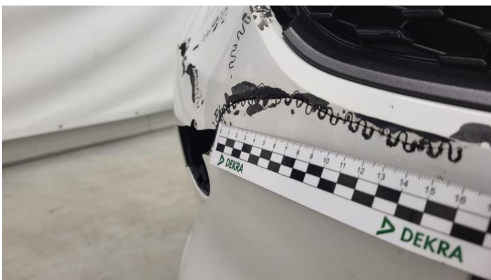
Fot. 50. Zderzak - Wgniecenie/odkształcenie 1
