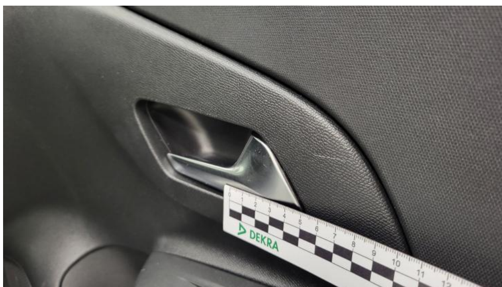
Fot. 78. Tapicerka drzwi przednich P - Rysa/odprysk 1
