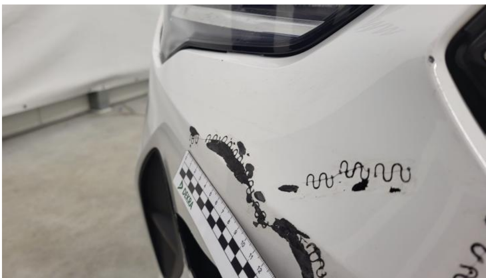
Fot. 51. Zderzak - Wgniecenie/odkształcenie 2
