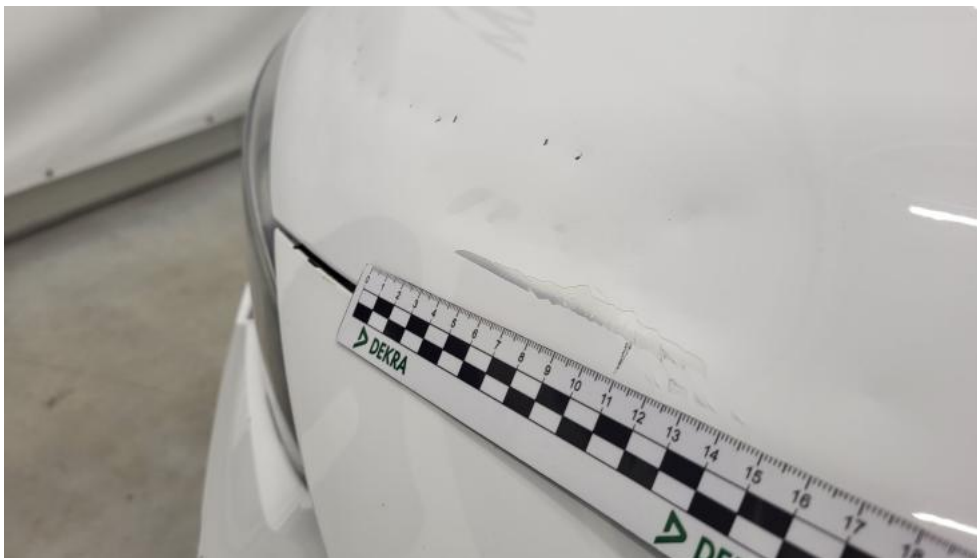
Fot. 41. Pokrywa komory silnika - Rysa/odprysk 1
