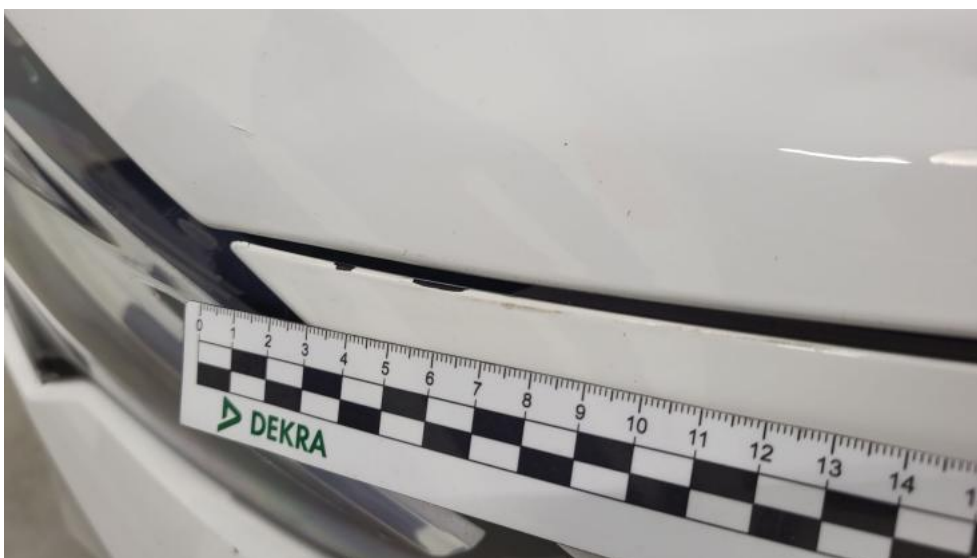
Fot. 48. Zderzak - Rysa/odprysk 2
