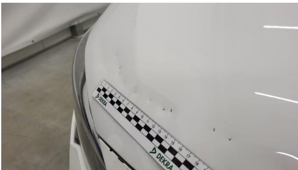
Fot. 42. Pokrywa komory silnika - Rysa/odprysk 2
