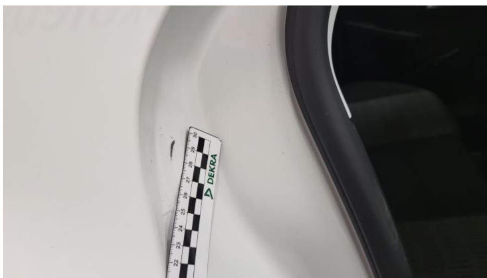
Fot. 64. Błotnik tylny P / Ściana boczna P - Rysa/odprysk 1
