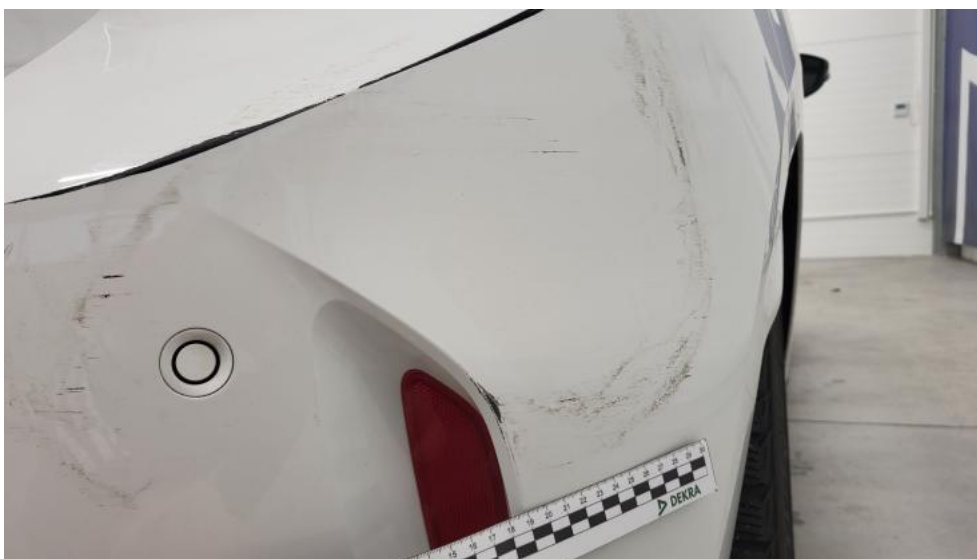
Fot. 67. Zderzak tylny() - Rysa/odprysk 3
