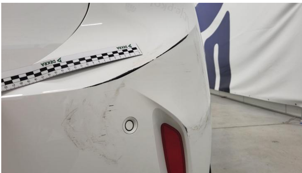
Fot. 65. Zderzak tylny - Rysa/odprysk 1
