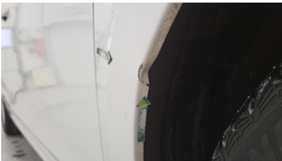
Fot. 58. Błotnik przedni P - Wgniecenie/odkształcenie 2
