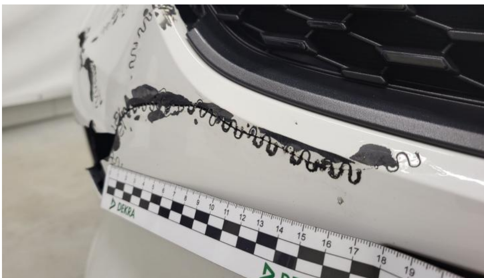
Fot. 53. Zderzak - Pęknięcie/rozerwanie 2
