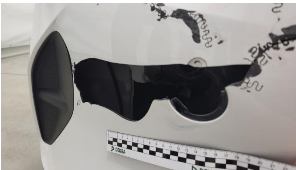
Fot. 52. Zderzak - Pęknięcie/rozerwanie 1
