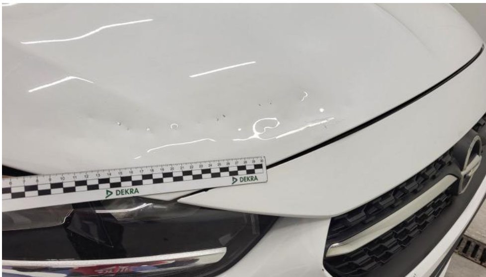
Fot. 43. Pokrywa komory silnika - Wgniecenie/odkształcenie 1
