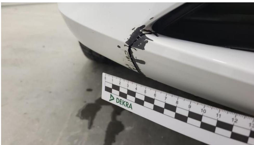
Fot. 49. Zderzak() - Rysa/odprysk 3
