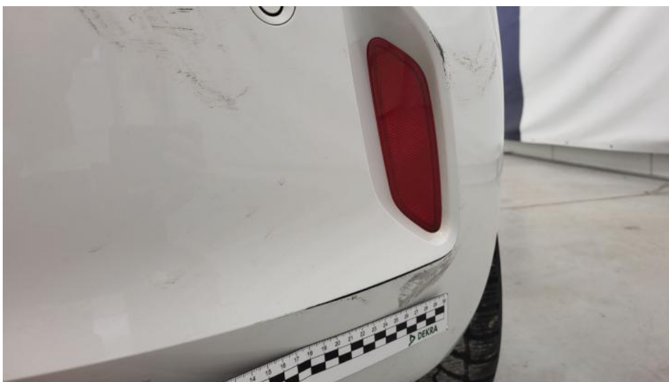
Fot. 66. Zderzak tylny - Rysa/odprysk 2
