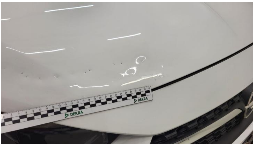
Fot. 44. Pokrywa komory silnika - Wgniecenie/odkształcenie 2
