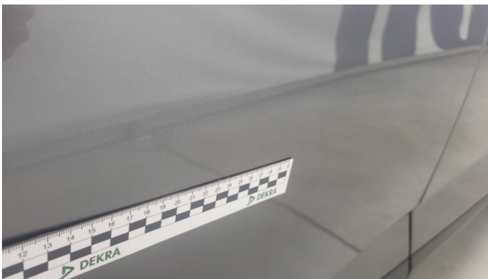
Photo 36. Drzwi tylne P - Rysa/odprysk 1
