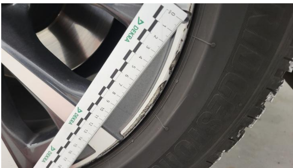
Fot. 44. Felga aluminiowa przednia P - Rysa/odprysk 1
