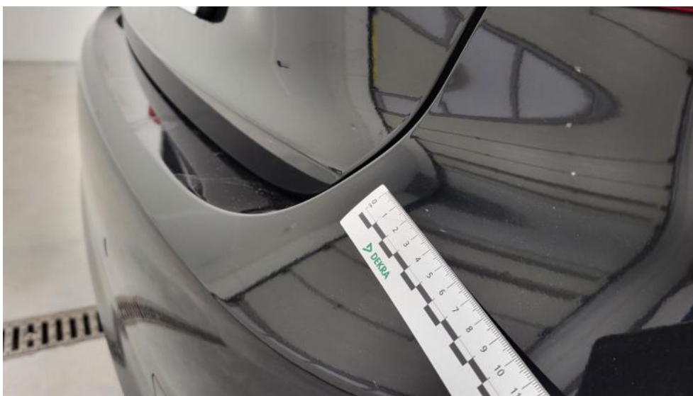
Fot. 49. Zderzak tylny - Rysa/odprysk 1
