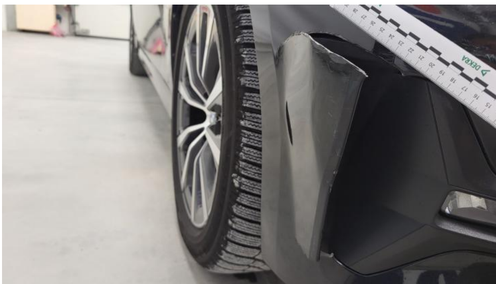
Fot. 43. Zderzak - Pęknięcie/rozerwanie 1
