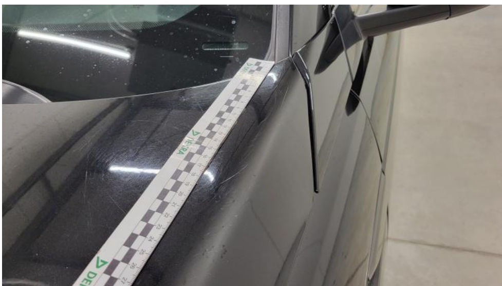
Fot. 38. Pokrywa komory silnika - Rysa/odprysk 1
