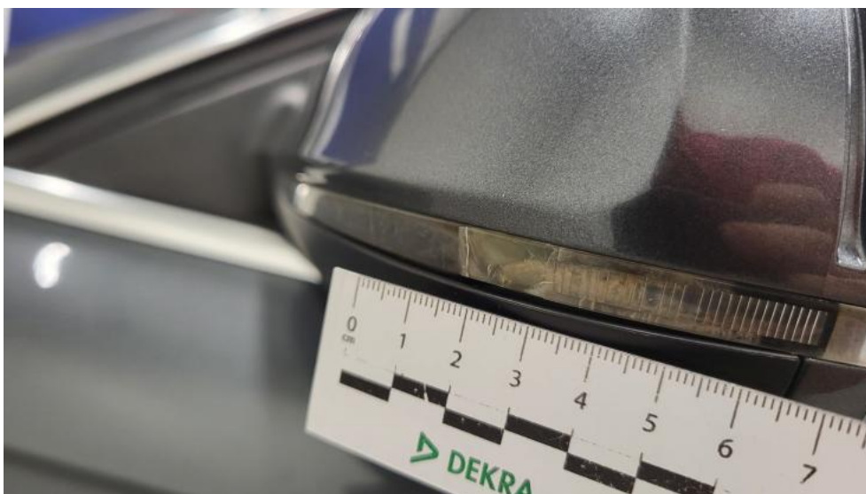
Fot. 76. Lusterko zew L - Pęknięcie/rozerwanie 1
