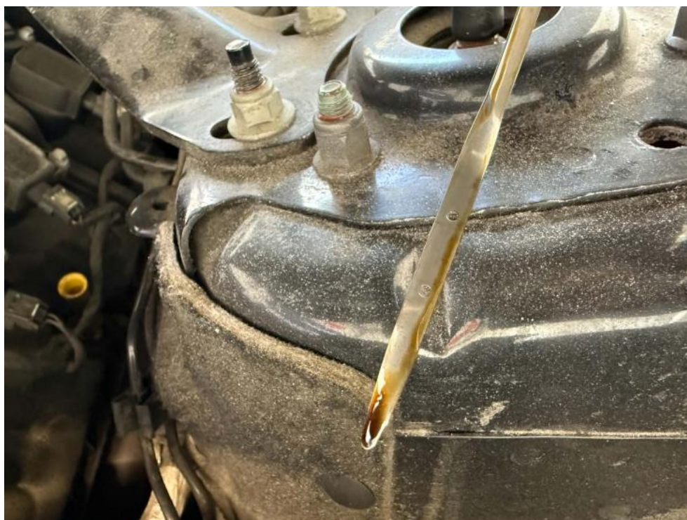
Fot. 62. Niski poziom oleju silnikowego.
