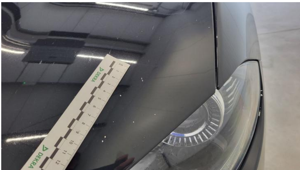
Fot. 36. Pokrywa komory silnika - Rysa/odprysk 1
