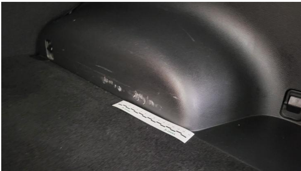
Photo 65. Wykładzina przestrzeni bagażowej - Rysa/odprysk 1
