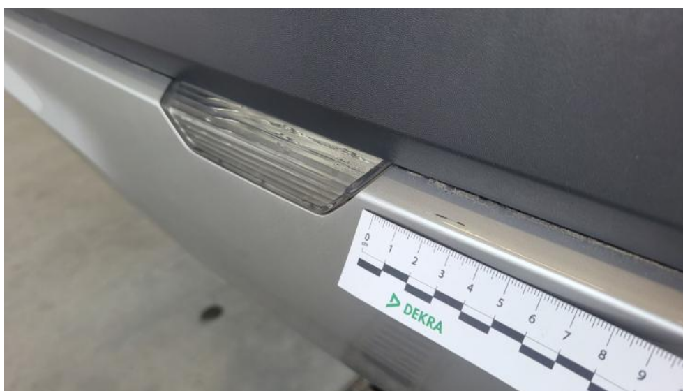
Photo 50. Zderzak tylny cz dolna - Rysa/odprysk 1
