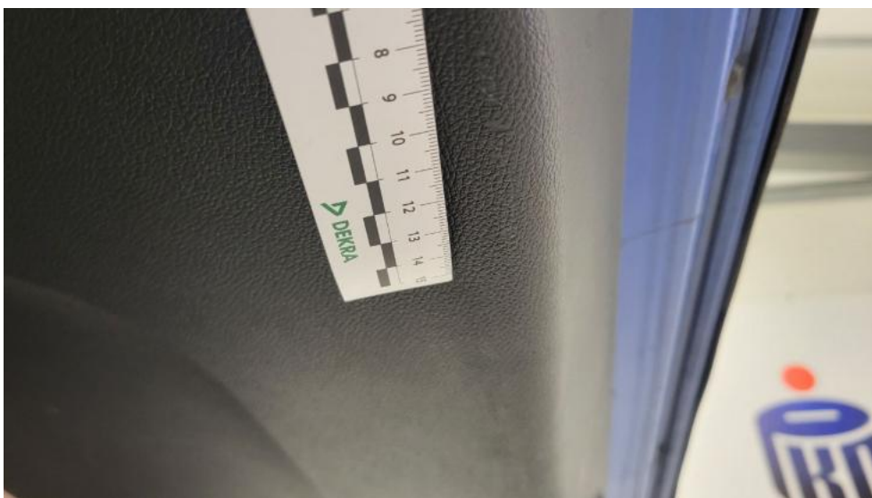
Photo 64. Wykładzina pokrywy tylnej - Rysa/odprysk 1
