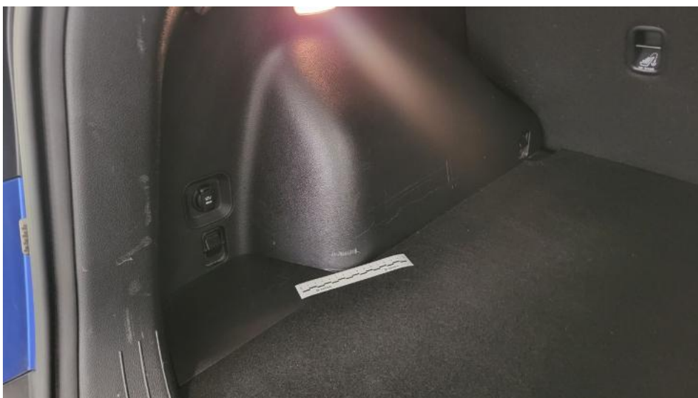
Photo 66. Wykładzina przestrzeni bagażowej - Rysa/odprysk 2
