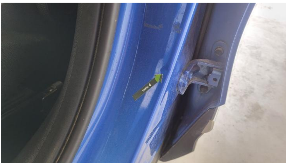
Photo 56. Próg L - Wgniecenie/odkształcenie 1
