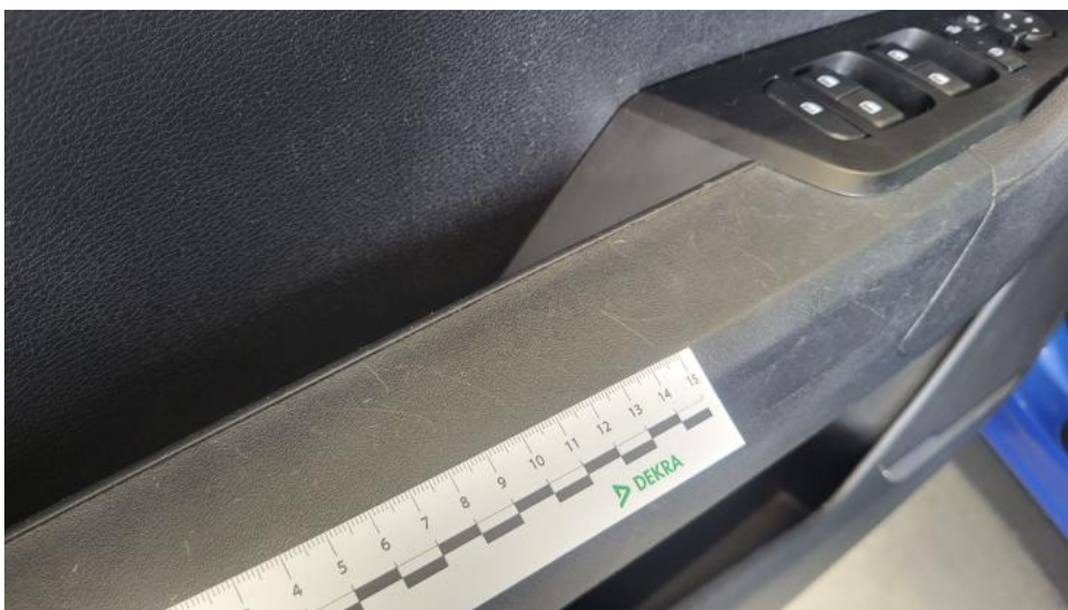
Photo 60. Tapicerka drzwi przednich L - Rysa/odprysk 1
