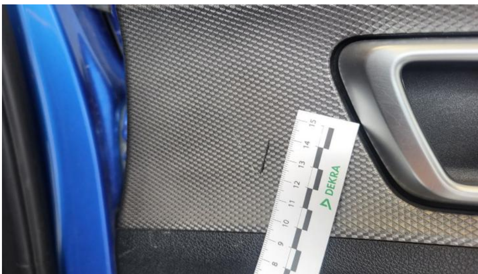
Photo 61. Tapicerka drzwi tylnych P - Rysa/odprysk 1
