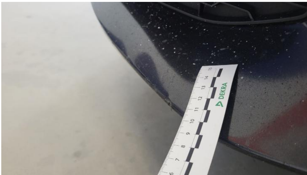
Fot. 47. Zderzak - Wgniecenie/odkształcenie 2
