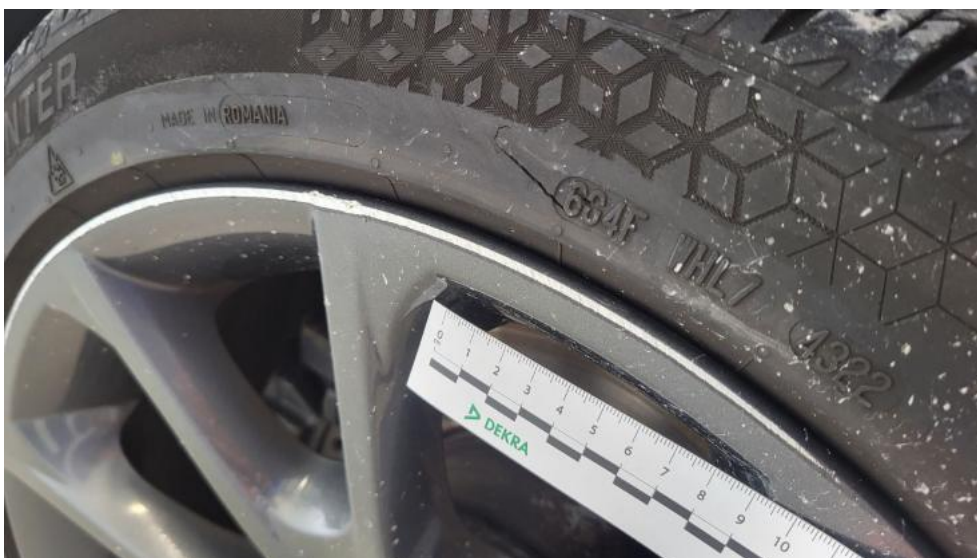
Fot. 50. Felga aluminiowa przednia P - Rysa/odprysk 1
