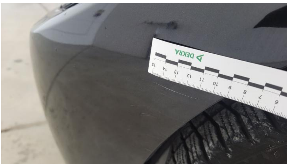
Fot. 44. Zderzak - Rysa/odprysk 1
