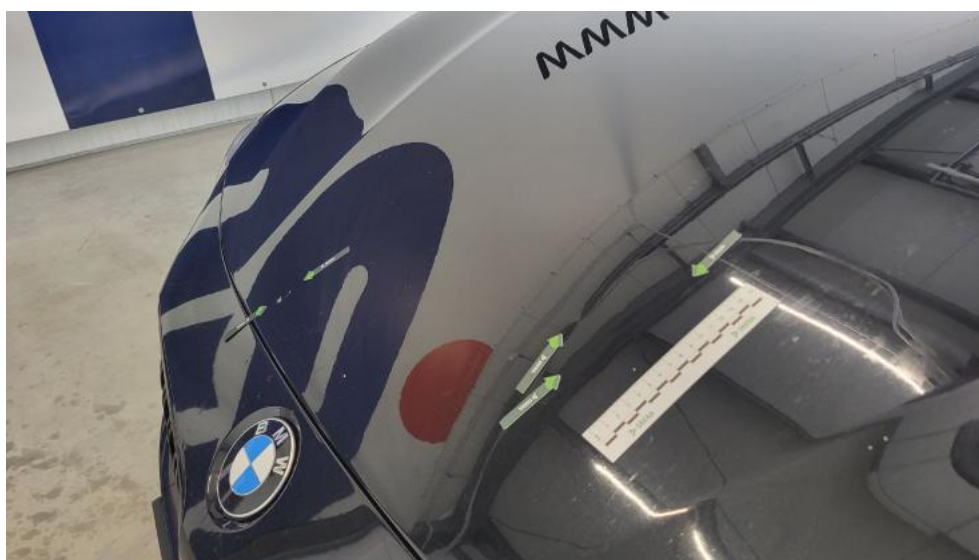
Fot. 42. Pokrywa komory silnika - Wgniecenie/odkształcenie 1
