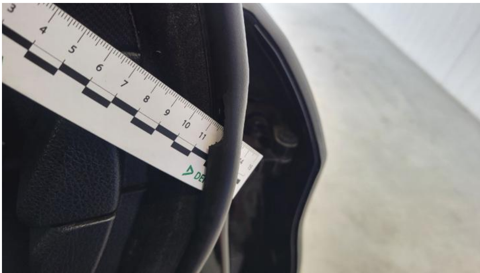
Fot. 85. Uszczelka drzwi przednich L - Pęknięcie/rozerwanie 1
