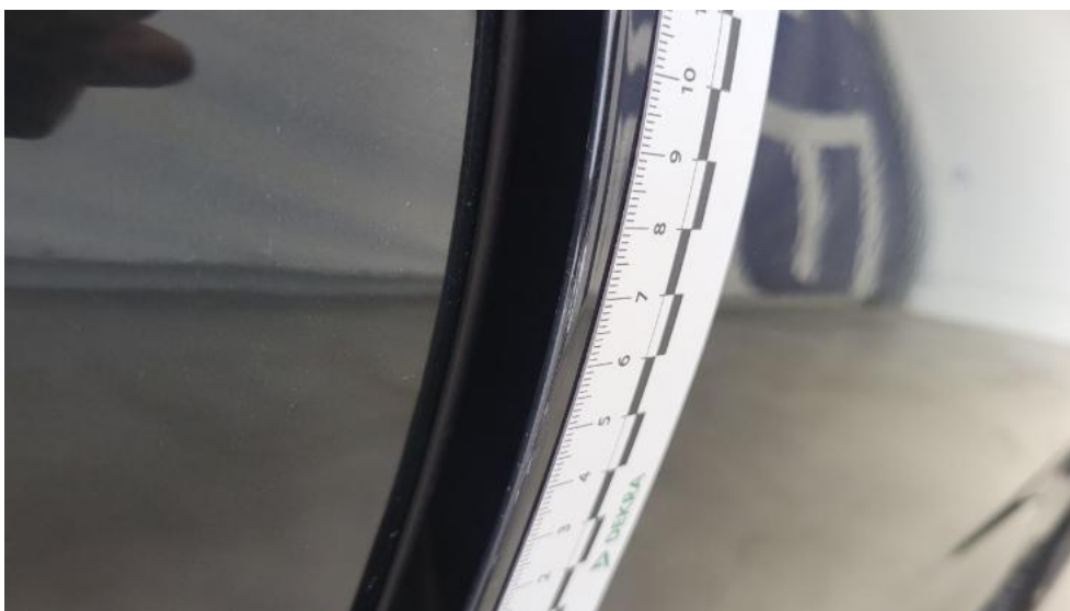
Fot. 52. Drzwi przednie P - Rysa/odprysk 1
