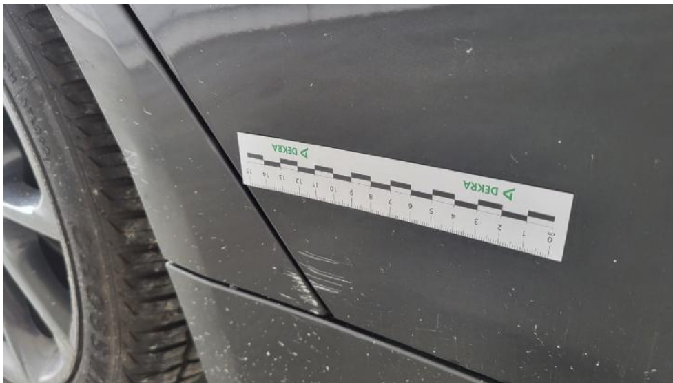
Fot. 55. Drzwi tylne P - Rysa/odprysk 1
