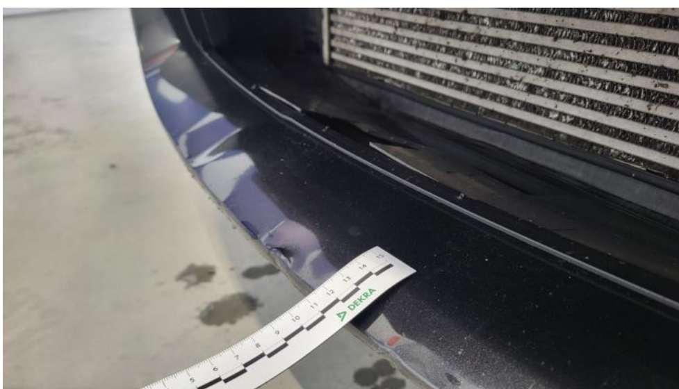
Fot. 46. Zderzak - Wgniecenie/odkształcenie 1
