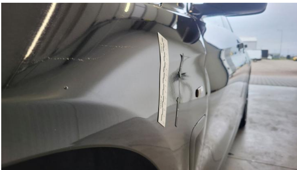
Fot. 76. Błotnik przedni L - Wgniecenie/odkształcenie 1
