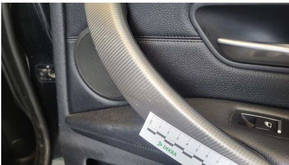
Fot. 84. Uchwyt drzwi tyl P - Rysa/odprysk 1
