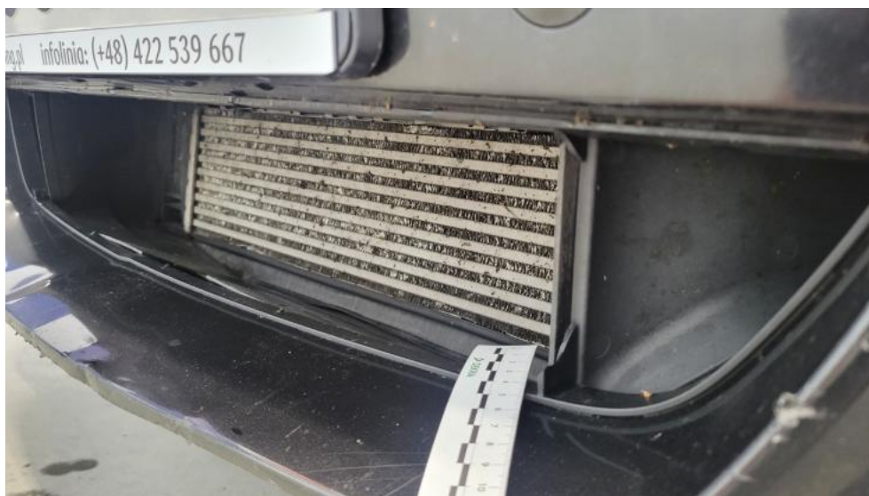
Fot. 41. Kratka zderzaka prz. - Pęknięcie/rozerwanie 1
