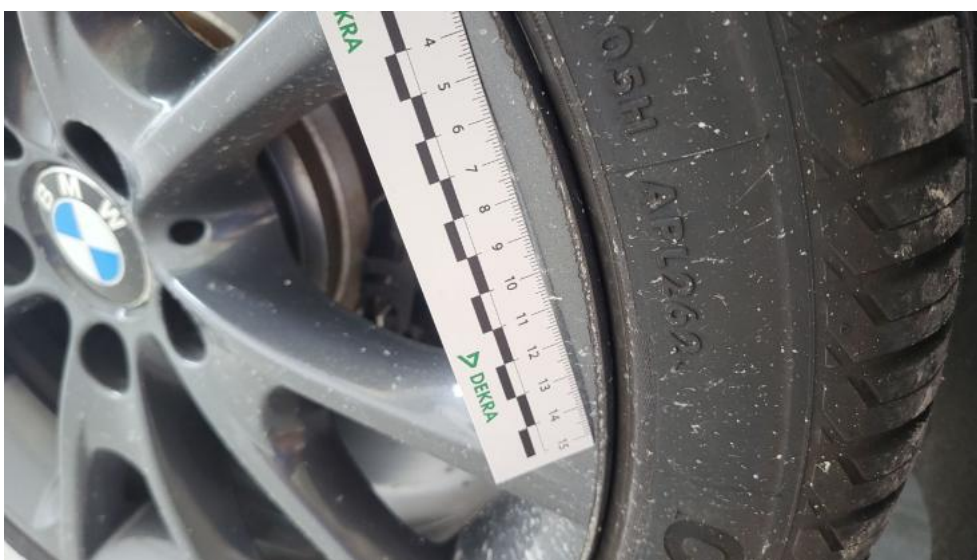
Fot. 60. Felga aluminiowa tylna P - Rysa/odprysk 1
