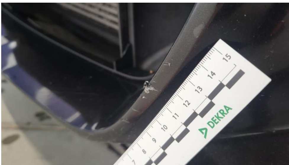
Fot. 45. Zderzak - Rysa/odprysk 2
