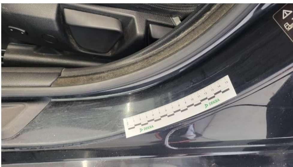
Fot. 74. Próg L - Rysa/odprysk 1
