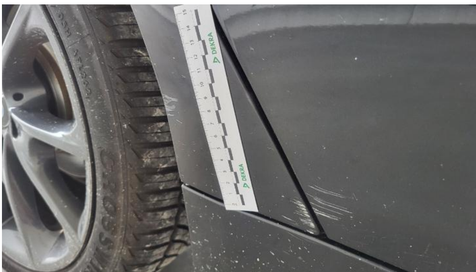
Fot. 57. Błotnik tylny P / Ściana boczna P - Rysa/odprysk 1
