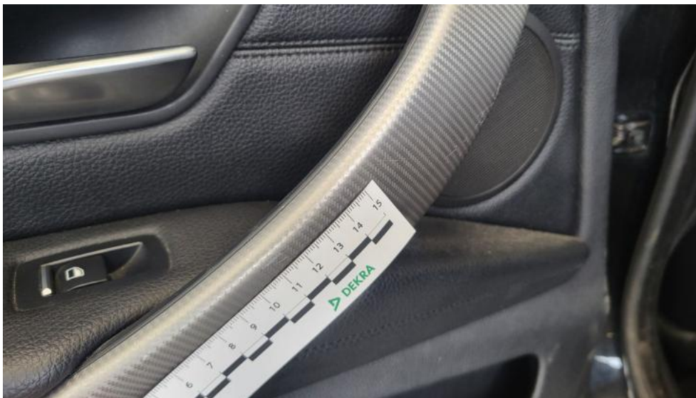
Fot. 83. Uchwyt drzwi tyl L - Rysa/odprysk 1
