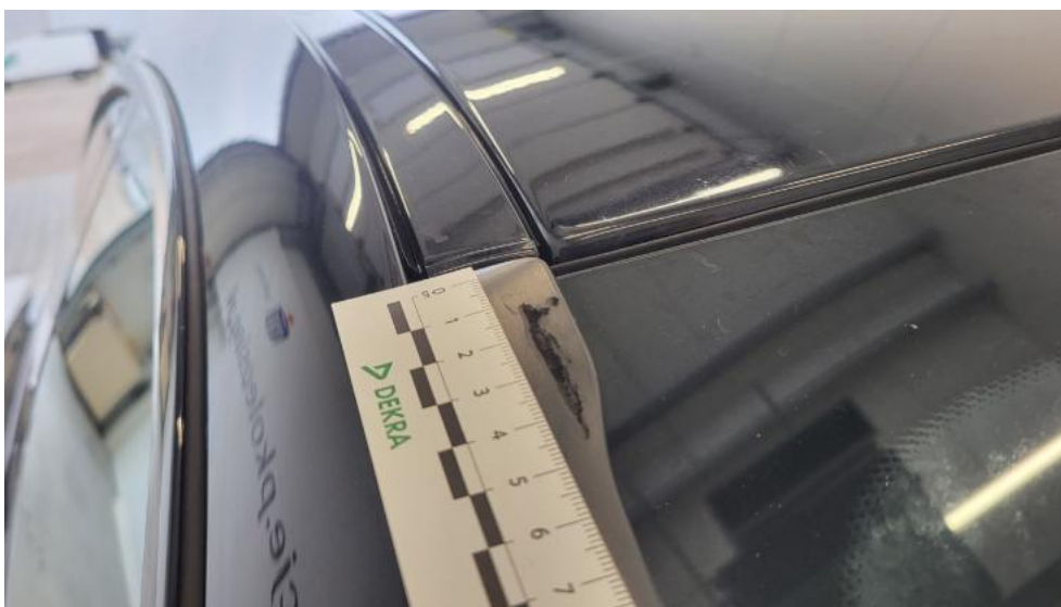
Fot. 43. Uszczelka/listwa szyby czołowej - Rysa/odprysk 1
