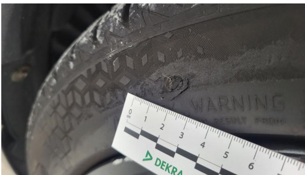
Fot. 78. Opona przednia L - Pęknięcie/rozerwanie 1
