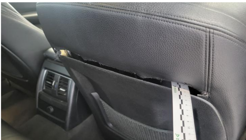
Fot. 80. Fotel prz. praw. - Pęknięcie/rozerwanie 1
