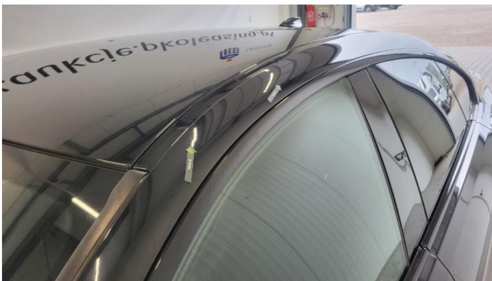
Fot. 75. Słupek przedni L - Wgniecenie/odkształcenie 1
