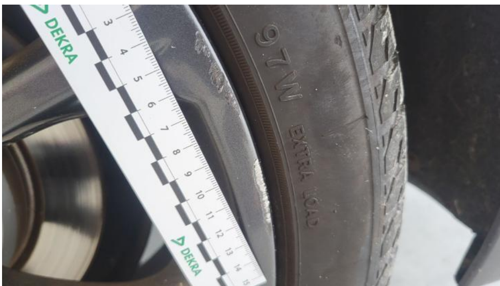
Fot. 67. Felga aluminiowa tylna L - Rysa/odprysk 1
