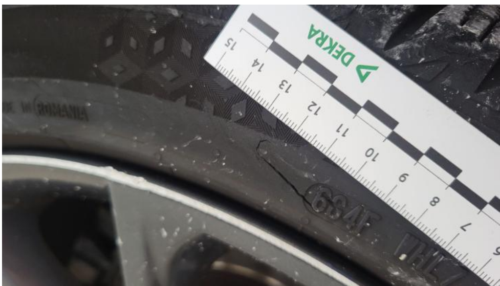
Fot. 51. Opona przednia P - Pęknięcie/rozerwanie 1
