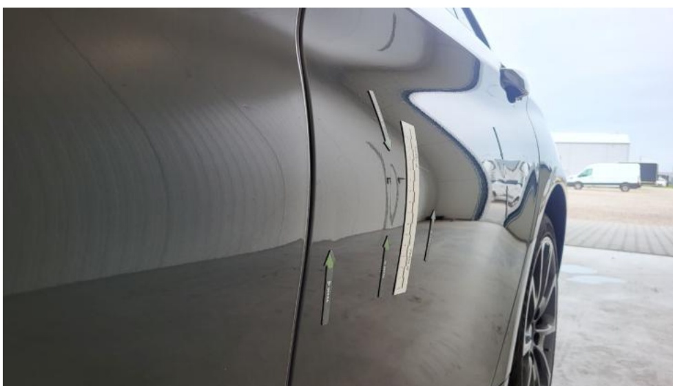
Fot. 72. Drzwi tylne L - Wgniecenie/odkształcenie 1
