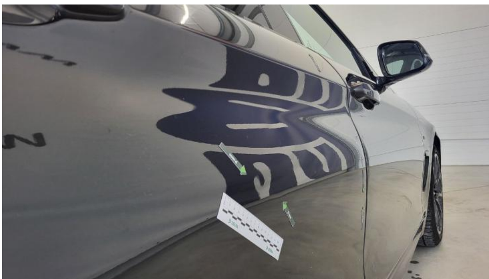
Fot. 56. Drzwi tylne P - Wgniecenie/odkształcenie 1
