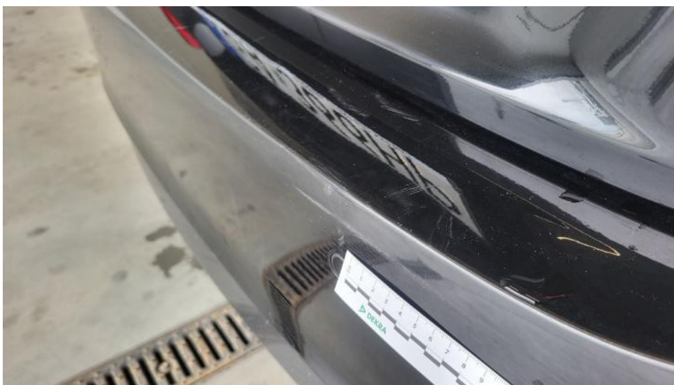
Fot. 61. Zderzak tylny - Rysa/odprysk 1
