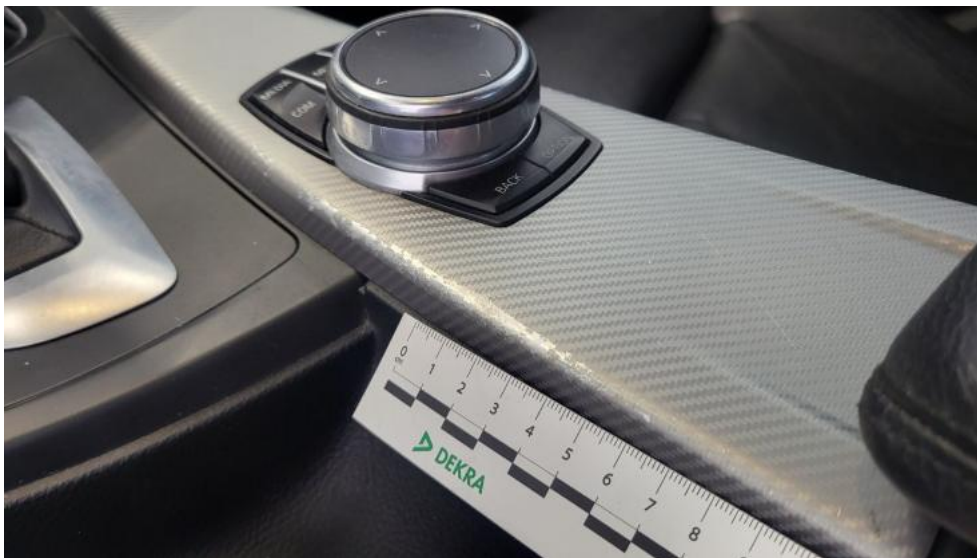
Fot. 79. Konsola tunelu śr. - Rysa/odprysk 1
