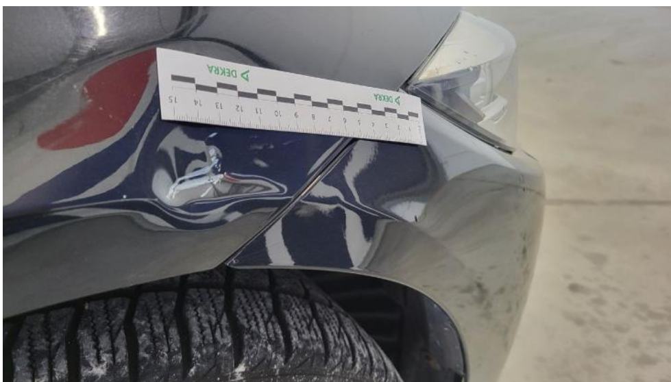
Fot. 48. Zderzak() - Wgniecenie/odkształcenie 3
