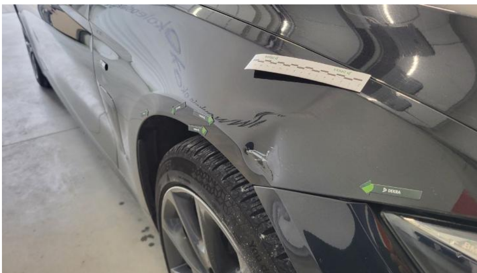
Fot. 49. Błotnik przedni P - Wgniecenie/odkształcenie 1
