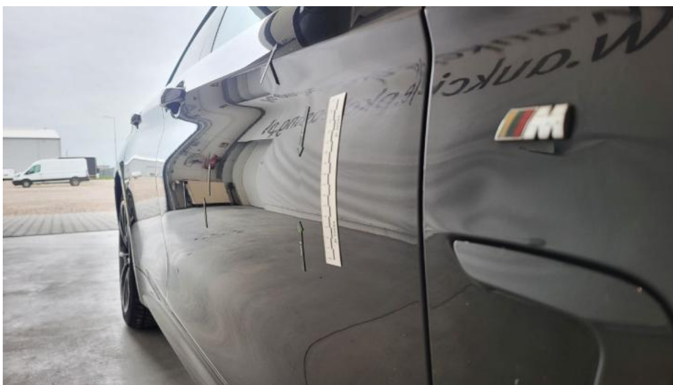
Fot. 53. Drzwi przednie P - Wgniecenie/odkształcenie 1
