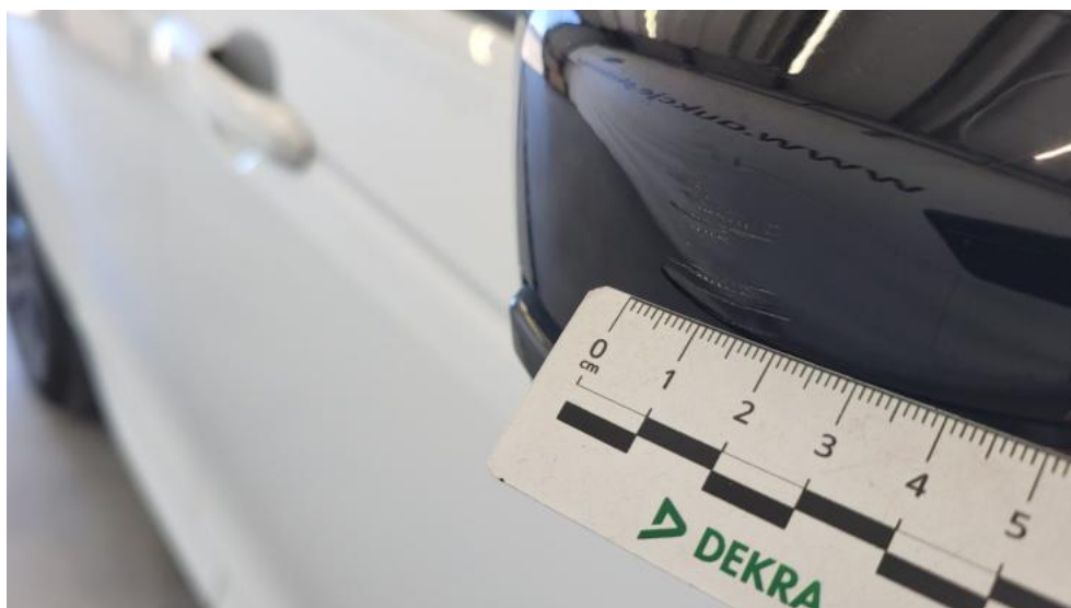
Fot. 44. Lusterko zew P - Rysa/odprysk 1
