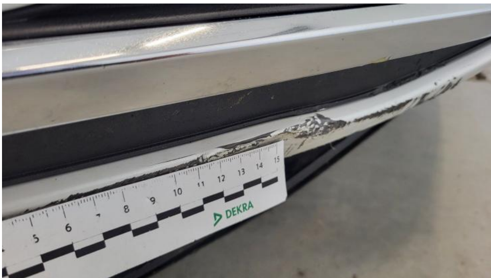
Fot. 53. Zderzak - Pęknięcie/rozerwanie 1
