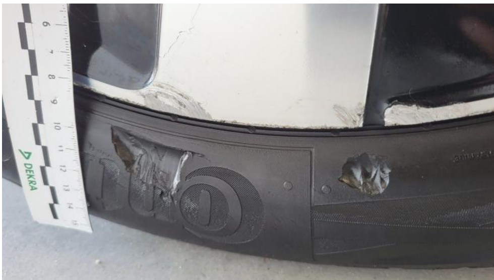
Fot. 60. Opona tylna P - Pęknięcie/rozerwanie 1
