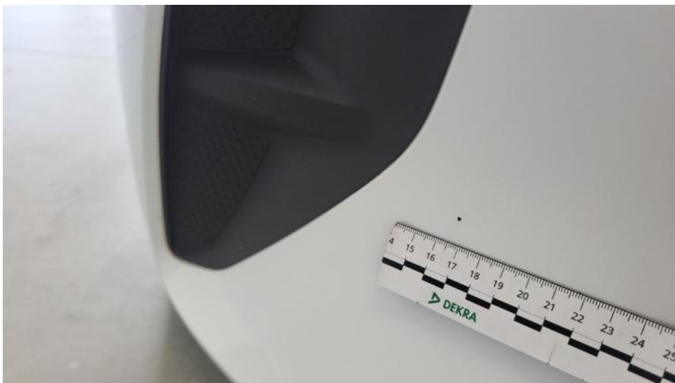
Fot. 40. Zderzak - Rysa/odprysk 1
