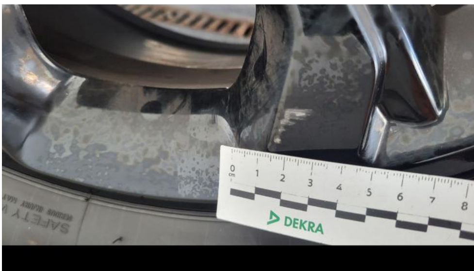
Fot. 58. Felga Aluminiowa przednia L - Rysa/odprysk 1
