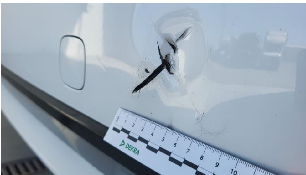
Fot. 69. Zderzak tylny - Pęknięcie/rozerwanie 1
