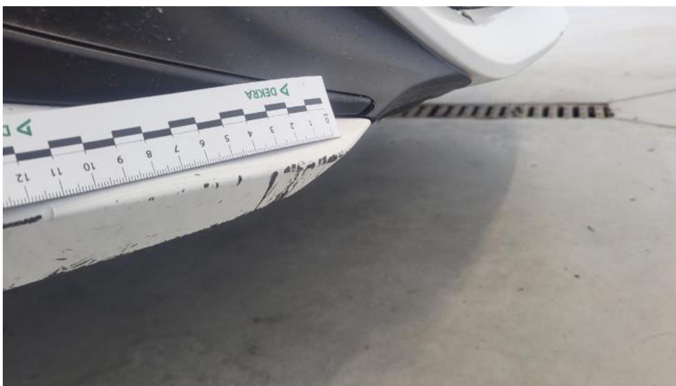
Fot. 48. Zderzak - Wgniecenie/odkształcenie 1
