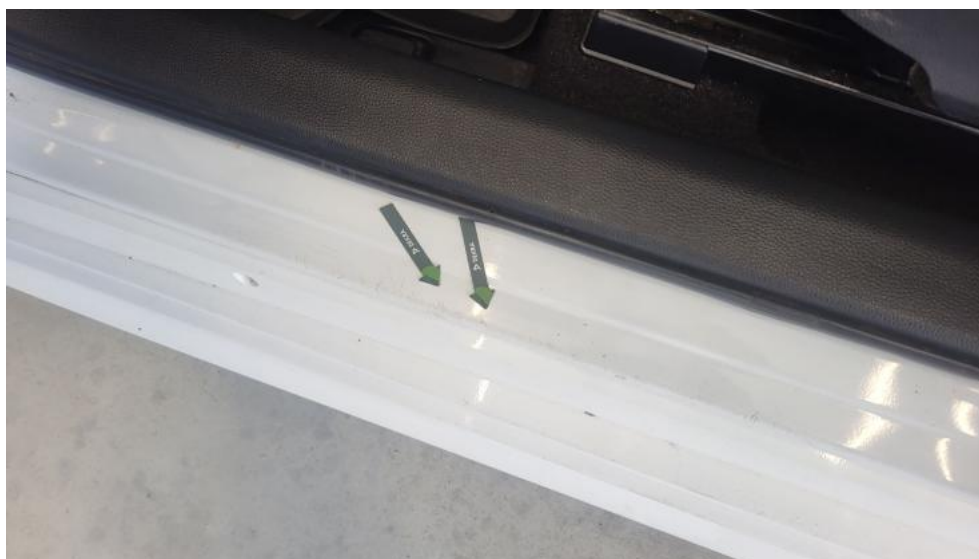
Fot. 89. Próg L - Wgniecenie/odkształcenie 1
