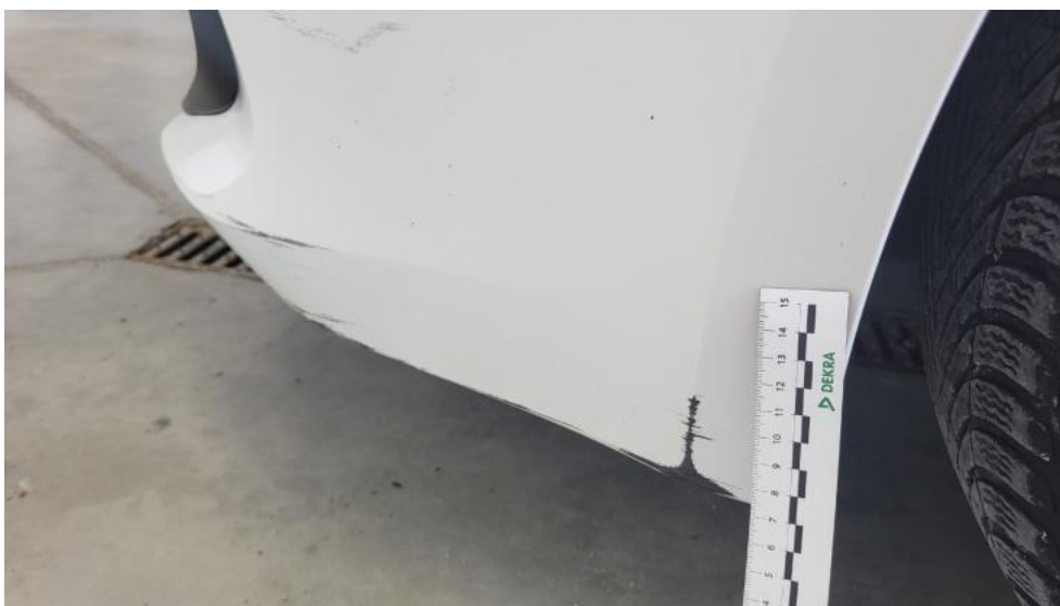
Fot. 47. Zderzak - Rysa/odprysk 1
