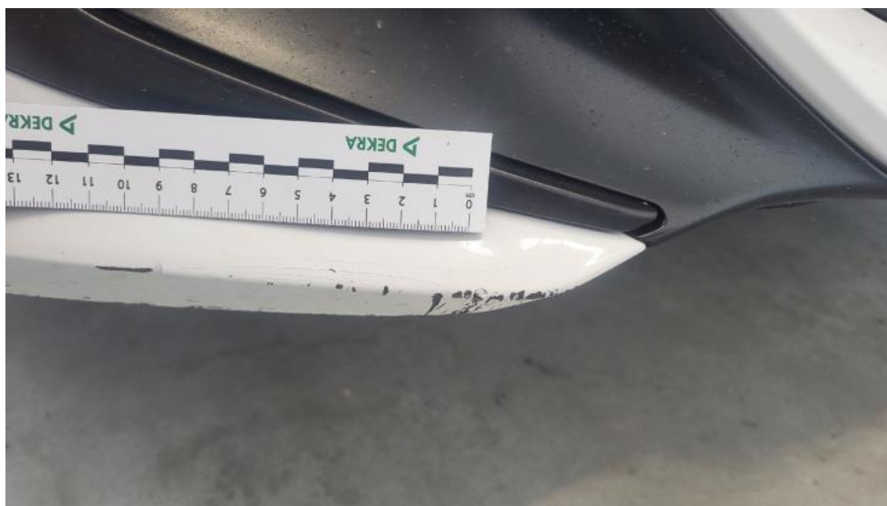
Fot. 49. Zderzak - Pęknięcie/rozerwanie 1
