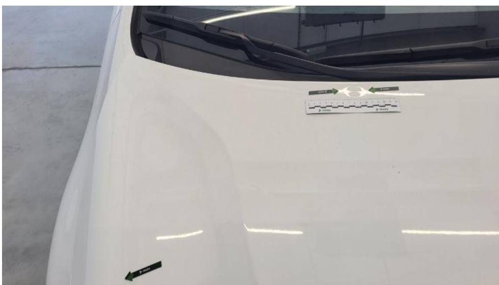
Fot. 44. Pokrywa komory silnika - Wgniecenie/odkształcenie 2
