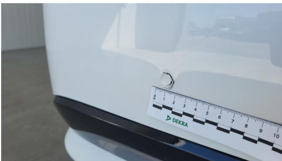
Fot. 70. Zderzak tylny - Pęknięcie/rozerwanie 2
