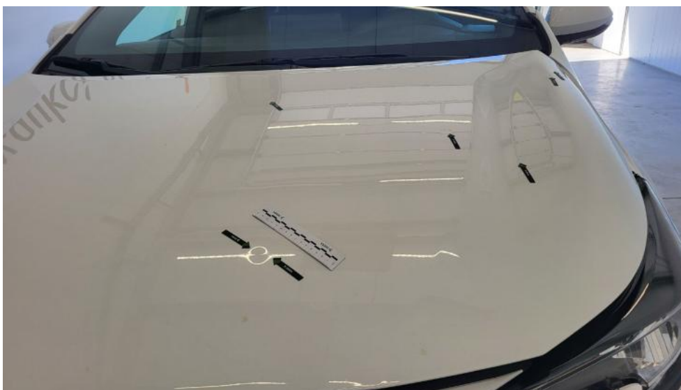
Fot. 43. Pokrywa komory silnika - Wgniecenie/odkształcenie 1
