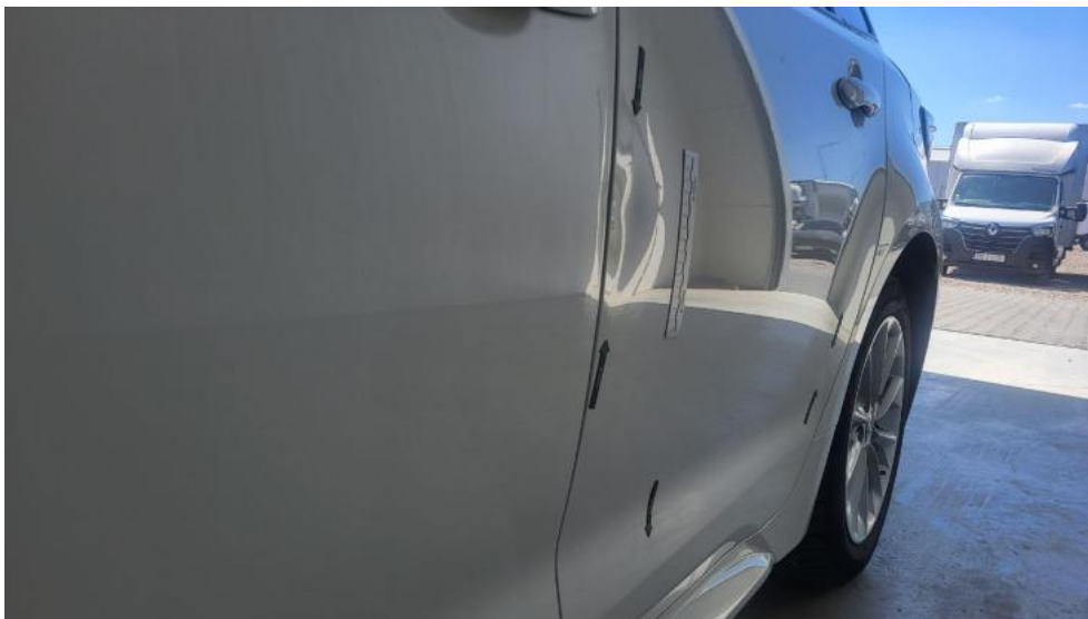
Fot. 87. Drzwi tylne L - Wgniecenie/odkształcenie 1
