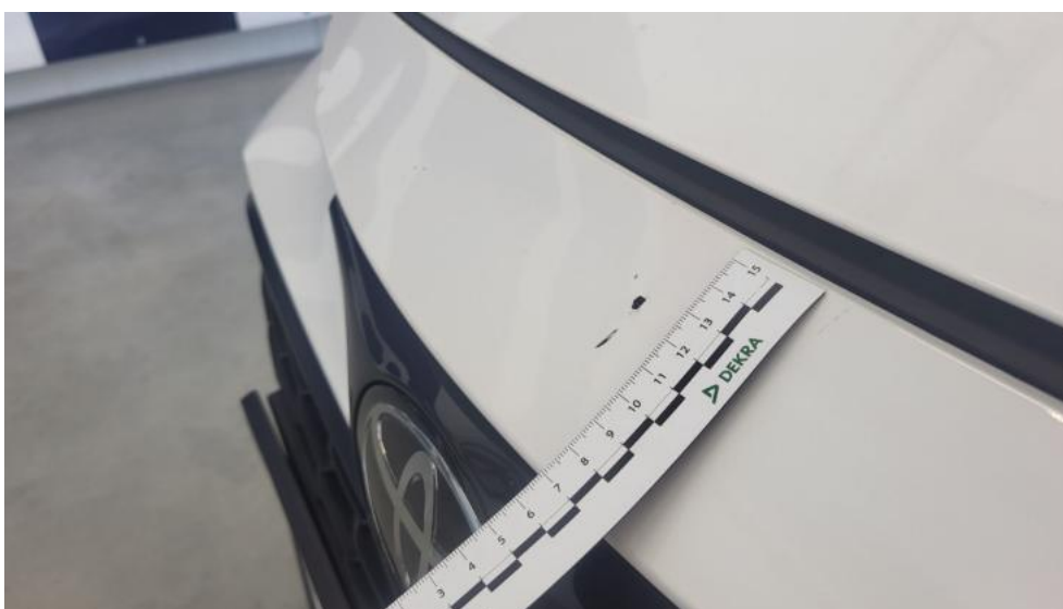
Fot. 52. Zderzak przedni cz górna - Wgniecenie/odkształcenie 1
