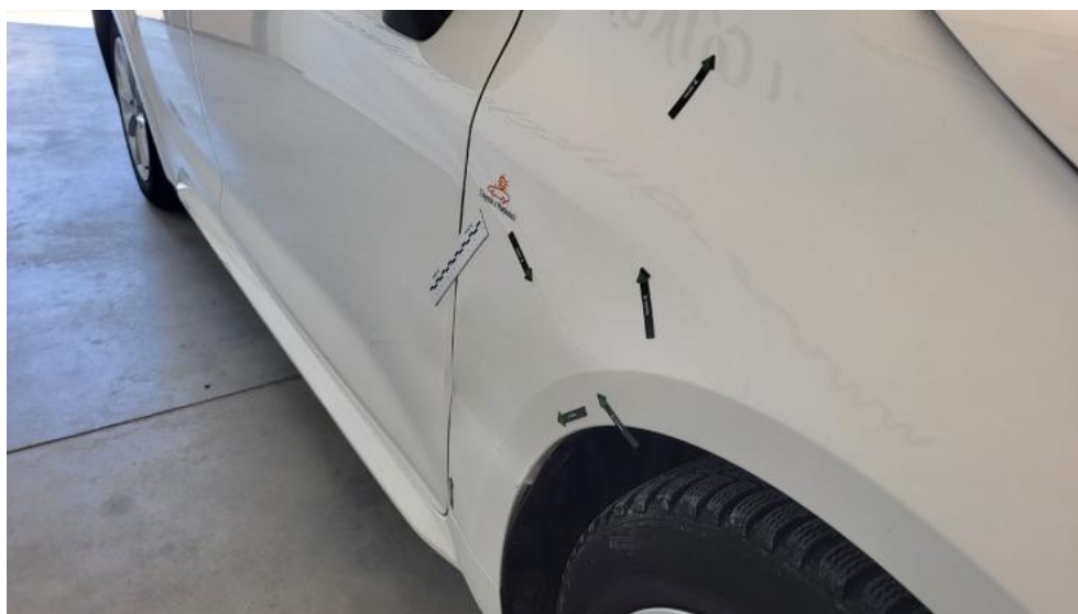
Fot. 54. Błotnik przedni P - Wgniecenie/odkształcenie 2
