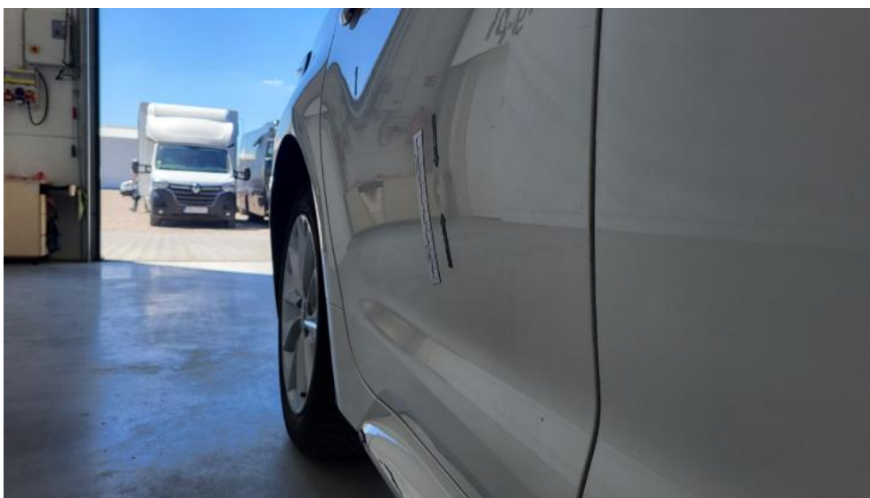
Fot. 59. Drzwi tylne P - Wgniecenie/odkształcenie 1
