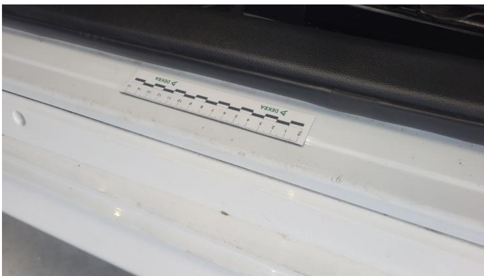
Fot. 88. Próg L - Rysa/odprysk 1
