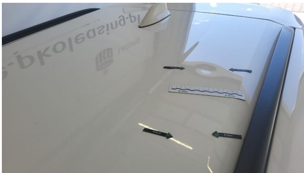
Fot. 75. Dach - Wgniecenie/odkształcenie 1
