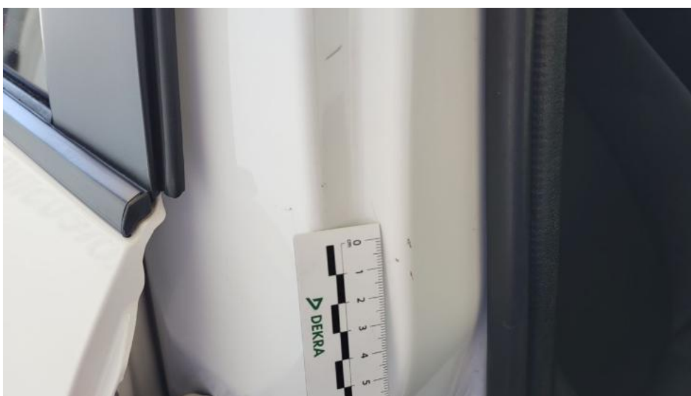
Fot. 62. Słupek środkowy P - Rysa/odprysk 1
