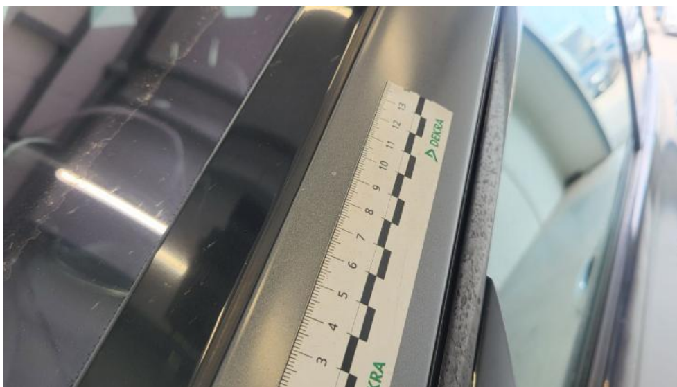
Photo 67. Stupek przedni L - Rysa/odprysk 1
