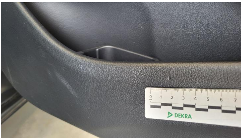
Photo 79. Tapicerka drzwi przednich P - Wgniecenie/odkształcenie 1
