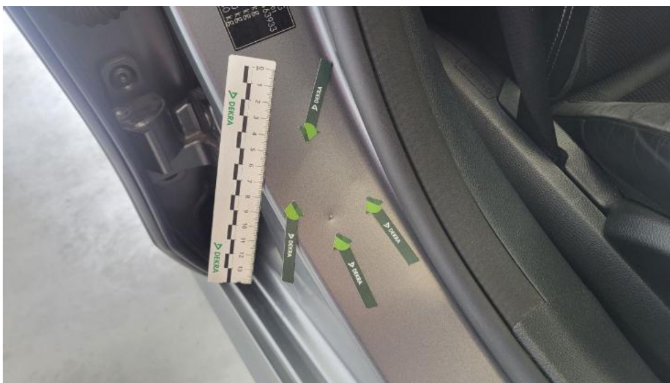
Photo 47. Stupek środkowy P - Wgniecenie/odkształcenie 1
