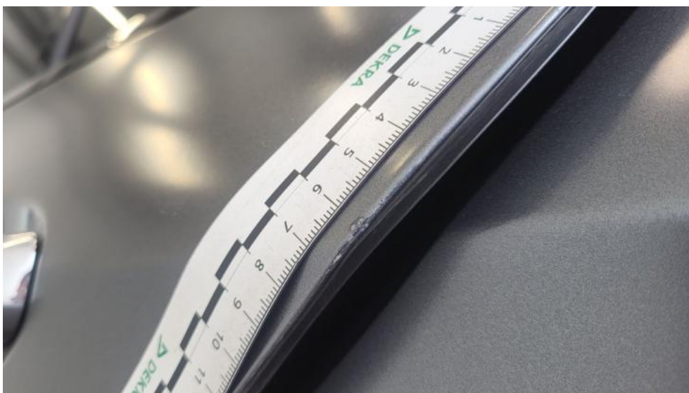
Photo 64. Drzwi tylne L - Rysa/odprysk 1
