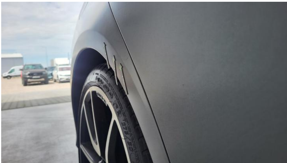
Photo 51. Błotnik tylny P / Ściana boczna P - Wgniecenie/odkształcenie 2
