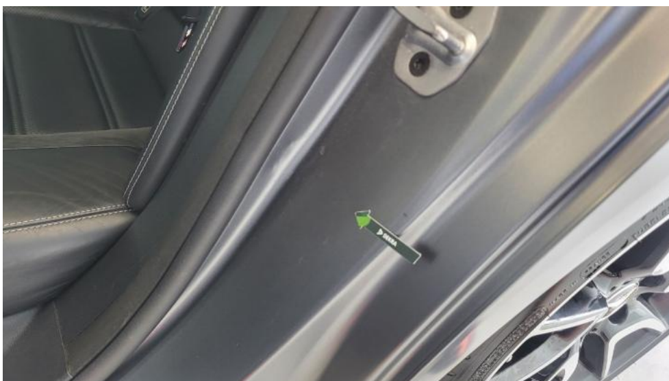
Photo 60. Błotnik tylny L / Ściana boczna L - Wgniecenie/odkształcenie 2
