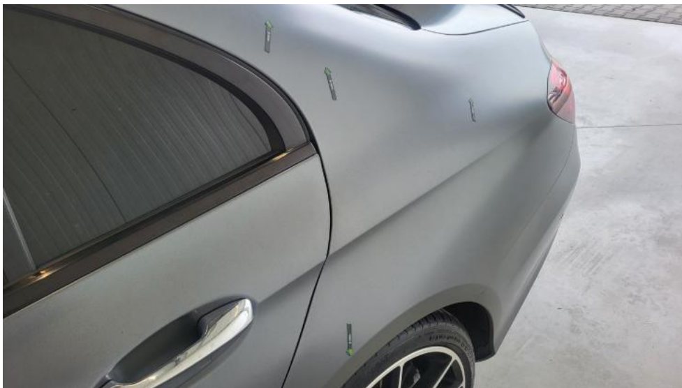
Photo 59. Błotnik tylny L / Ściana boczna L - Wgniecenie/odkształcenie 1
