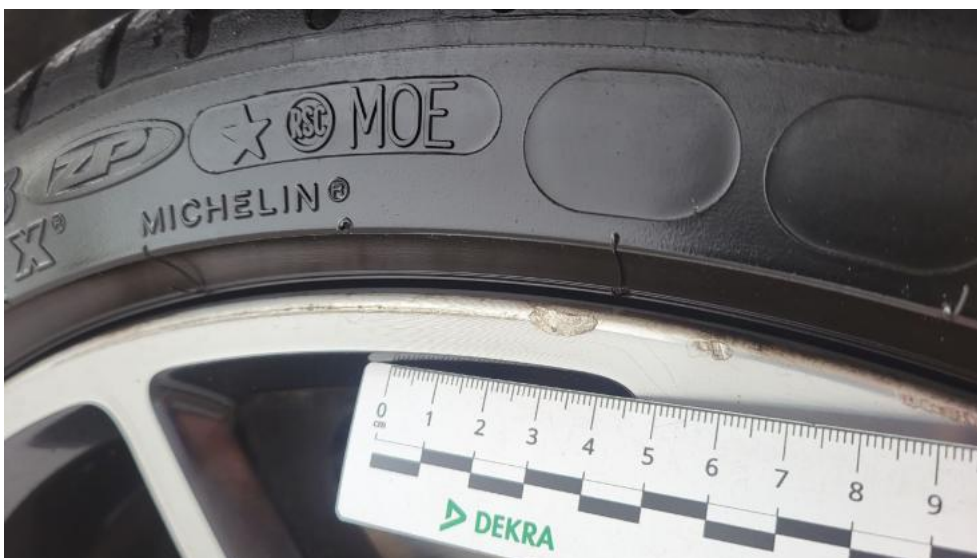
Photo 52. Felga aluminiowa tylna P - Rysa/odprysk 1
