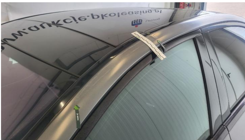
Photo 68. Stupek przedni L - Wgniecenie/odkształcenie 1
