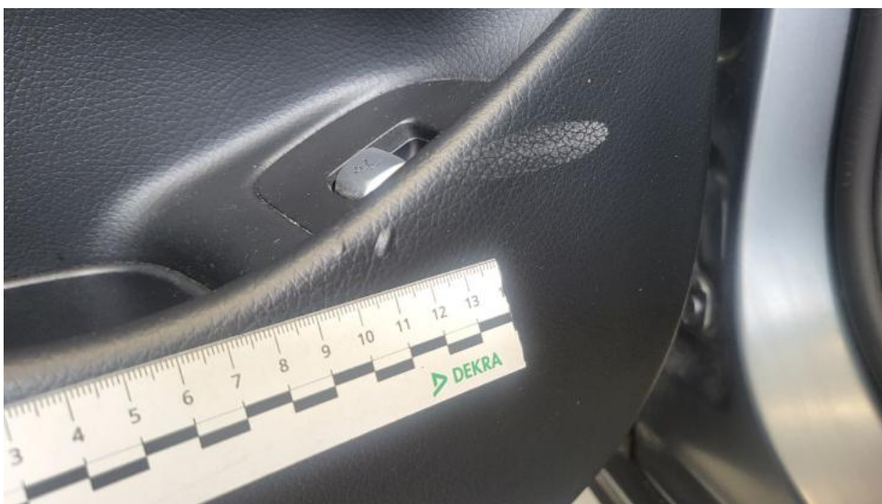
Photo 78. Tapicerka drzwi przednich L - Wgniecenie/odkształcenie 1
