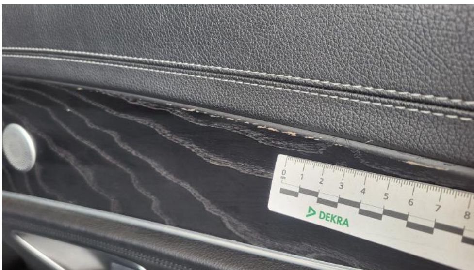
Photo 80. Tapicerka drzwi tylnych P - Rysa/odprysk 1
