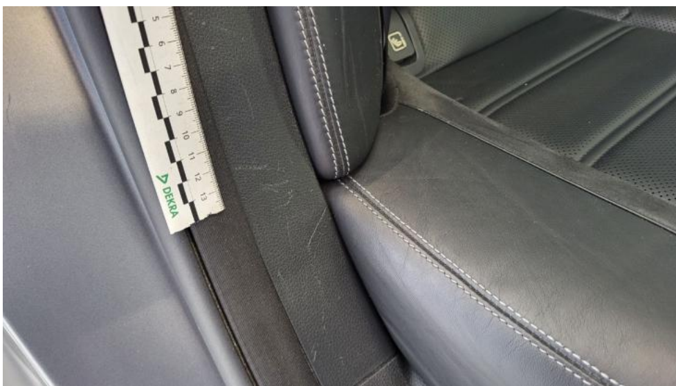
Photo 82. Wykładzina(y) słupka tylnego P - Rysa/odprysk 1
