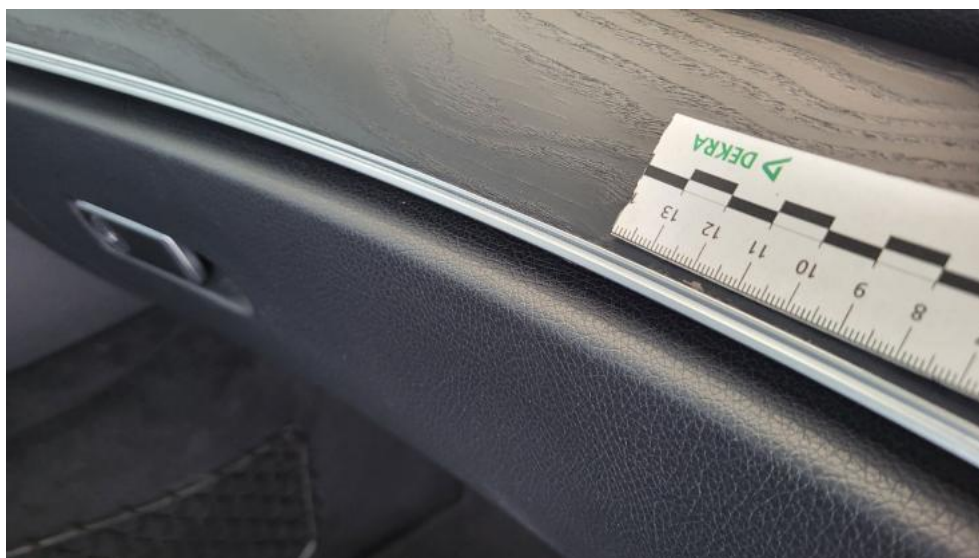
Photo 72. Deska rozdzielcza - Rysa/odprysk 1
