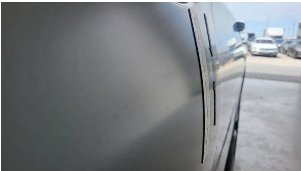
Photo 63. Drzwi przed L - Wgniecenie/odkształcenie 1
