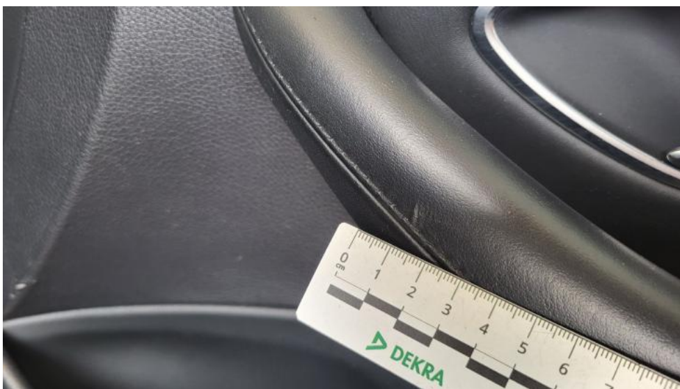
Photo 81. Uchwyt drzwi prze P - Rysa/odprysk 1
