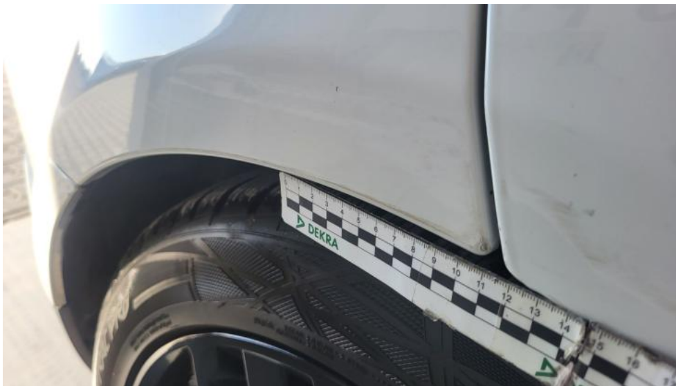
Fot. 55. Błotnik tylny P / Ściana boczna P - Rysa/odprysk 1
