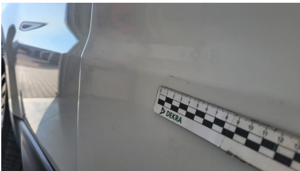
Fot. 45. Drzwi przednie P - Rysa/odprysk 1
