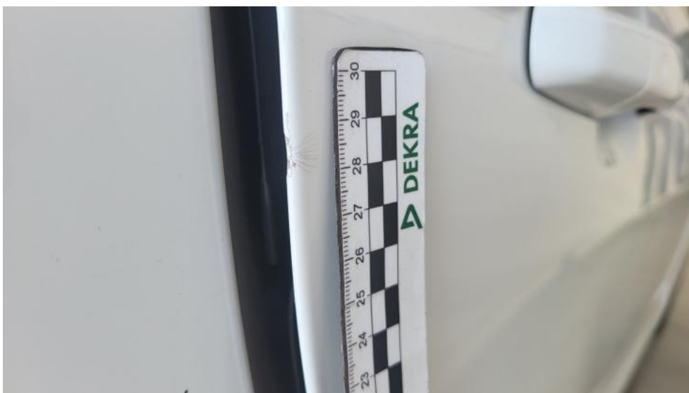
Fot. 52. Drzwi tylne P - Pęknięcie/rozerwanie 2
