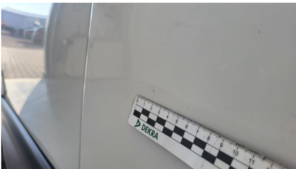
Fot. 48. Drzwi przednie P - Wgniecenie/odkształcenie 1
