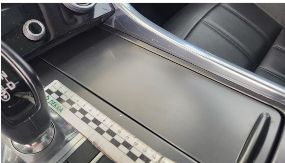
Fot. 67. Konsola tunelu śr. - Rysa/odprysk 1
