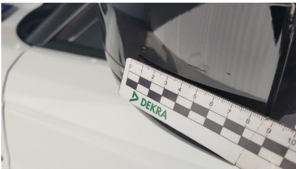
Fot. 64. Lusterko zew L - Rysa/odprysk 1
