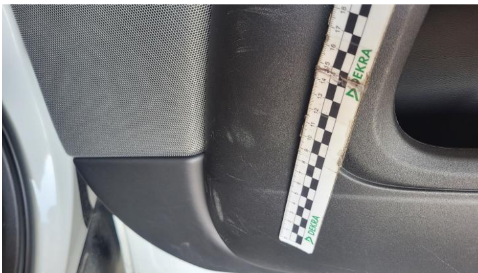
Fot. 70. Tapicerka drzwi tylnych P - Rysa/odprysk 1
