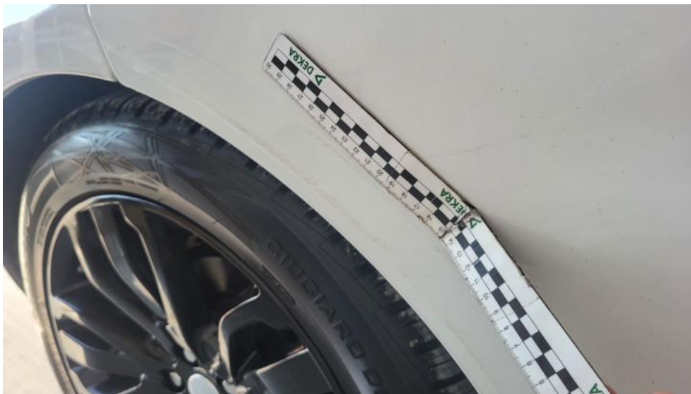
Fot. 49. Drzwi tylne P - Rysa/odprysk 1
