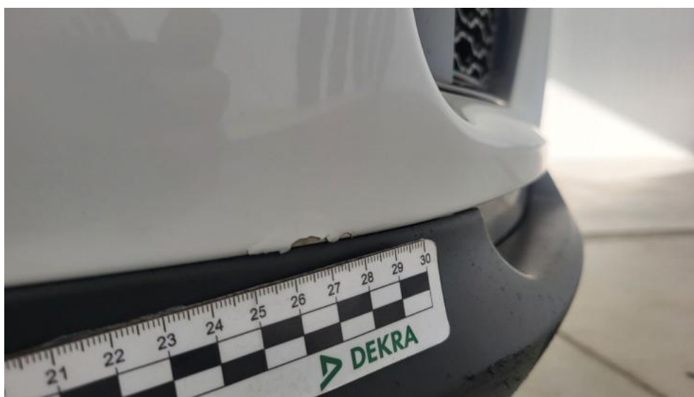
Fot. 40. Zderzak - Rysa/odprysk 1
