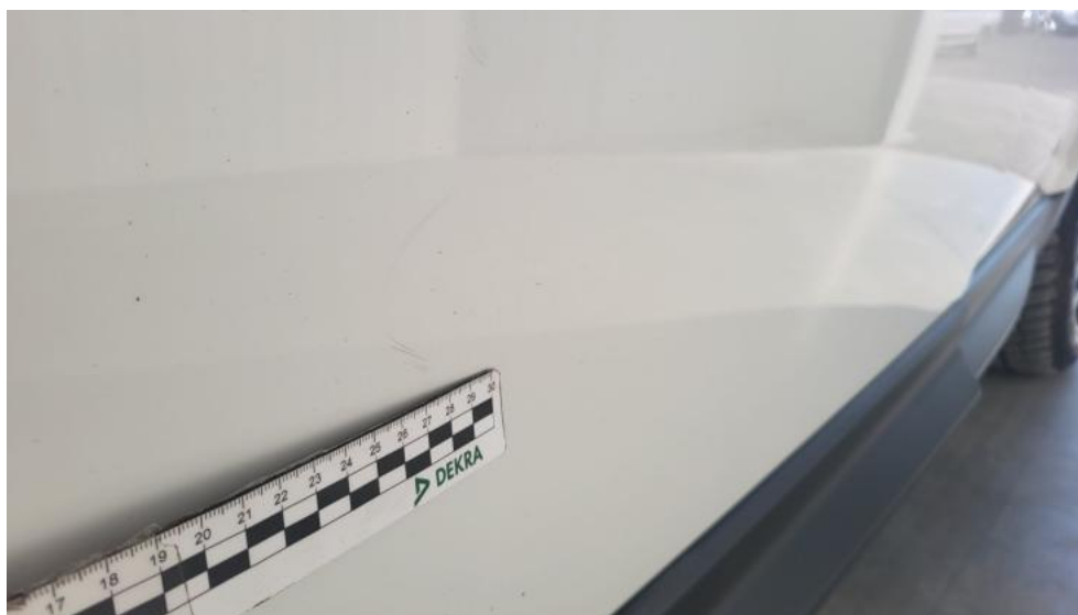
Fot. 59. Drzwi przed L - Rysa/odprysk 2
