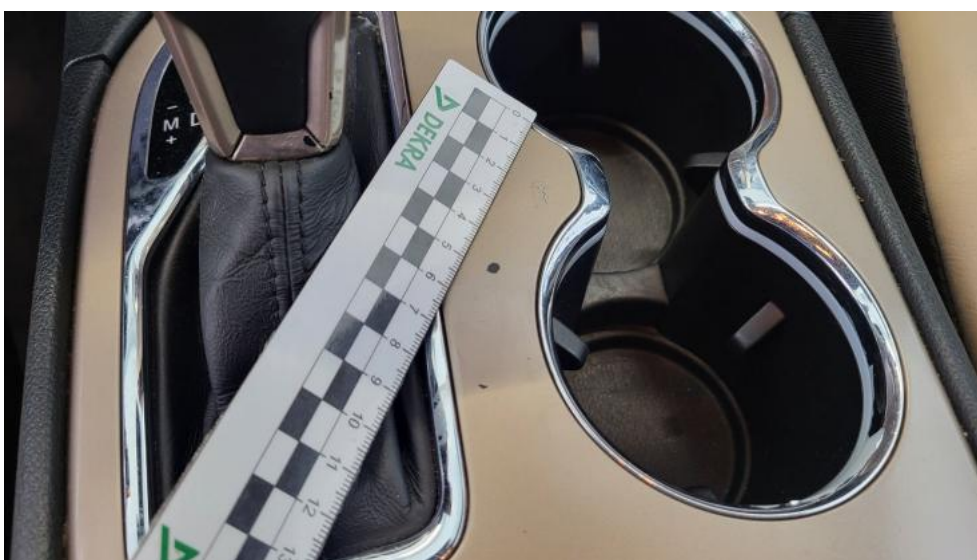
Fot. 62. Konsola tunelu śr. - Rysa/odprysk 1
