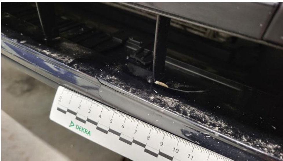
Photo 43. Kratka zderzaka prz. - Pęknięcie/rozerwanie 1
