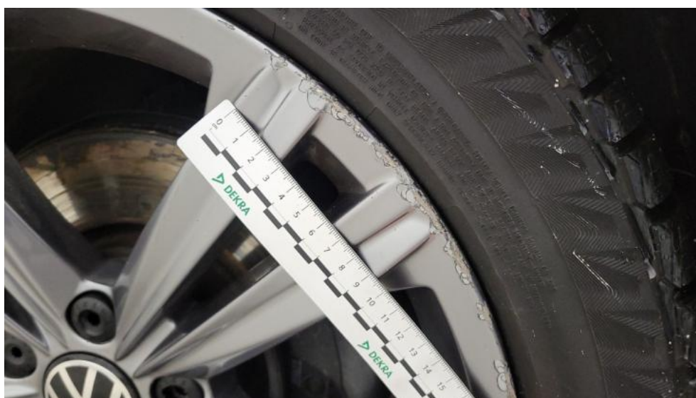
Photo 48. Felga aluminiowa przednia P - Rysa/odprysk 1
