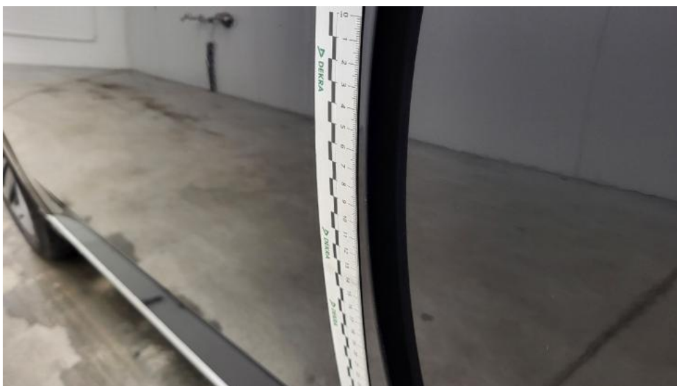
Photo 66. Drzwi przed L - Rysa/odprysk 1
