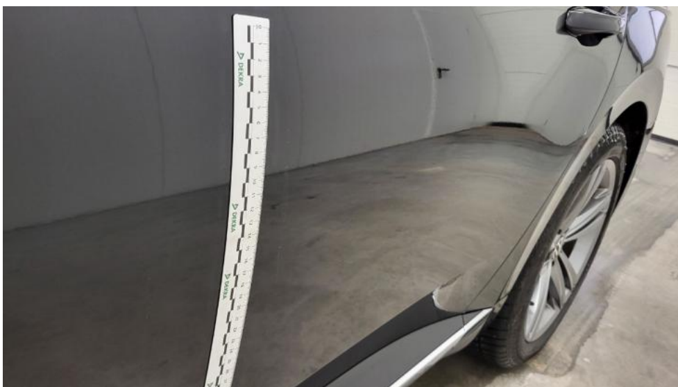
Photo 68. Drzwi tylne L - Rysa/odprysk 1
