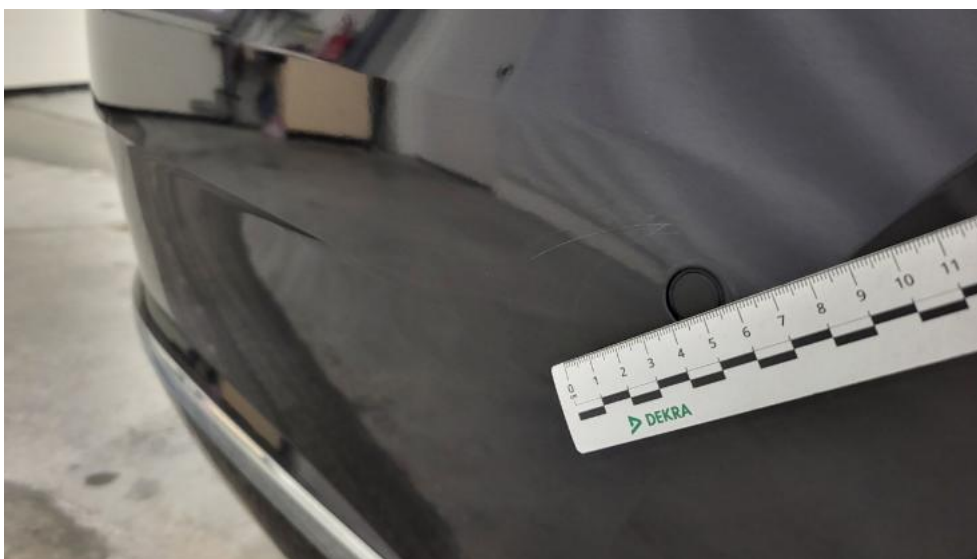
Photo 57. Zderzak tylny - Rysa/odprysk 1
