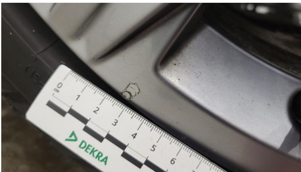
Photo 72. Felga Aluminiowa przednia L - Rysa/odprysk 1
