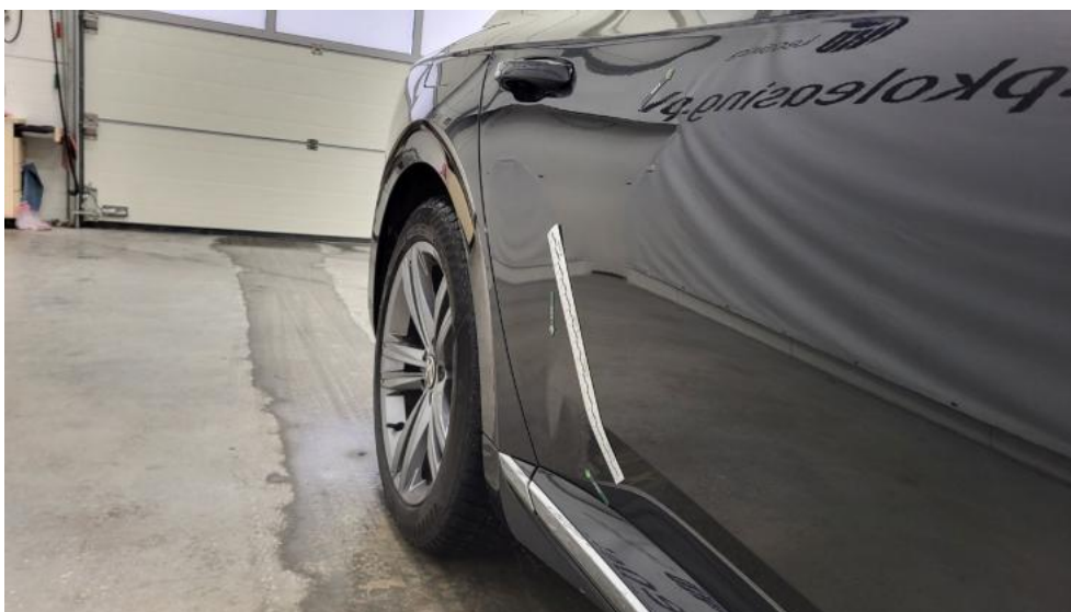
Photo 51. Drzwi tylne P - Wgniecenie/odkształcenie 1
