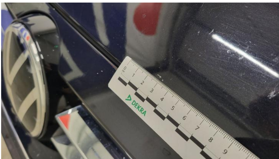
Photo 44. Pokrywa komory silnika - Rysa/odprysk 1
