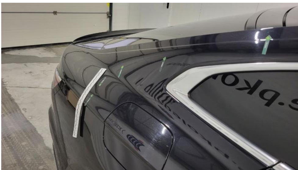
Photo 55. Błotnik tylny P / Ściana boczna P - Wgniecenie/odkształcenie 1
