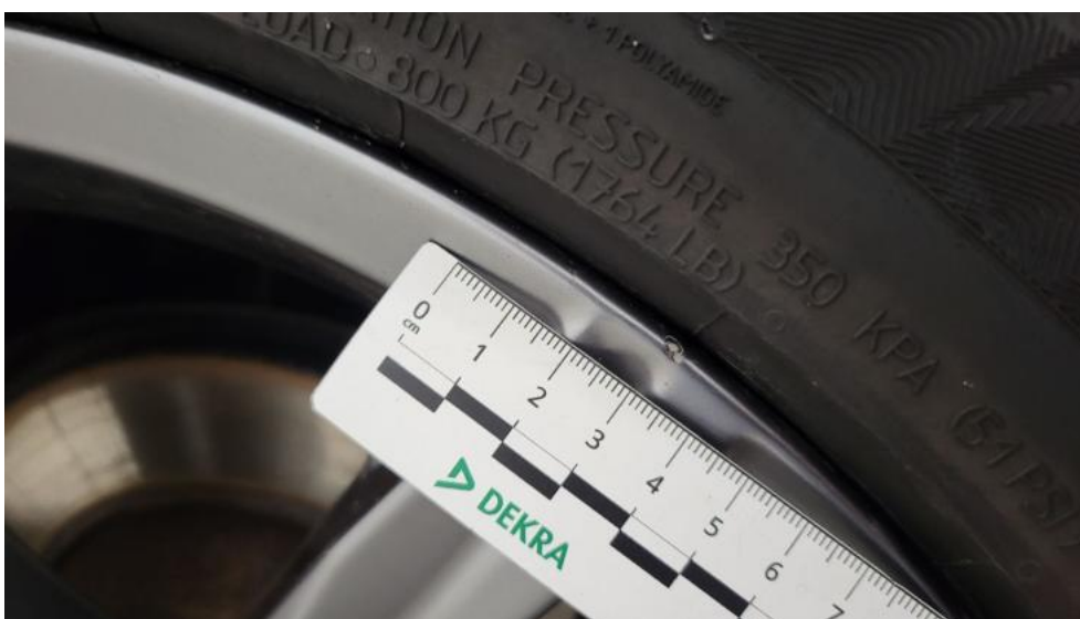
Photo 56. Felga aluminiowa tylna P - Rysa/odprysk 1
