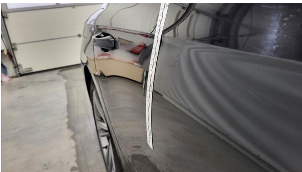
Photo 52. Drzwi tylne P - Wgniecenie/odkształcenie 2
