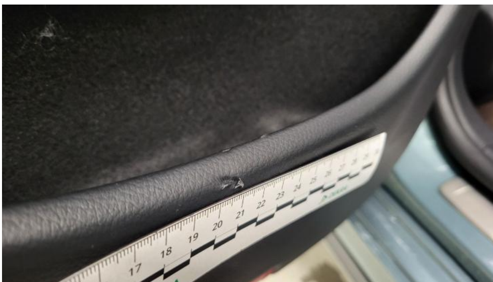
Photo 52. Tapicerka drzwi tylnych L - Pęknięcie/rozerwanie 1
