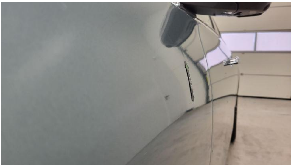
Photo 51. Błotnik przedni L - Wgniecenie/odkształcenie 1
