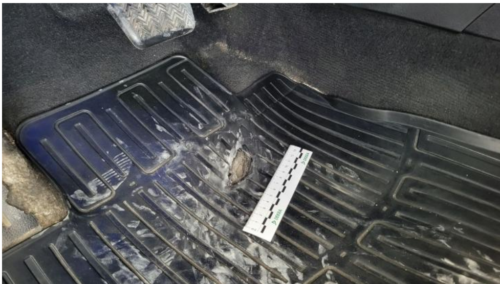
Photo 91. Dywanik prze L - Pęknięcie/rozerwanie 1
