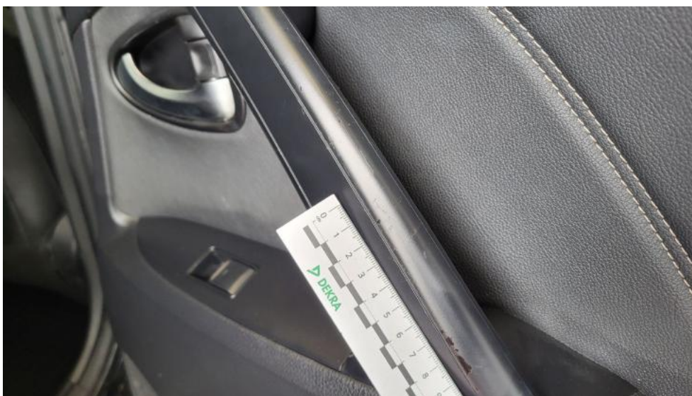
Photo 87. Uchwyt drzwi tyl P - Rysa/odprysk 1
