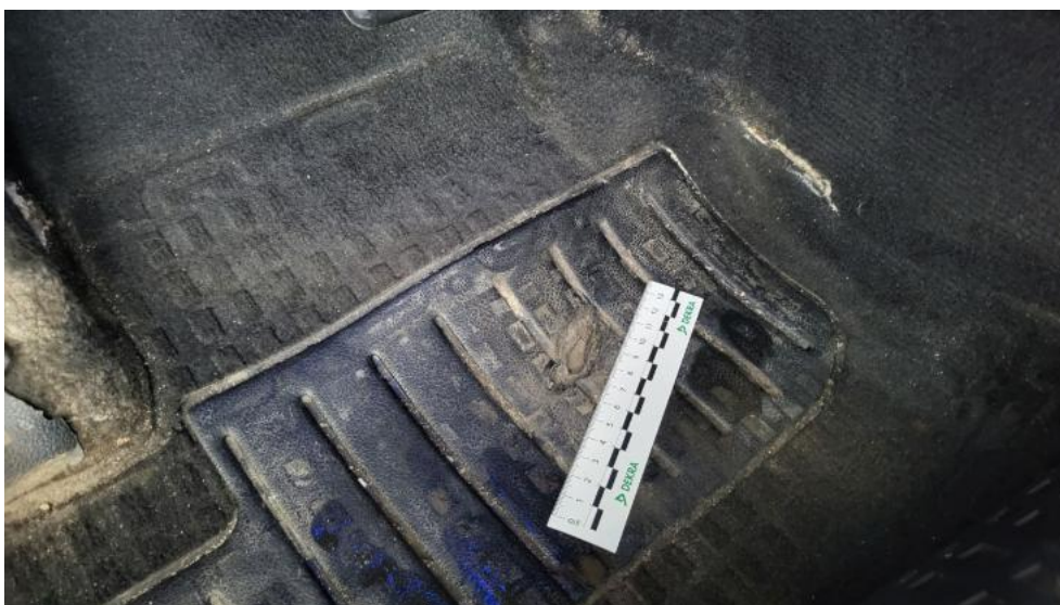
Photo 92. Wykładzina podłogi - Pęknięcie/rozerwanie 1
