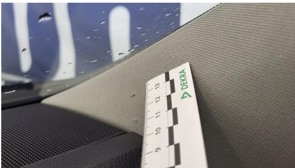
Photo 90. Wykładzina(y) słupka przedniego P - Rysa/odprysk 1
