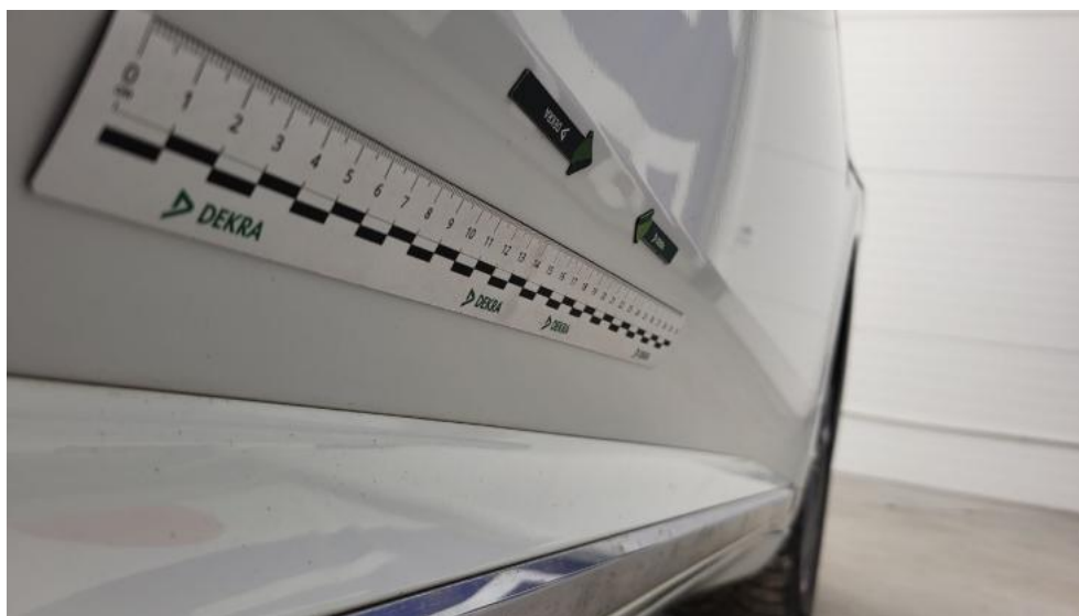
Fot. 49. Drzwi przednie P - Wgniecenie/odkształcenie 1
