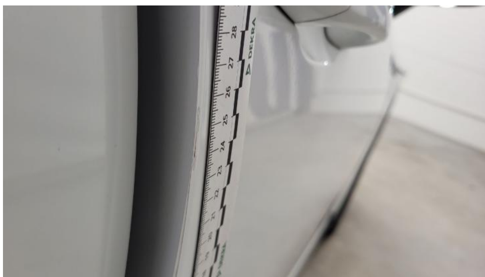
Fot. 48. Drzwi przednie P - Rysa/odprysk 1
