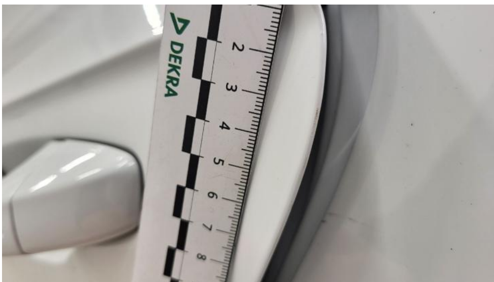
Fot. 61. Drzwi tylne L - Rysa/odprysk 1
