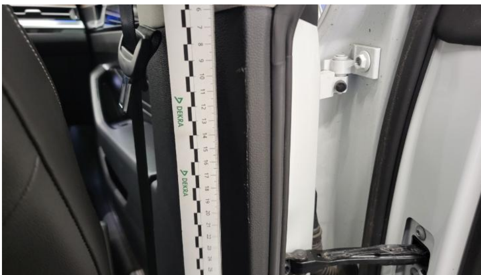
Fot. 68. Wykładzina(y) słupka środkowego P - Rysa/odprysk 1
