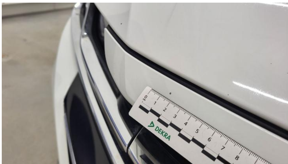
Fot. 47. Zderzak przedni cz górna - Rysa/odprysk 1
