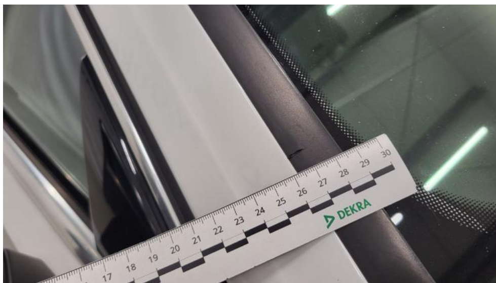
Fot. 45. Uszczelka/listwa szyby czołowej - Rysa/odprysk 1
