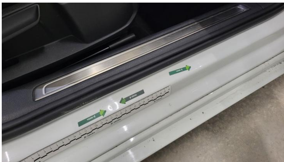
Fot. 51. Próg P - Wgniecenie/odkształcenie 1
