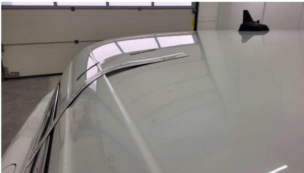
Fot. 57. Dach - Wgniecenie/odkształcenie 1
