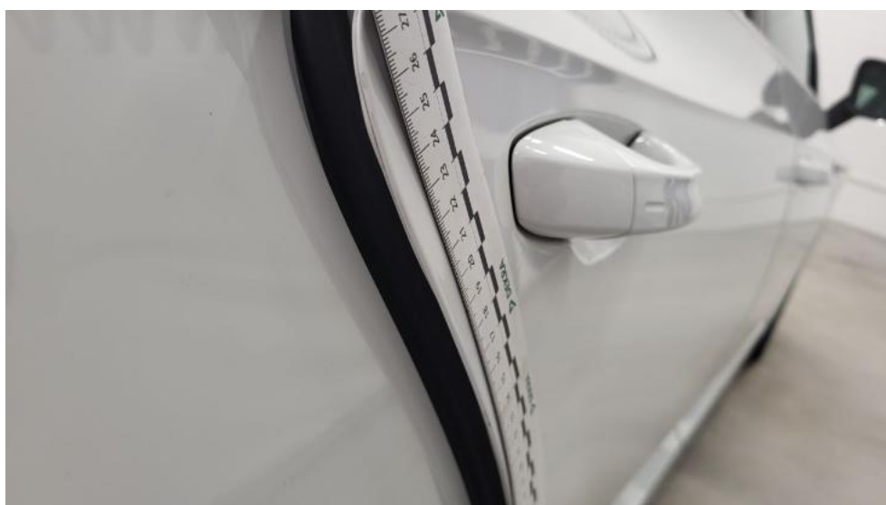
Fot. 50. Drzwi tylne P - Rysa/odprysk 1
