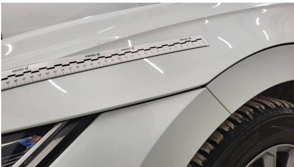
Fot. 42. Pokrywa komory silnika - Rysa/odprysk 1
