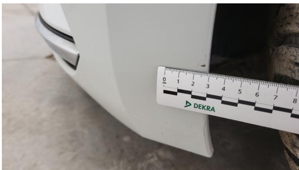
Fot. 46. Zderzak - Rysa/odprysk 1
