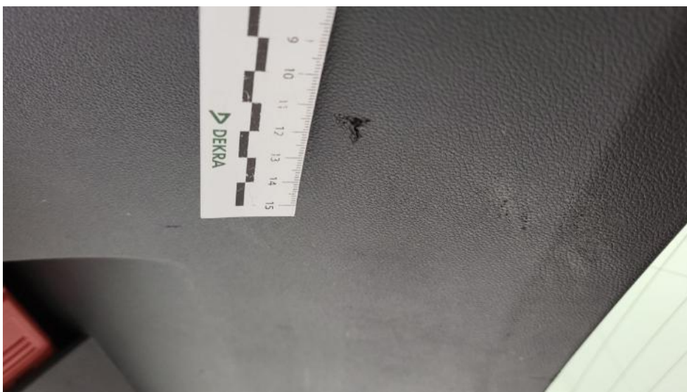
Photo 86. Wykładzina pokrywy tylnej - Rysa/odprysk 1
