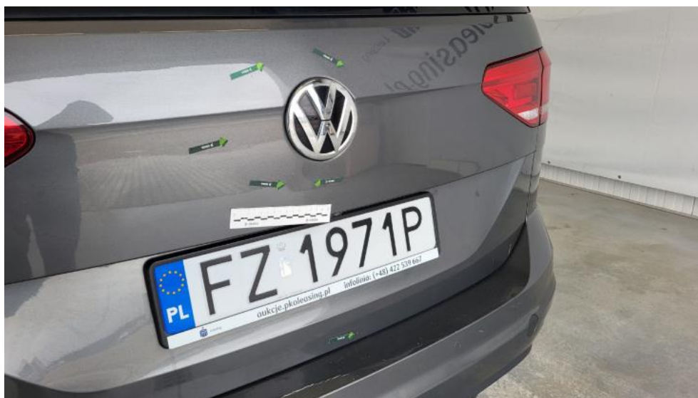
Photo 53. Pokrywy bagażnika - Wgniecenie/odkształcenie 2
