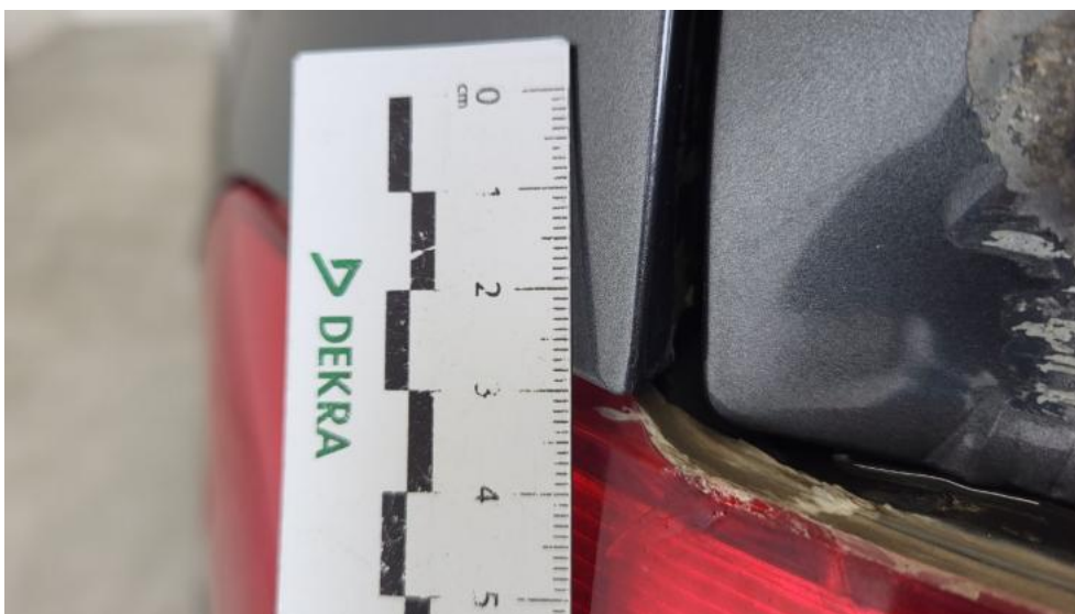
Photo 64. Błotnik tylny L / Ściana boczna L - Rysa/odprysk 1
