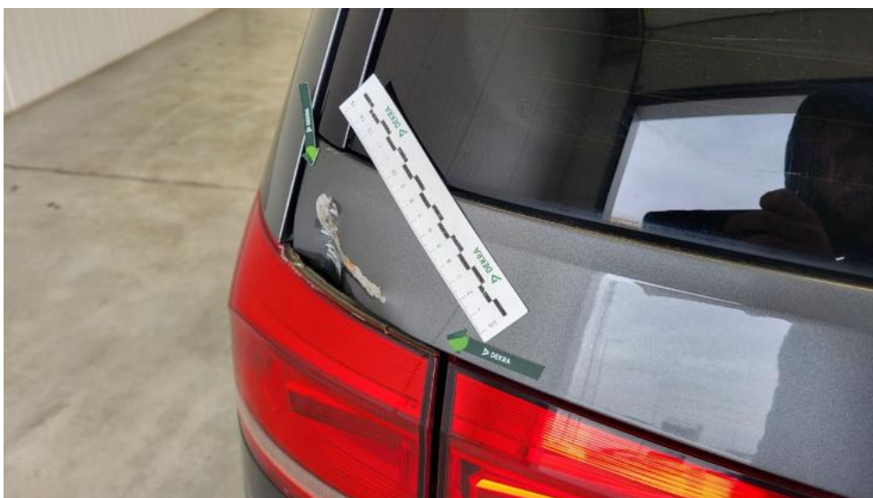
Photo 52. Pokrywy bagażnika - Wgniecenie/odkształcenie 1
