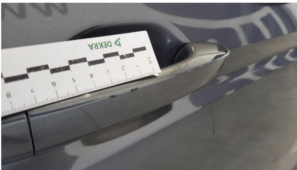
Photo 49. Klamka drzwi prz P - Rysa/odprysk 1
