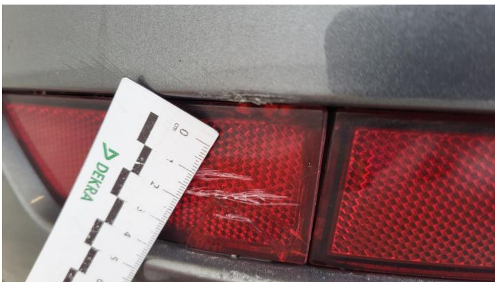
Photo 70. Lampa przeciwmgielna tylna L - Pęknięcie/rozerwanie 1
