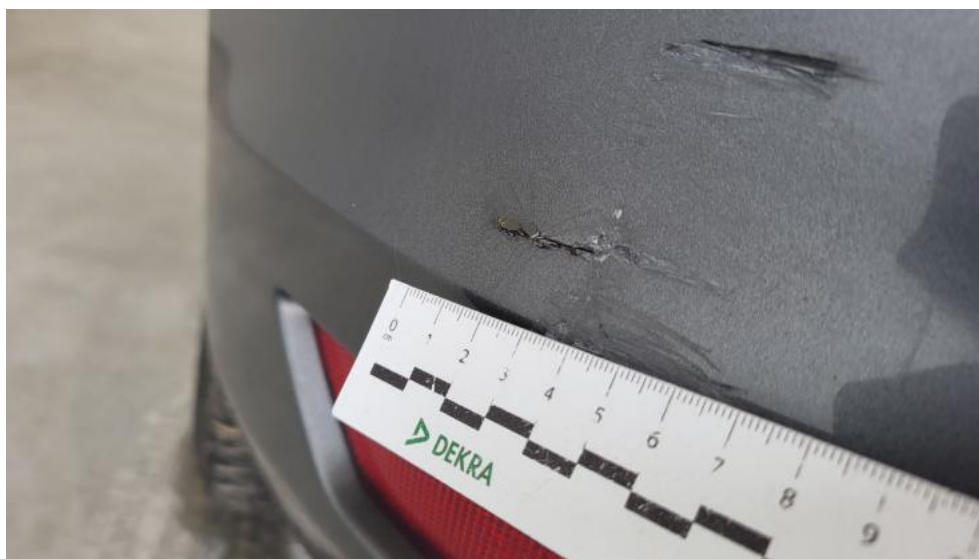
Photo 61. Zderzak tylny - Pęknięcie/rozerwanie 2
