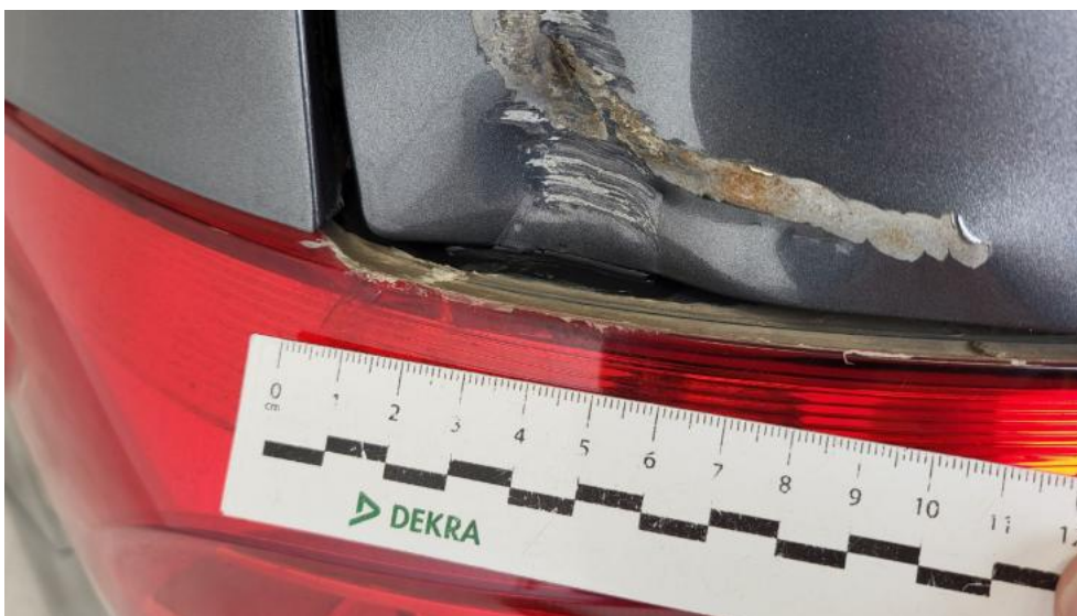
Photo 69. Lampa tylna zew L - Pęknięcie/rozerwanie 2
