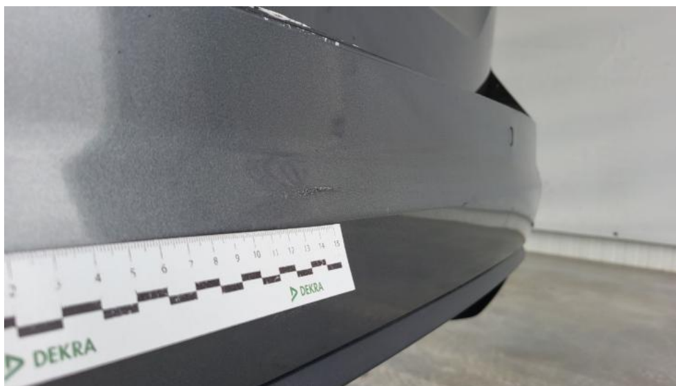
Photo 59. Zderzak tylny() - Wgniecenie/odkształcenie 3
