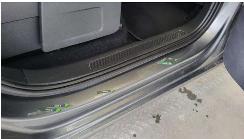
Photo 50. Próg P - Wgniecenie/odkształcenie 1
