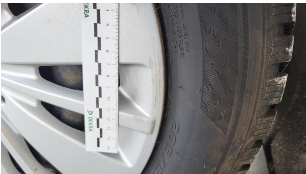
Photo 67. Kołpak tylny P - Rysa/odprysk 1
