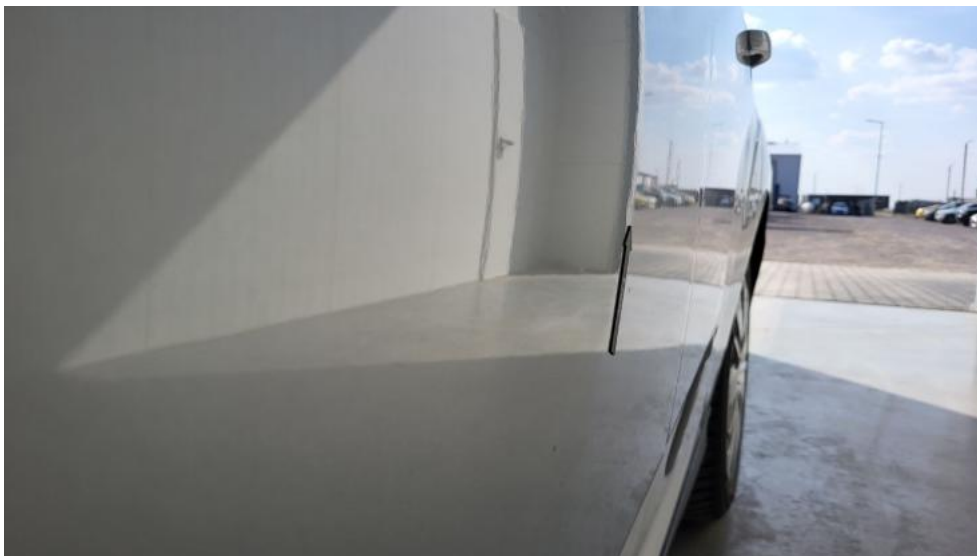
Photo 79. Drzwi przed L - Wgniecenie/odkształcenie 1
