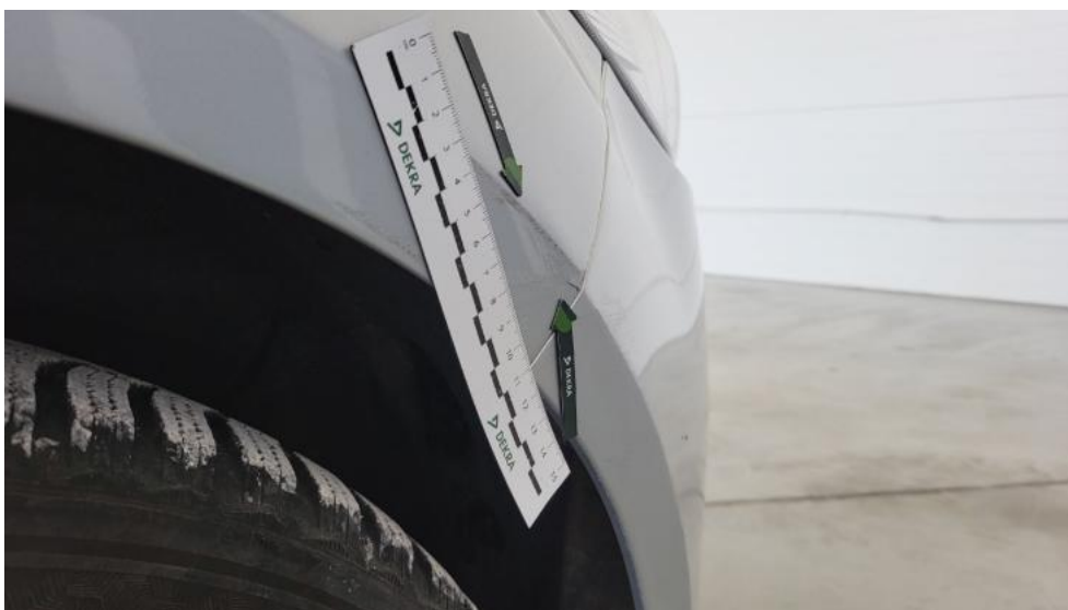
Photo 58. Błotnik przedni P - Wgniecenie/odkształcenie 1
