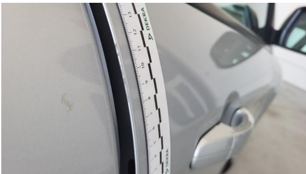
Photo 62. Drzwi przednie P - Rysa/odprysk 1
