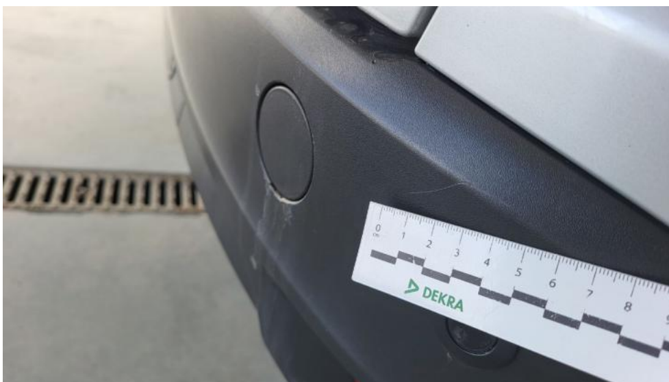
Photo 70. Zderzak tylny - Rysa/odprysk 1
