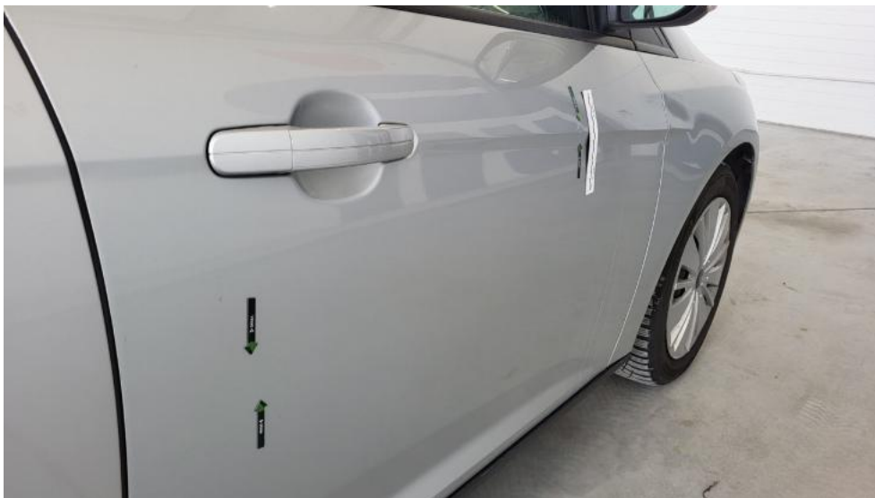
Photo 63. Drzwi przednie P - Wgniecenie/odkształcenie 1
