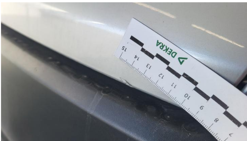
Photo 69. Pokrywy bagażnika - Rysa/odprysk 1
