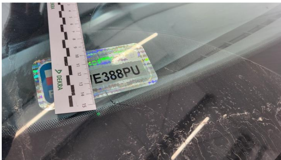
Photo 49. Szyba czołowa - Pęknięcie/rozerwanie 1
