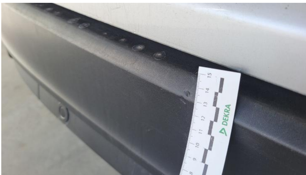
Photo 71. Zderzak tylny - Wgniecenie/odkształcenie 1
