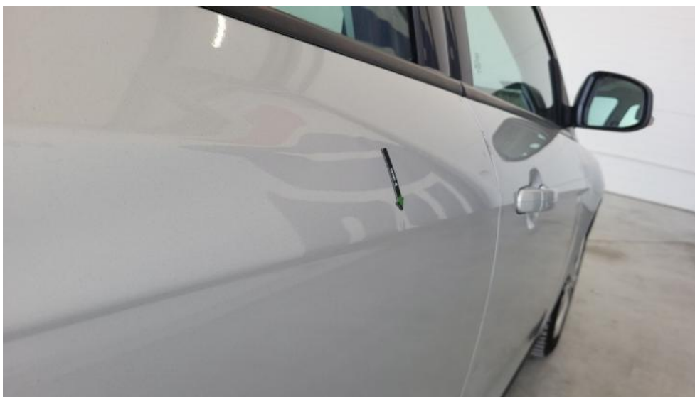
Photo 65. Drzwi tylne P - Wgniecenie/odkształcenie 1
