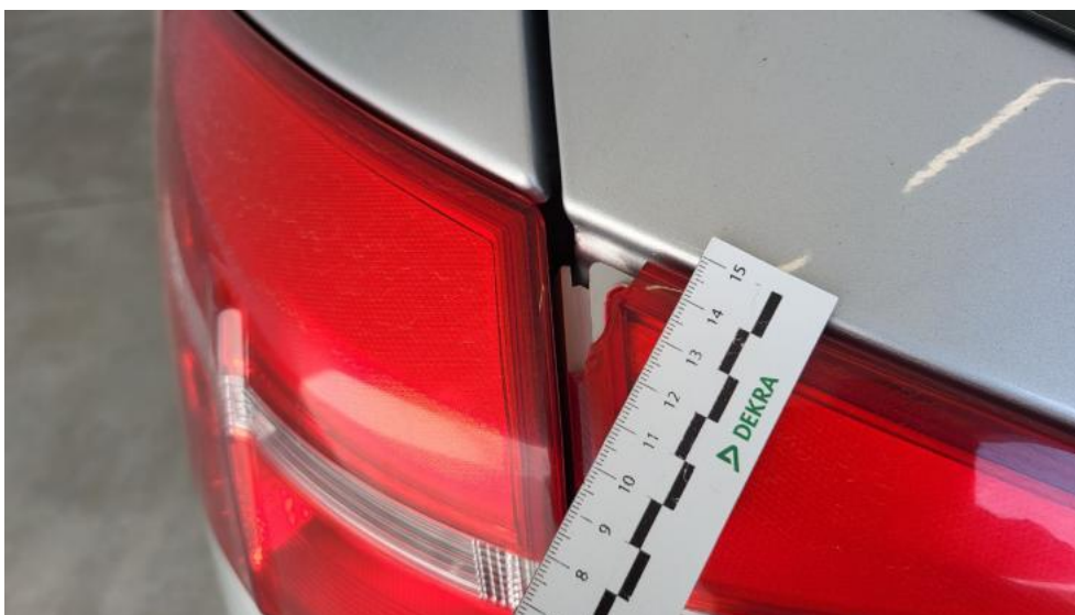
Photo 77. Lampa tylna wew L - Pęknięcie/rozerwanie 1
