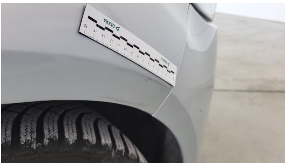
Photo 57. Błotnik przedni P - Rysa/odprysk 1
