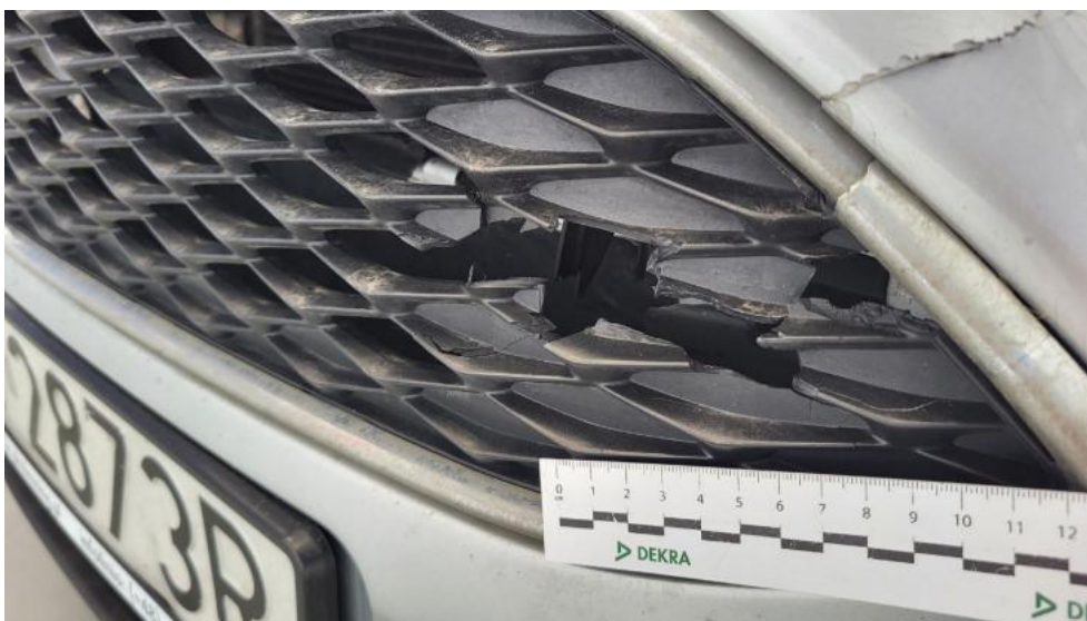
Photo 40. Kratka zderzaka prz. - Pęknięcie/rozerwanie 1
