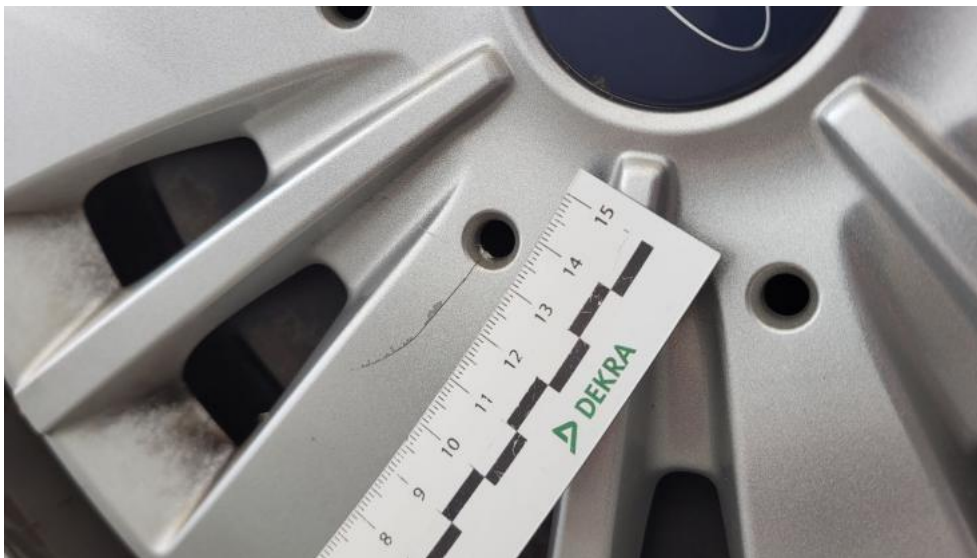
Photo 61. Kołpak przedni P - Pęknięcie/rozerwanie 1
