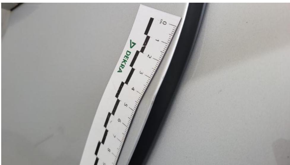
Photo 80. Drzwi tylne L - Rysa/odprysk 1
