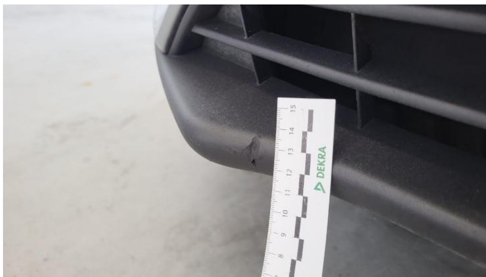
Photo 47. Spoiler zderzaka przedniego - Wgniecenie/odkształcenie 1
