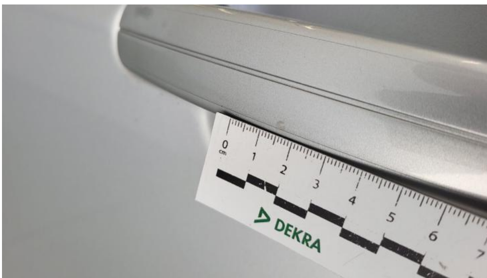
Photo 82. Klamka drzwi tyl L - Rysa/odprysk 1
