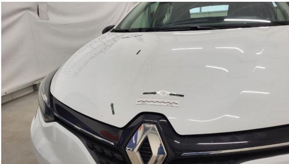
Fot. 39. Pokrywa komory silnika - Wgniecenie/odkształcenie 1
