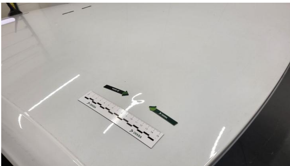
Fot. 55. Dach - Wgniecenie/odkształcenie 1
