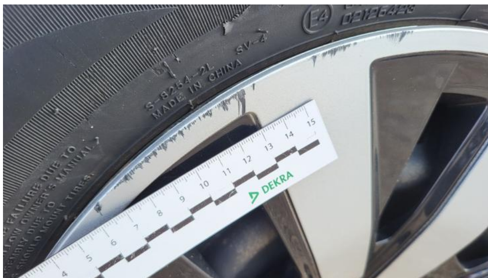
Fot. 49. Kołpak tylny P - Rysa/odprysk 1
