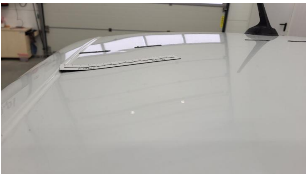
Fot. 56. Dach - Wgniecenie/odkształcenie 2
