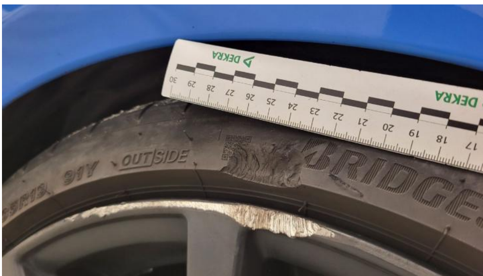
Photo 56. Opona przednia P - Pęknięcie/rozerwanie 1
