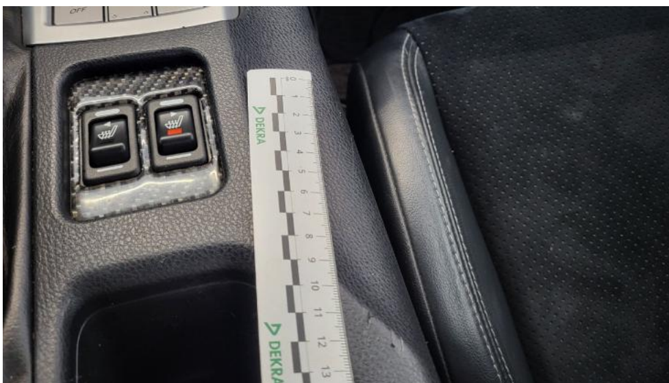
Photo 85. Konsola tunelu śr. - Rysa/odprysk 1
