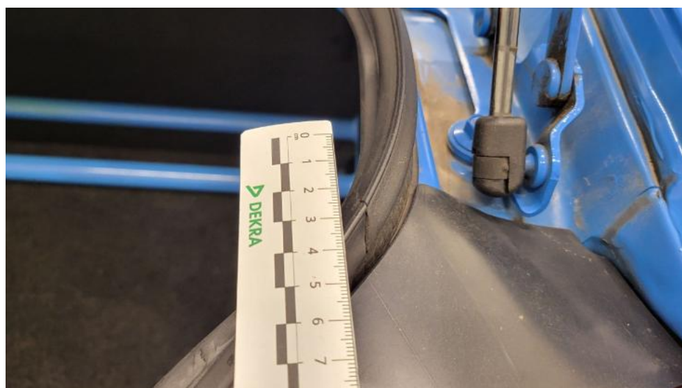
Photo 92. Uszczelka pokrywy tylnej - Pęknięcie/rozerwanie 1
