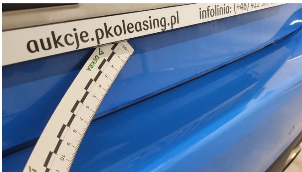
Photo 66. Pokrywy bagażnika - Rysa/odprysk 2
