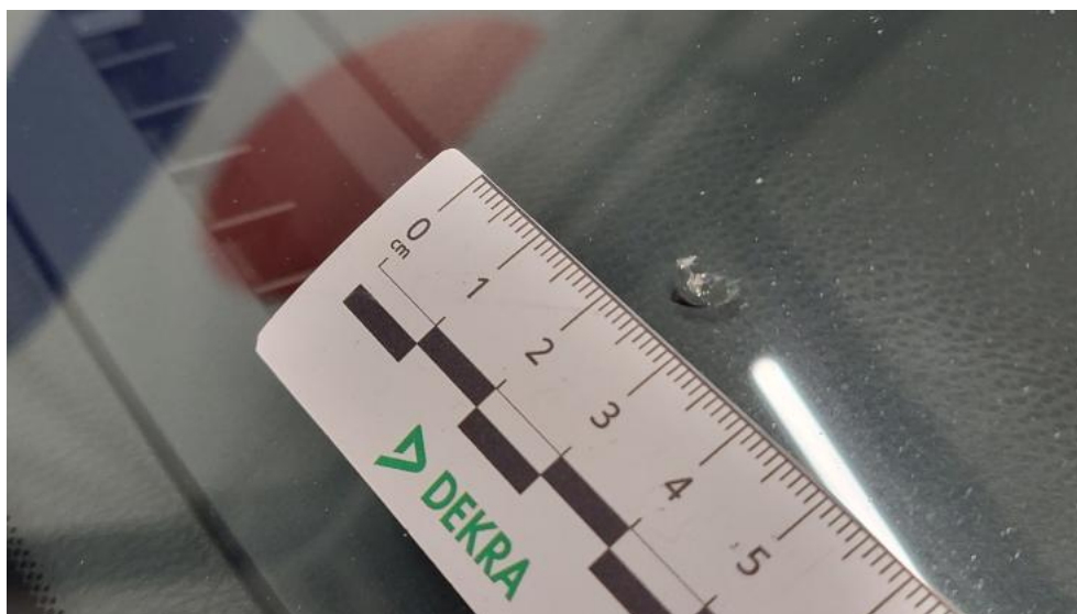
Photo 50. Szyba czołowa - Pęknięcie/rozerwanie 2
