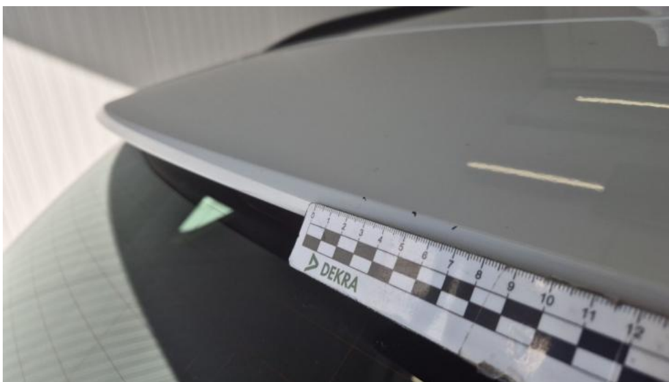
Fot. 50. Pokrywy bagażnika - Rysa/odprysk 1
