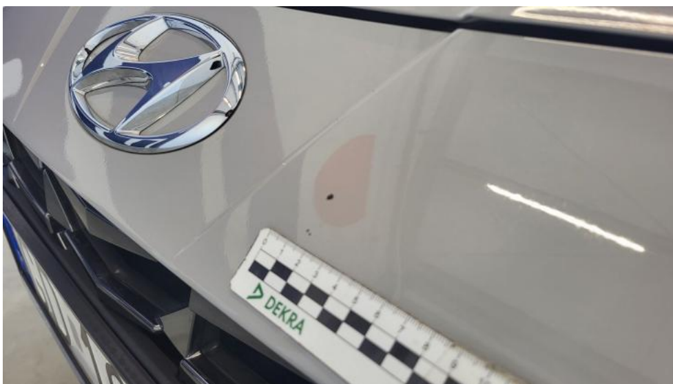
Fot. 36. Zderzak - Rysa/odprysk 1
