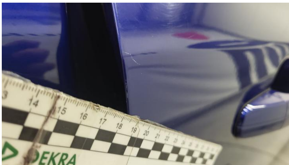
Fot. 45. Drzwi tylne P - Rysa/odprysk 2
