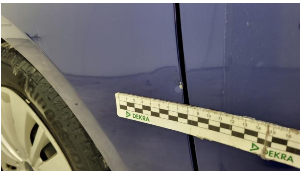
Fot. 54. Błotnik przedni L - Rysa/odprysk 1
