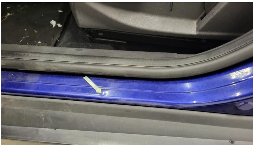
Fot. 53. Próg L - Wgniecenie/odkształcenie 1
