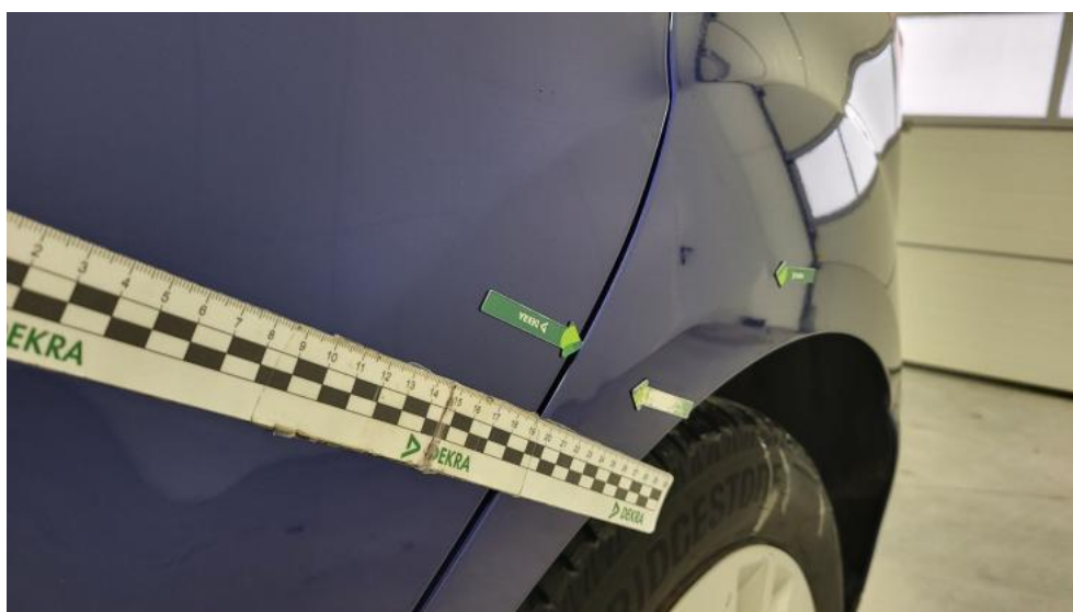
Fot. 50. Błotnik tylny L / Ściana boczna L - Wgniecenie/odkształcenie 1
