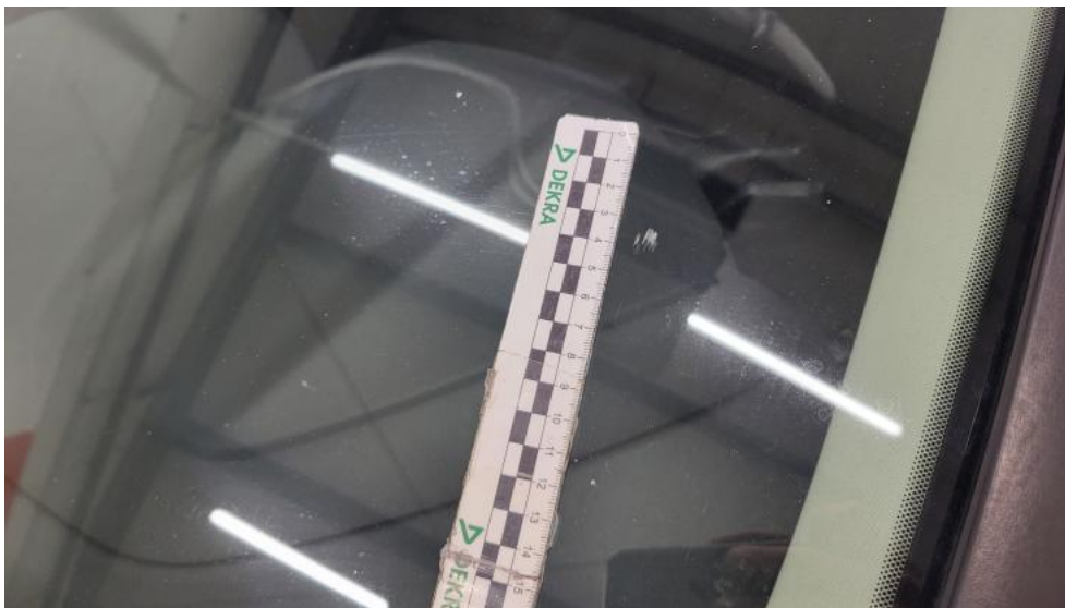
Fot. 39. Szyba czołowa - Rysa/odprysk 1
