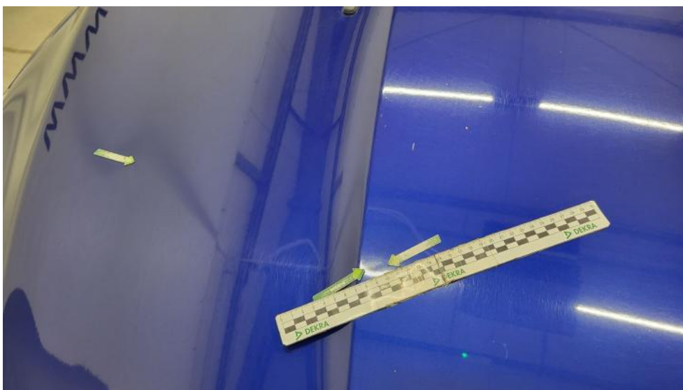
Fot. 37. Pokrywa komory silnika - Wgniecenie/odkształcenie 1
