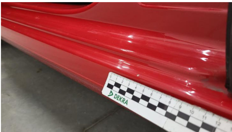
Photo 77. Próg L - Rysa/odprysk 2
