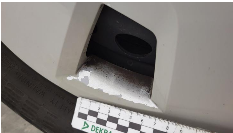
Photo 48. Kołpak przedni P - Rysa/odprysk 1
