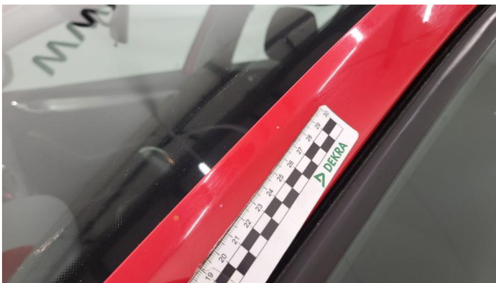
Photo 78. Słupek przedni L - Rysa/odprysk 1
