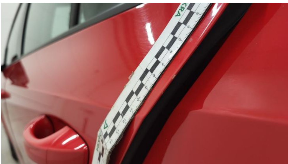
Photo 74. Drzwi tylne L - Rysa/odprysk 2
