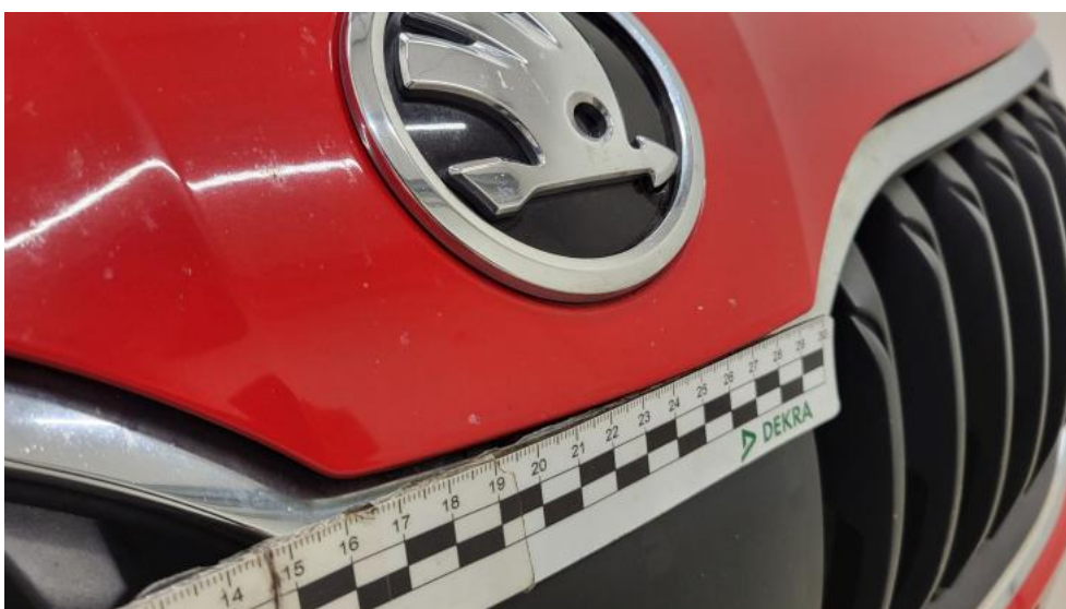
Photo 36. Pokrywa komory silnika - Rysa/odprysk 2
