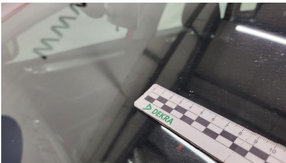
Photo 39. Szyba czołowa - Rysa/odprysk 1
