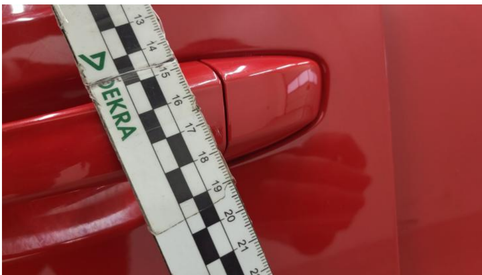
Photo 75. Klamka drzwi prz L - Rysa/odprysk 1
