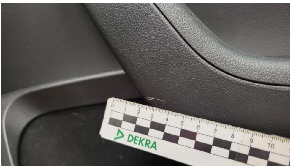
Photo 87. Uchwyt drzwi prze P - Rysa/odprysk 1
