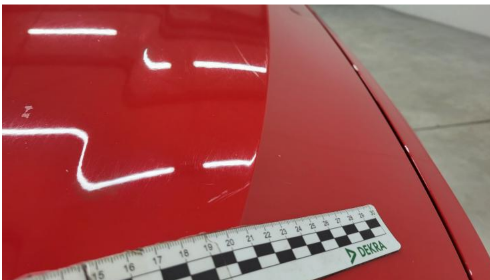
Photo 37. Pokrywa komory silnika() - Rysa/odprysk 3
