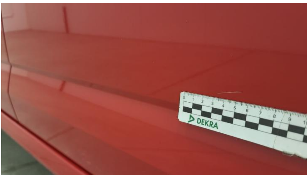
Photo 73. Drzwi tylne L - Rysa/odprysk 1
