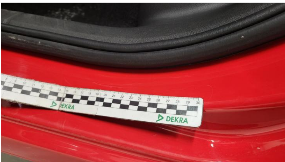
Photo 76. Próg L - Rysa/odprysk 1
