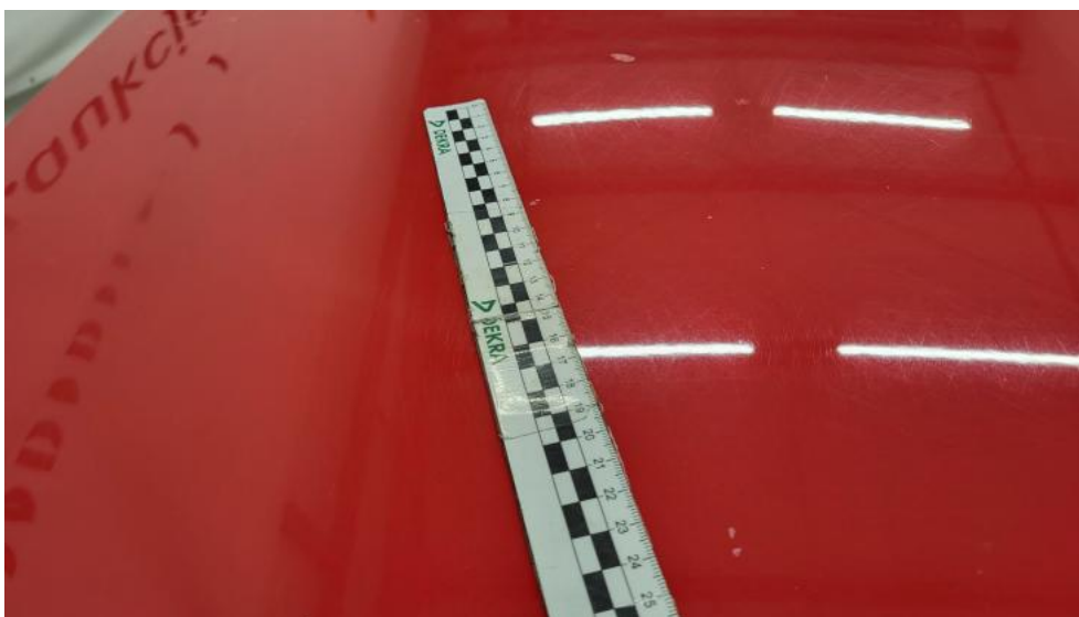
Photo 35. Pokrywa komory silnika - Rysa/odprysk 1
