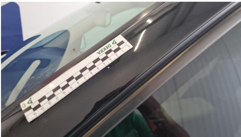
Photo 67. Stupek przedni L - Rysa/odprysk 1
