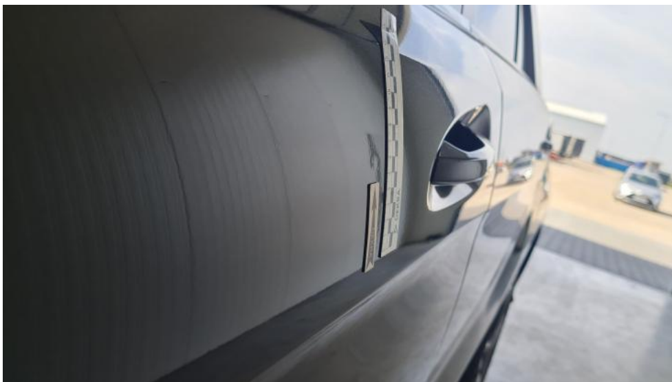
Photo 63. Drzwi przed L - Wgniecenie/odkształcenie 1
