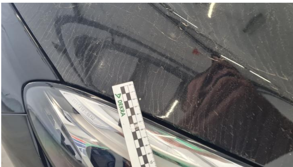
Photo 38. Pokrywa komory silnika - Rysa/odprysk 1
