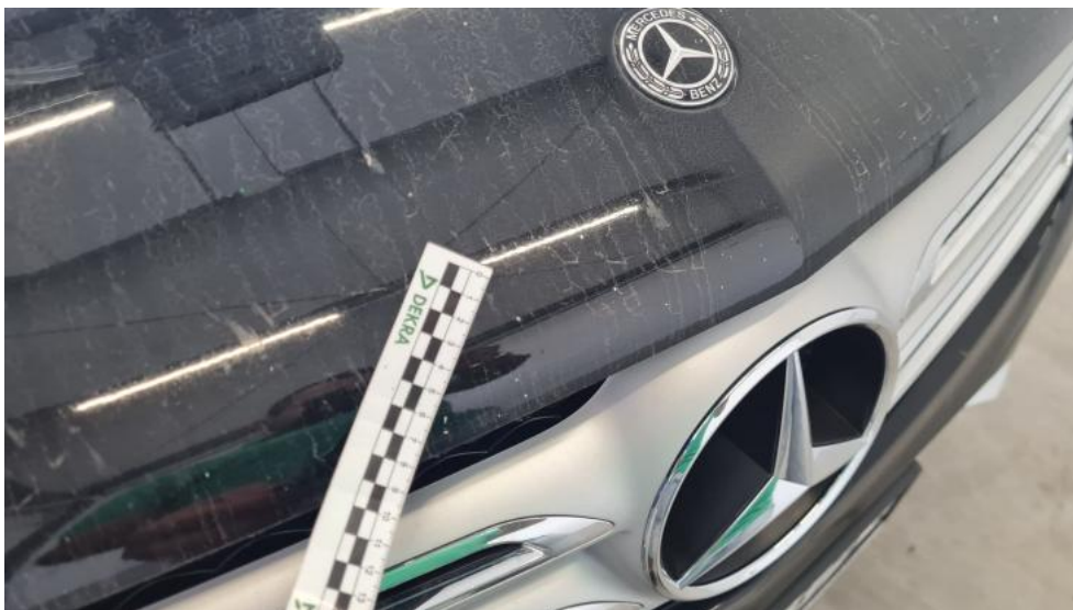
Photo 39. Pokrywa komory silnika - Rysa/odprysk 2
