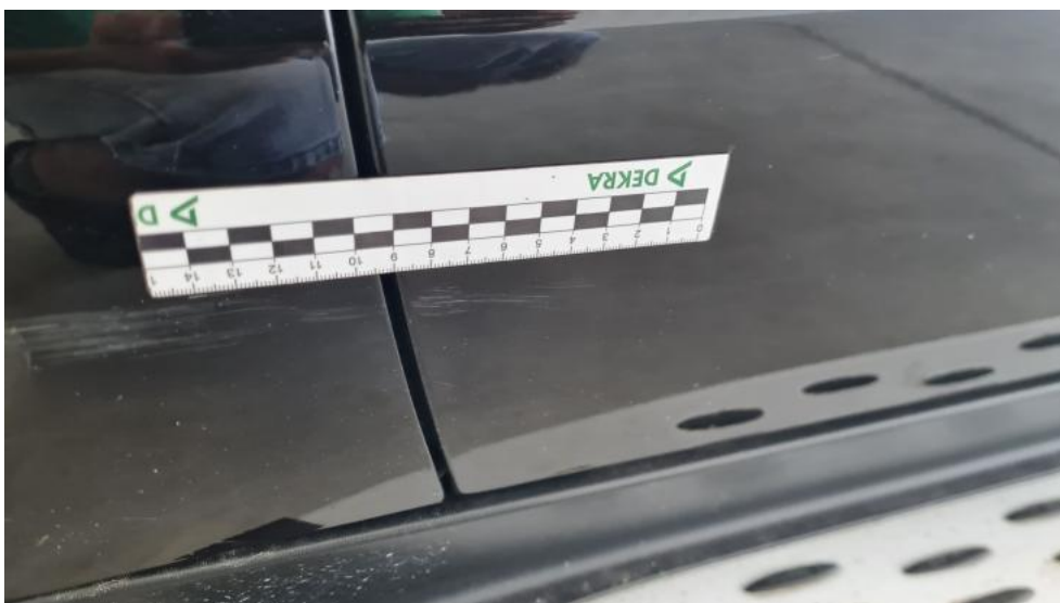
Photo 62. Drzwi przed L - Rysa/odprysk 2
