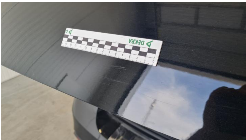
Photo 53. Pokrywy bagażnika - Rysa/odprysk 1
