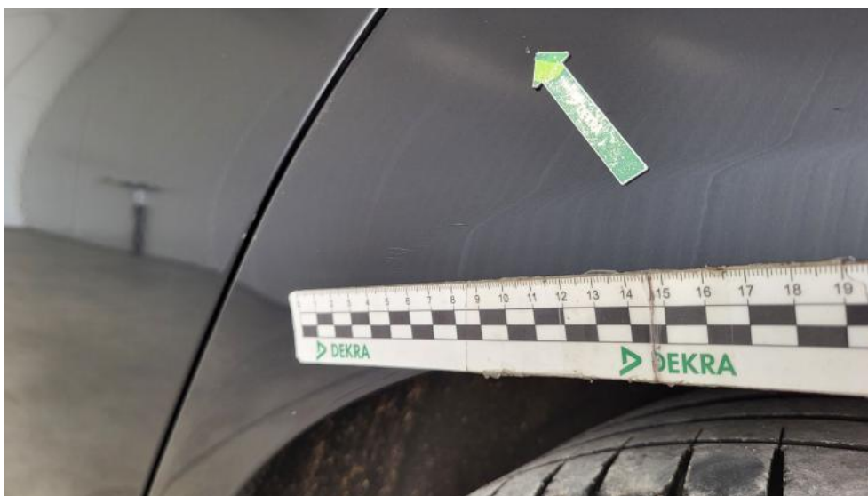
Fot. 78. Błotnik tylny L / Ściana boczna L - Rysa/odprysk 2
