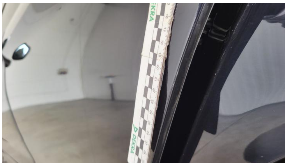
Fot. 86. Drzwi tylne L - Rysa/odprysk 1
