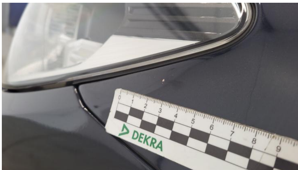
Fot. 93. Błotnik przedni L() - Rysa/odprysk 3
