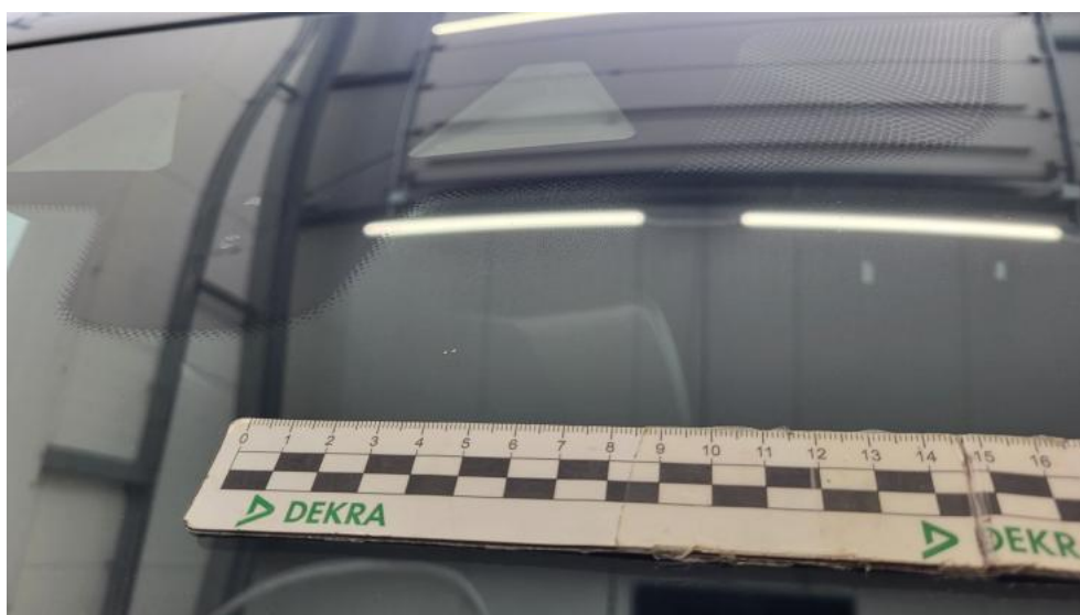
Fot. 54. Szyba czołowa - Rysa/odprysk 2
