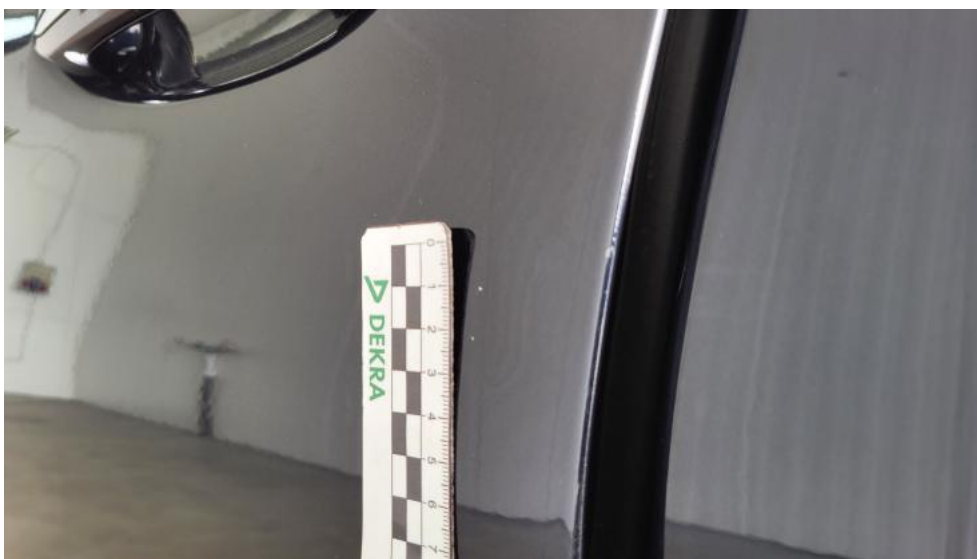
Fot. 83. Drzwi przed L - Rysa/odprysk 2
