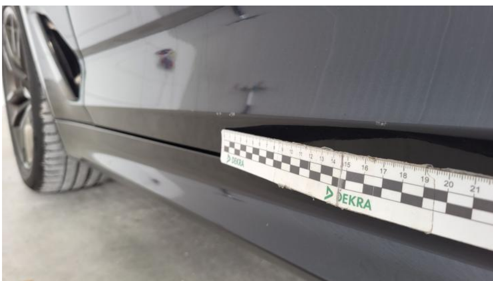
Fot. 84. Drzwi przed L() - Rysa/odprysk 3
