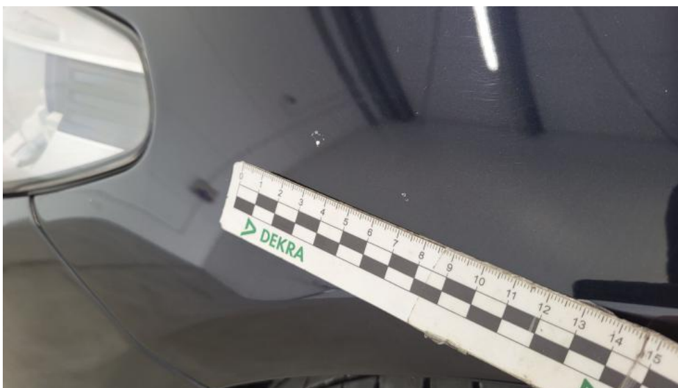
Fot. 91. Błotnik przedni L - Rysa/odprysk 1
