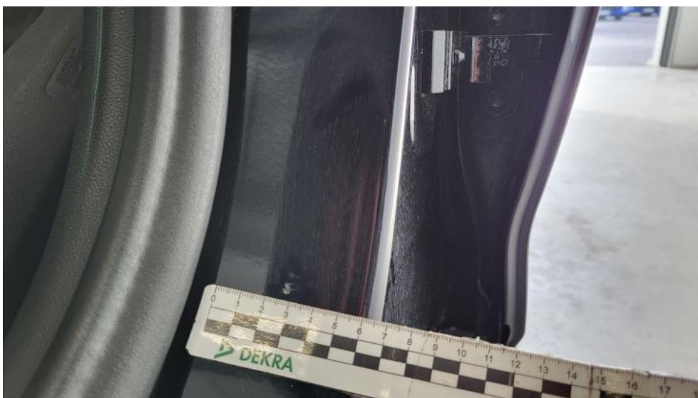
Fot. 88. Słupek środkowy L - Rysa/odprysk 1
