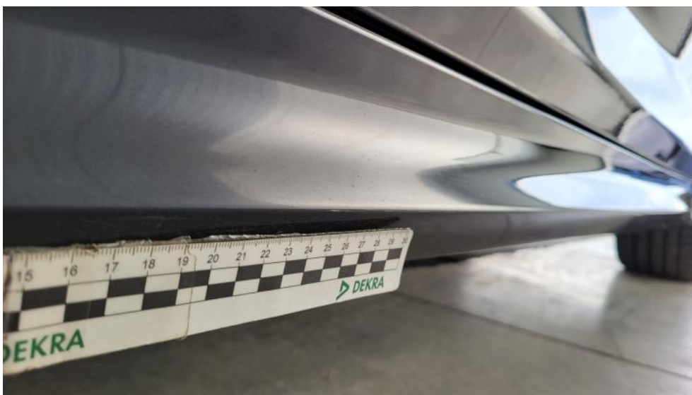
Fot. 87. Próg L - Rysa/odprysk 1
