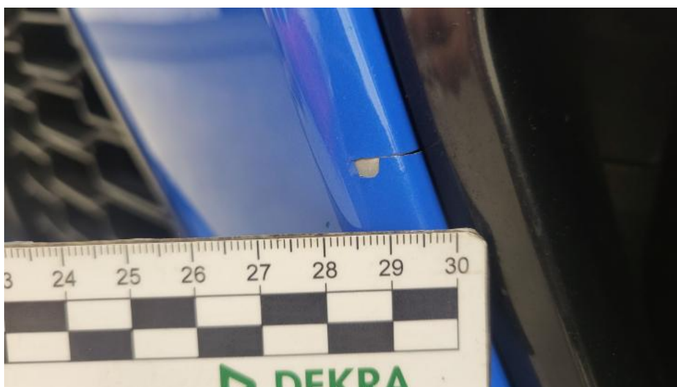
Fot. 46. Zderzak - Pęknięcie/rozerwanie 1
