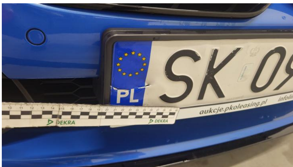
Fot. 47. Tablica rejestracyjna- Pęknięcie/rozerwanie 2
