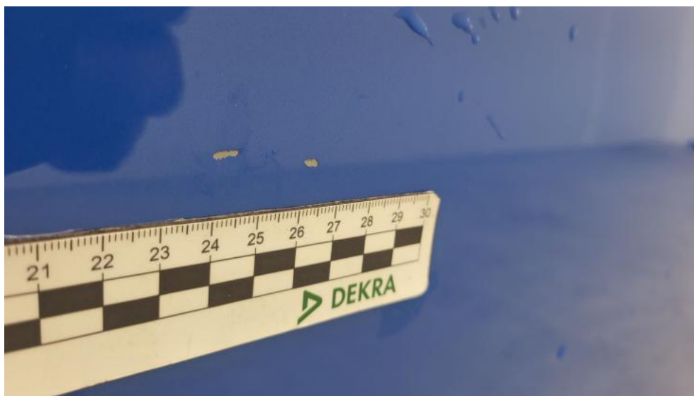
Fot. 49. Drzwi przed L - Rysa/odprysk 1
