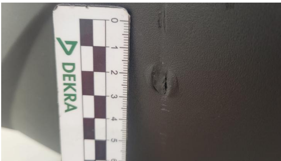
Photo 47. Zderzak tylny - Pęknięcie/rozerwanie 1
