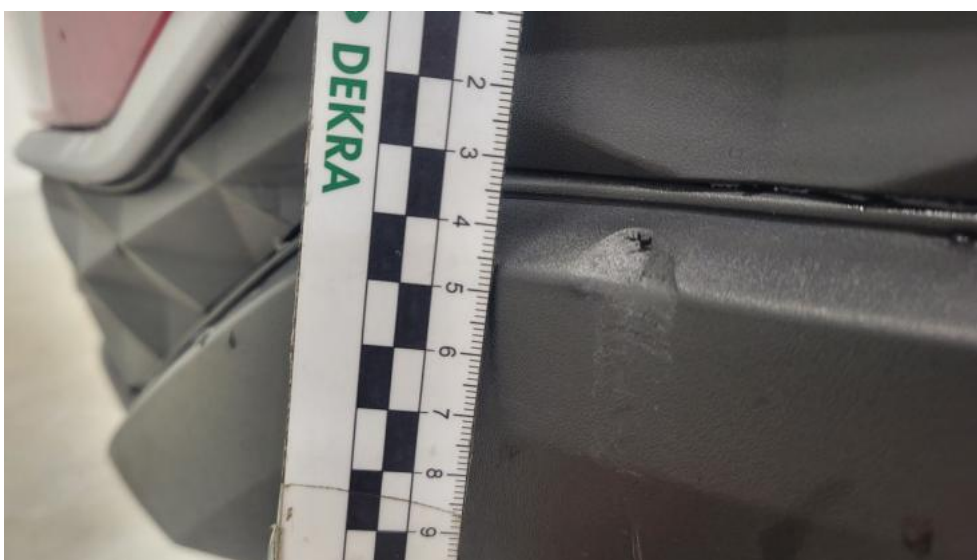
Photo 48. Zderzak tylny - Pęknięcie/rozerwanie 2
