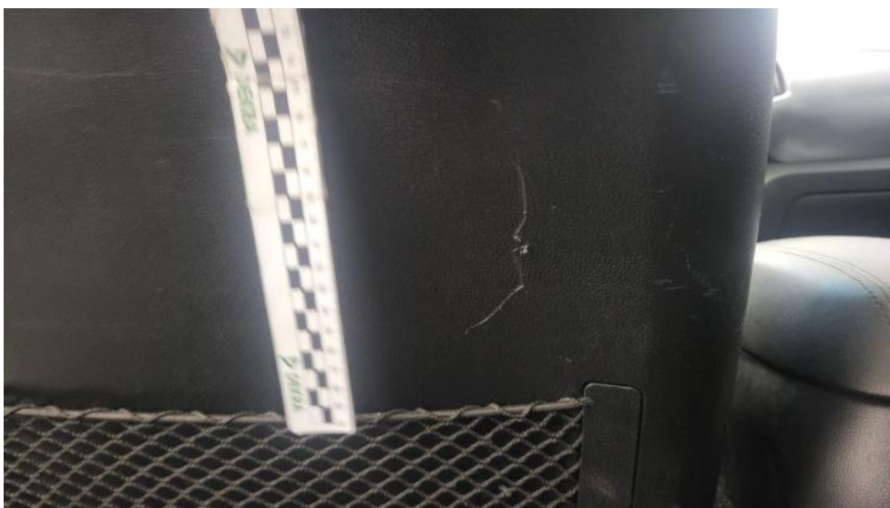
Fot. 124. Fotel prz. lew. - Rysa/odprysk 1
