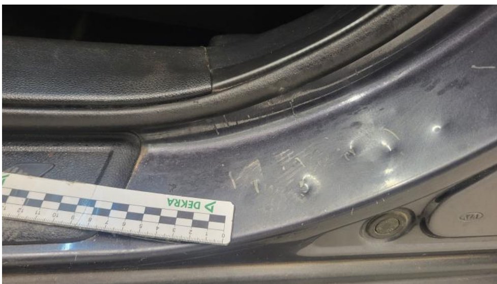
Fot. 109. Próg L - Rysa/odprysk 1
