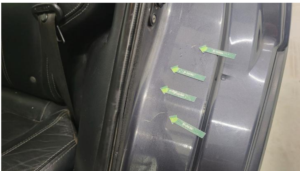
Fot. 100. Błotnik tylny L / Ściana boczna L - Wgniecenie/odkształcenie 1
