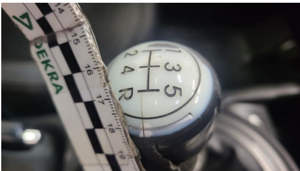
Fot. 120. Gałka dźwigni zmiany biegów - Pęknięcie/rozerwanie 1
