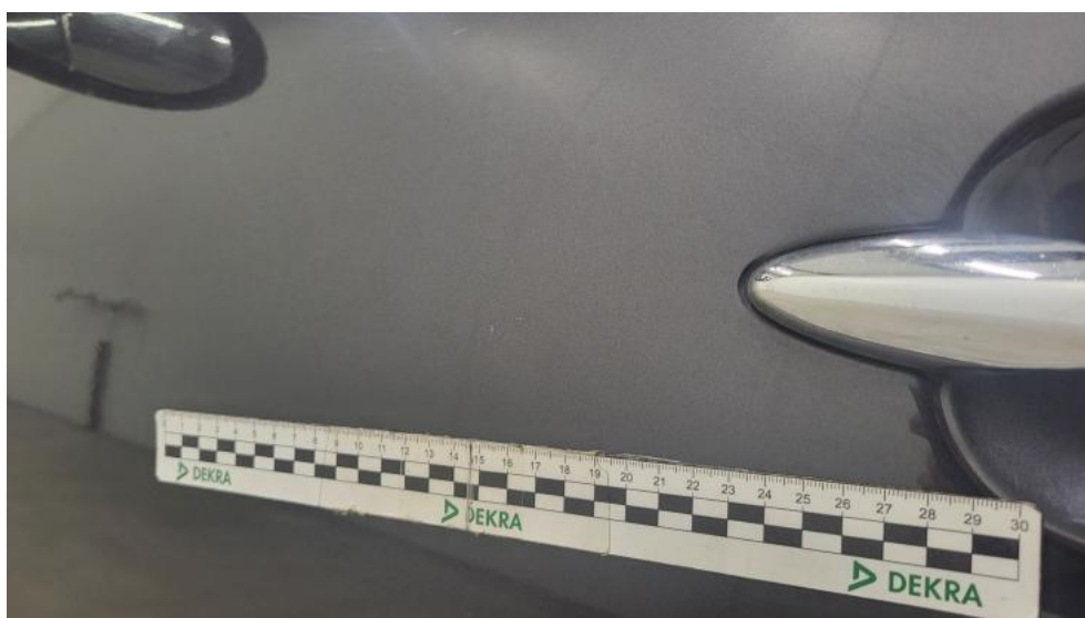
Fot. 104. Drzwi przed L - Rysa/odprysk 1
