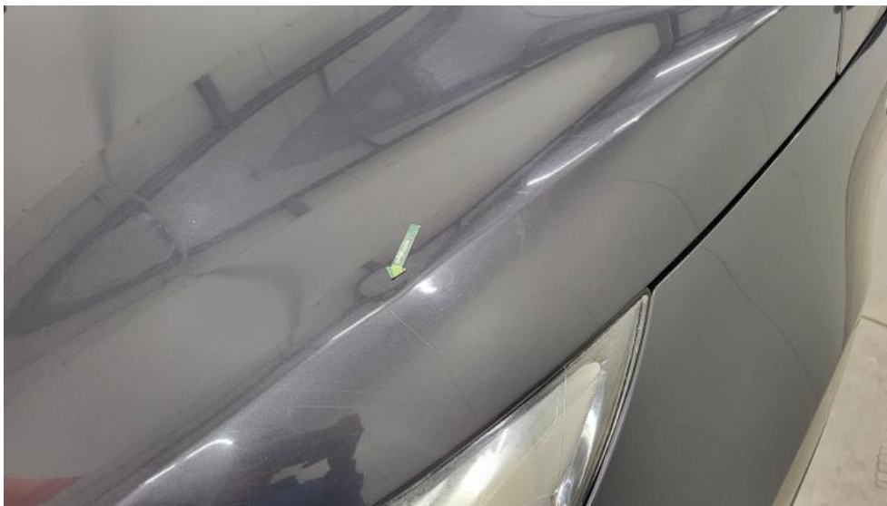
Fot. 47. Pokrywa komory silnika - Wgniecenie/odkształcenie 1
