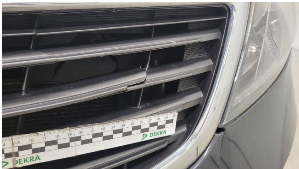
Fot. 43. Atrapa przednia - Pęknięcie/rozerwanie 1
