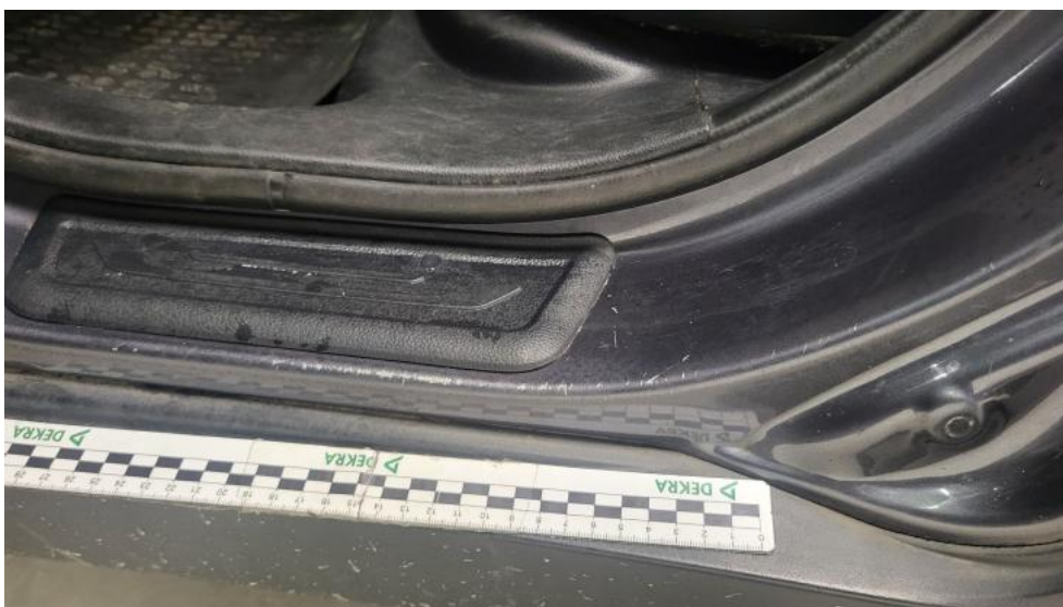
Fot. 110. Próg L - Rysa/odprysk 2
