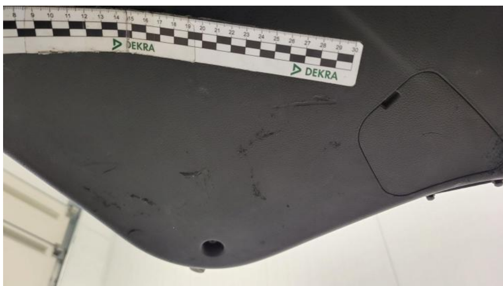
Fot. 146. Wykładzina pokrywy tylnej - Wgniecenie/odkształcenie 1
