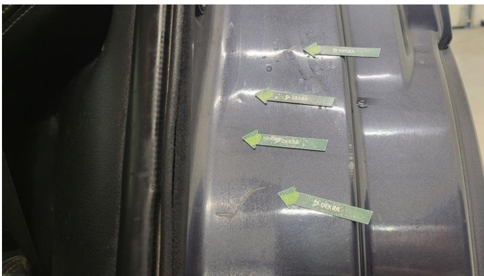
Fot. 102. Błotnik tylny L / Ściana boczna L() - Wgniecenie/odkształcenie 3
