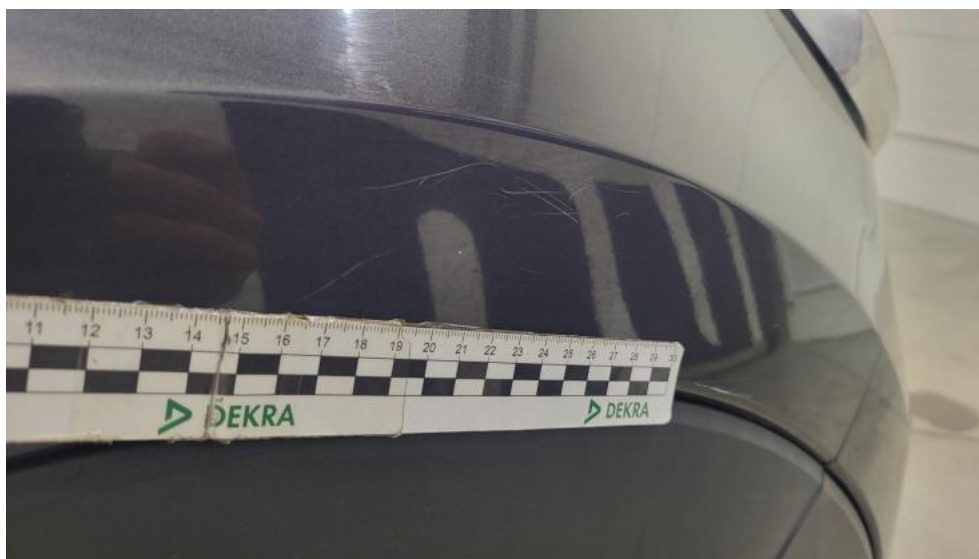
Fot. 63. Błotnik przedni P - Rysa/odprysk 1
