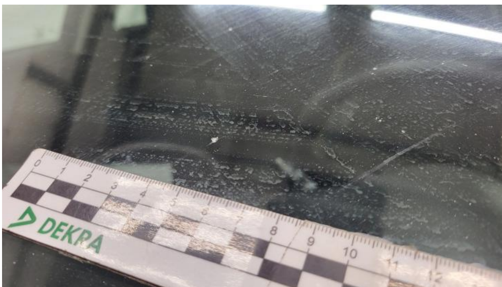
Fot. 55. Szyba czołowa - Rysa/odprysk 1
