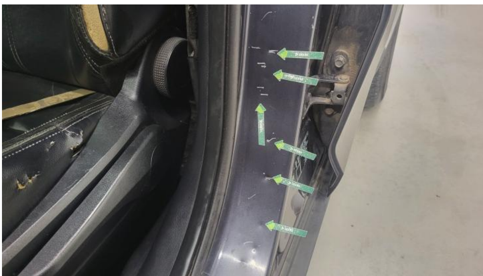
Fot. 115. Słupek środkowy L - Wgniecenie/odkształcenie 1
