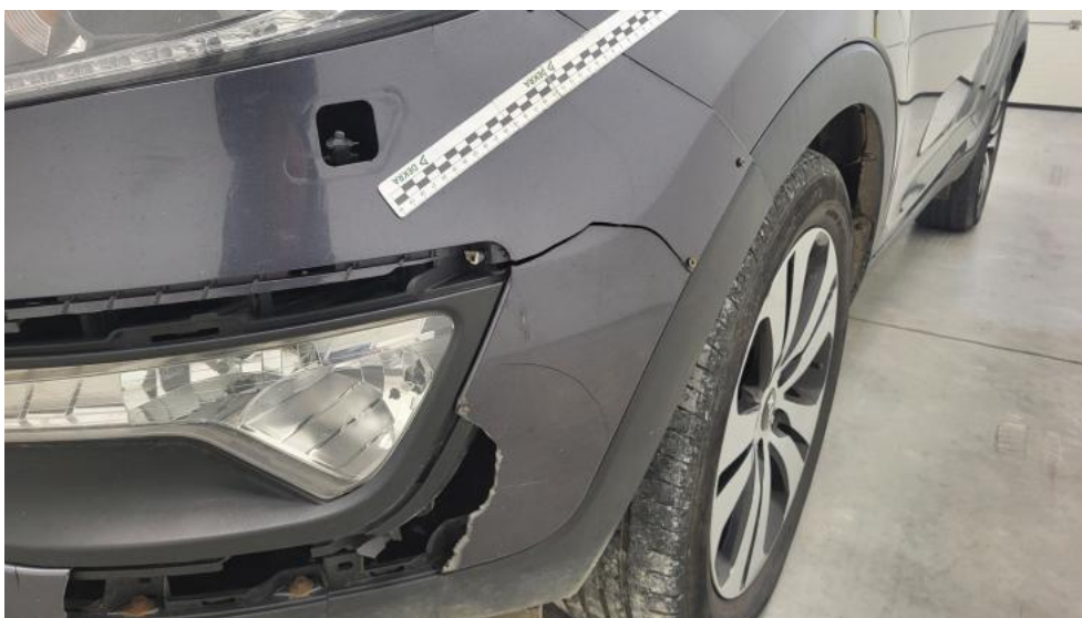
Fot. 60. Zderzak() - Pęknięcie/rozerwanie 3
