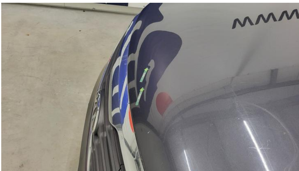
Fot. 48. Pokrywa komory silnika - Wgniecenie/odkształcenie 2
