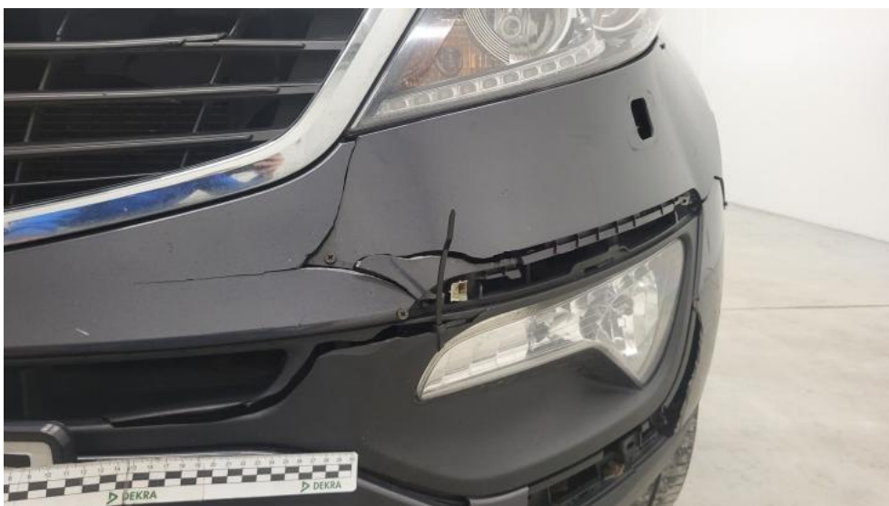
Fot. 58. Zderzak - Pęknięcie/rozerwanie 1
