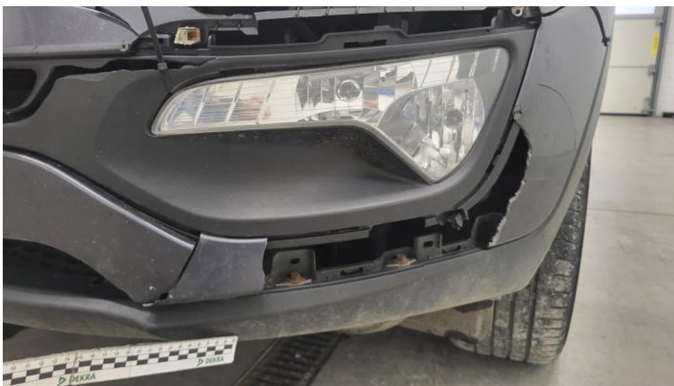
Fot. 59. Zderzak - Pęknięcie/rozerwanie 2
