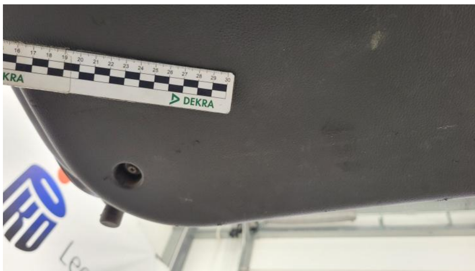
Fot. 145. Wykładzina pokrywy tylnej - Rysa/odprysk 2
