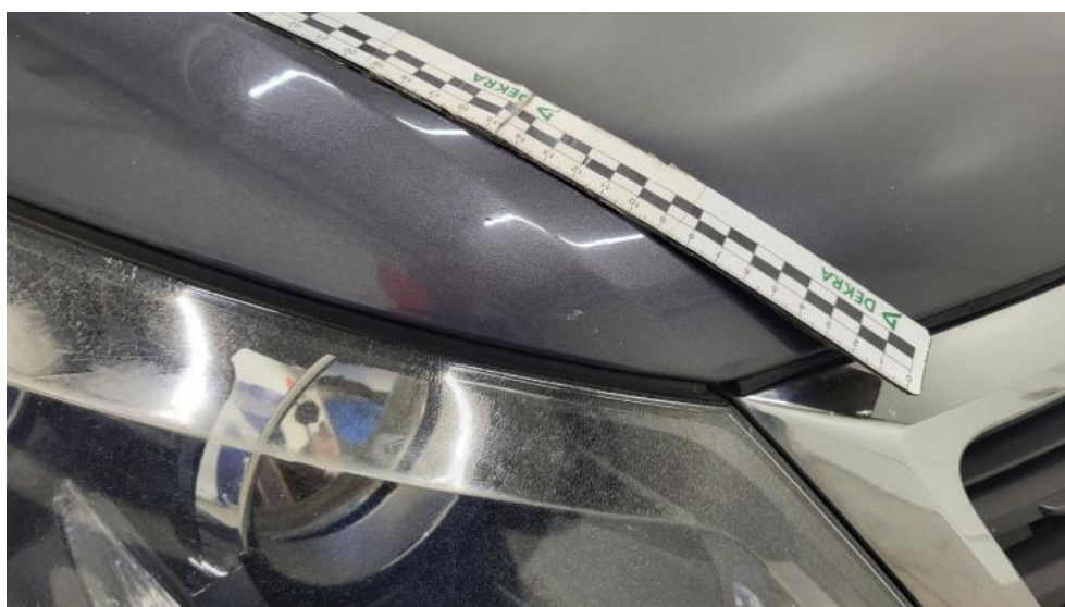
Fot. 46. Pokrywa komory silnika - Rysa/odprysk 2
