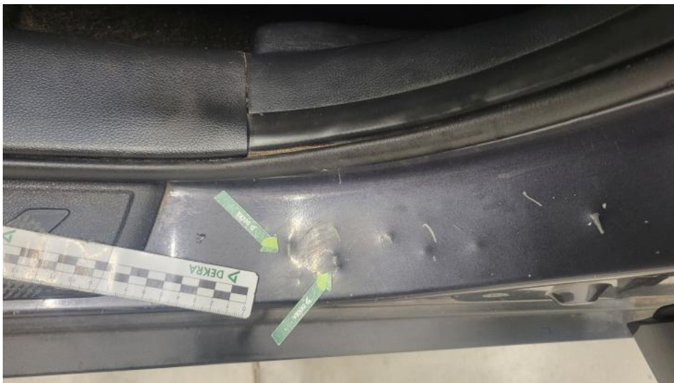
Fot. 111. Próg L - Wgniecenie/odkształcenie 1
