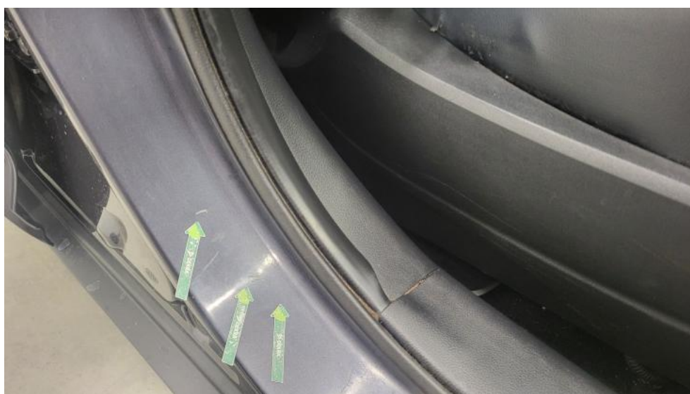
Fot. 72. Słupek środkowy P - Wgniecenie/odkształcenie 1
