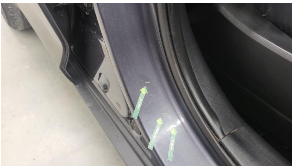
Fot. 74. Słupek środkowy P() - Wgniecenie/odkształcenie 3
