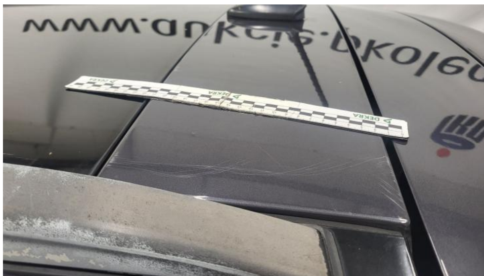
Fot. 87. Dach - Rysa/odprysk 1
