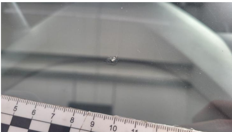
Photo 40. Szyba czołowa - Rysa/odprysk 1
