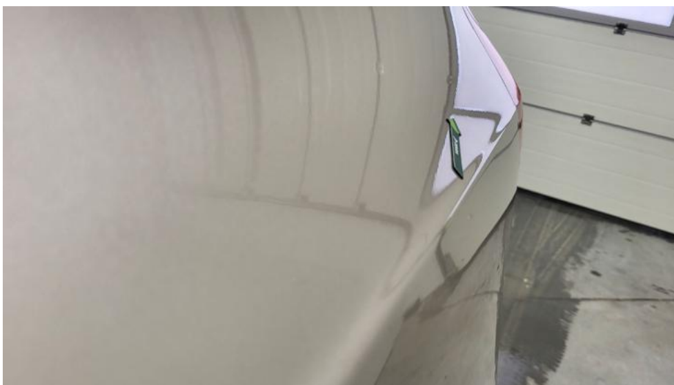
Photo 64. Błotnik tylny L / Ściana boczna L - Wgniecenie/odkształcenie 1
