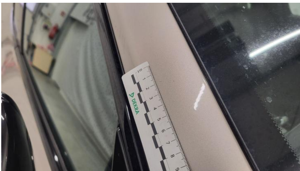
Photo 56. Słupek przedni P - Rysa/odprysk 1
