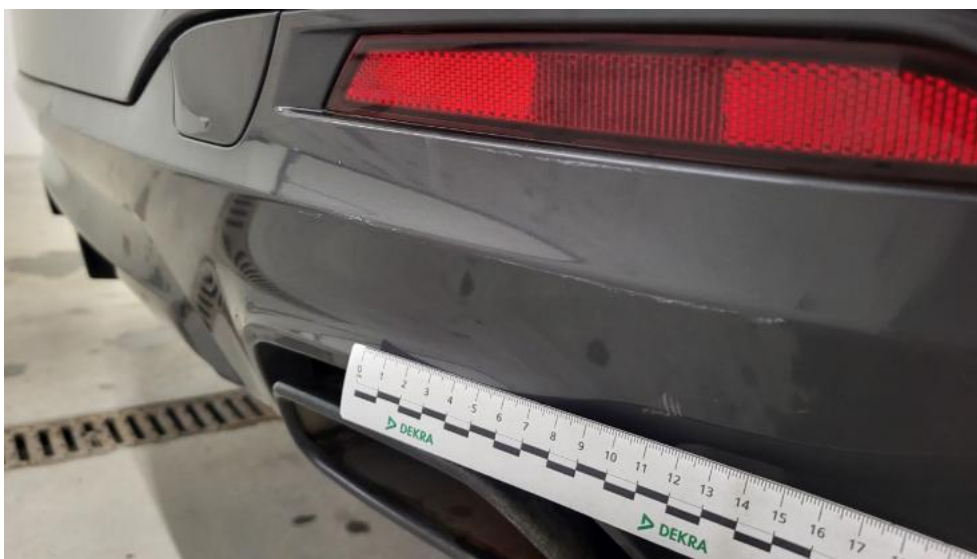
Photo 63. Zderzak tylny cz dolna - Rysa/odprysk 1
