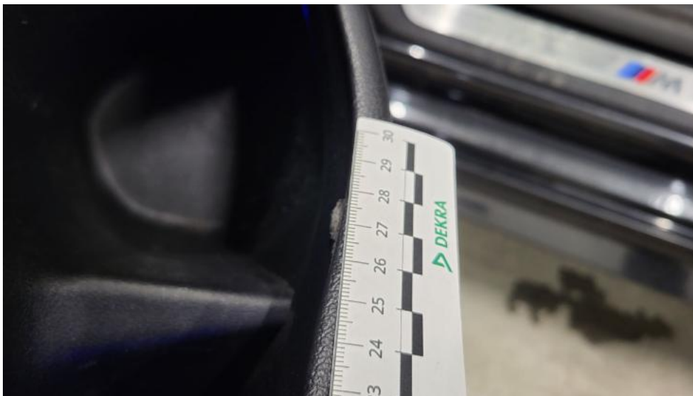
Photo 71. Tapicerka drzwi przednich L - Pęknięcie/rozerwanie 1
