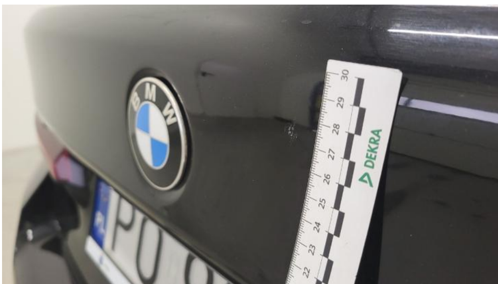
Photo 60. Pokrywy bagażnika - Rysa/odprysk 1
