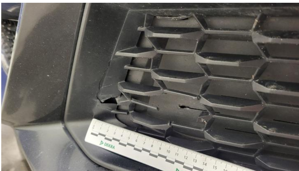
Photo 40. Kratka/zaślepka halogenu L - Pęknięcie/rozerwanie 1
