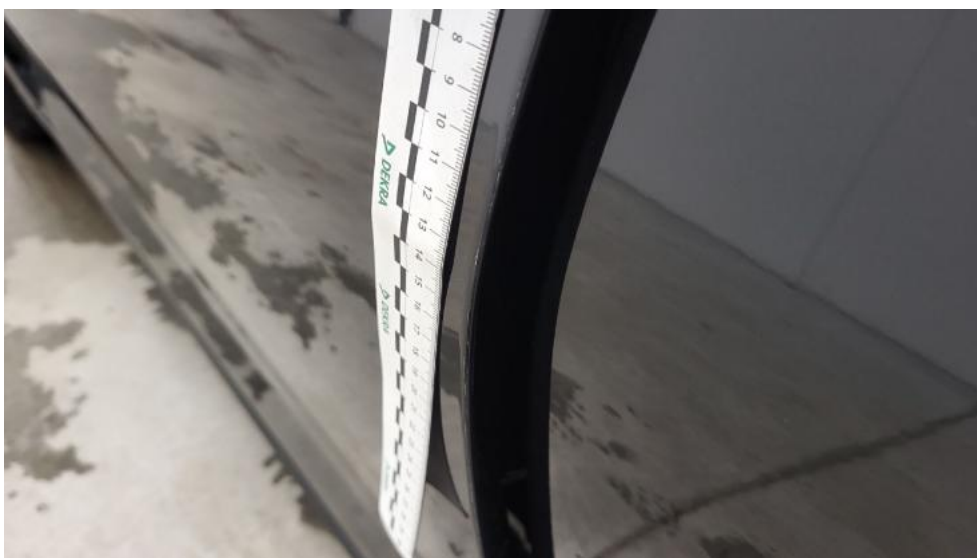
Photo 66. Drzwi przed L - Rysa/odprysk 1
