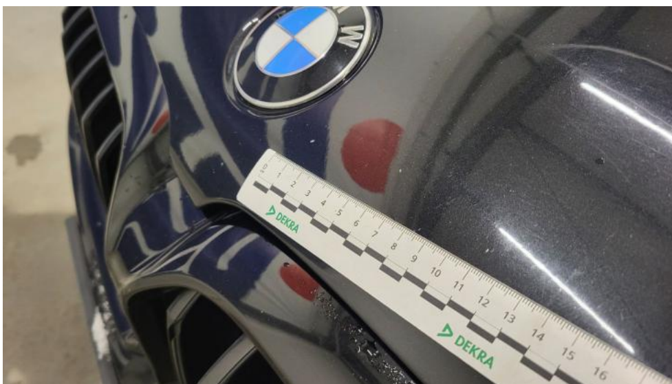
Photo 41. Pokrywa komory silnika - Rysa/odprysk 1
