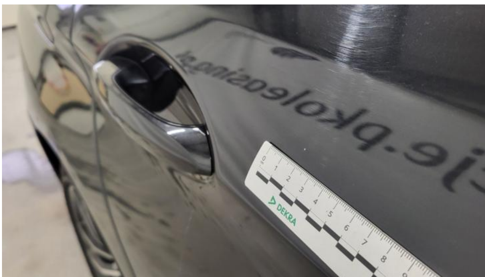
Photo 56. Drzwi tylne P - Rysa/odprysk 1
