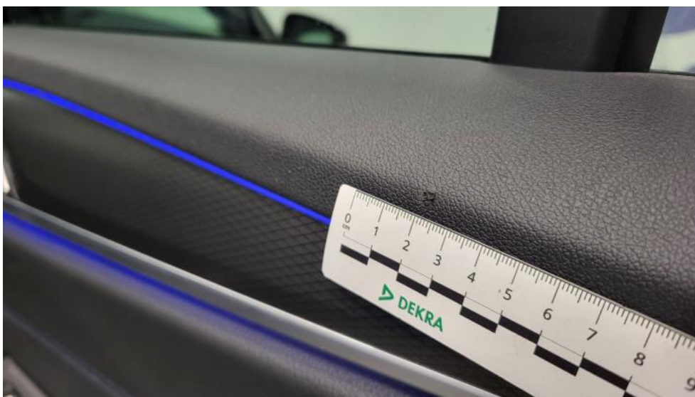
Photo 74. Tapicerka drzwi tylnych P - Rysa/odprysk 1
