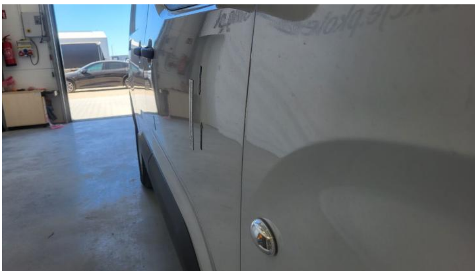
Fot. 44. Drzwi przednie P - Wgniecenie/odkształcenie 1
