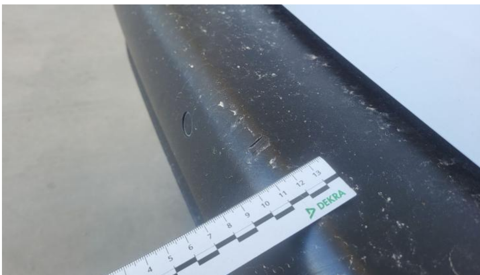
Fot. 47. Zderzak tylny - Wgniecenie/odkształcenie 1
