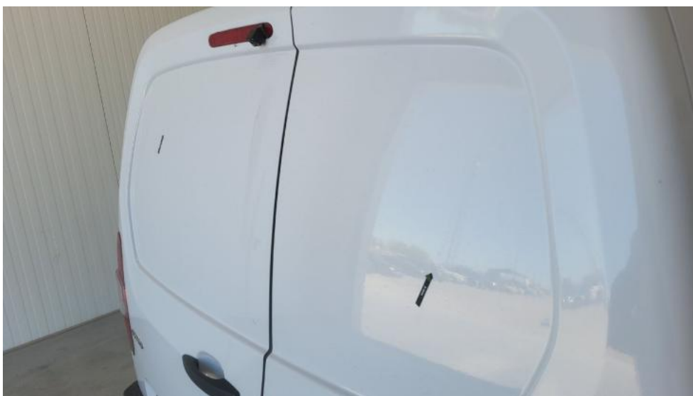
Fot. 46. Pokrywy bagażnika - Wgniecenie/odkształcenie 1
