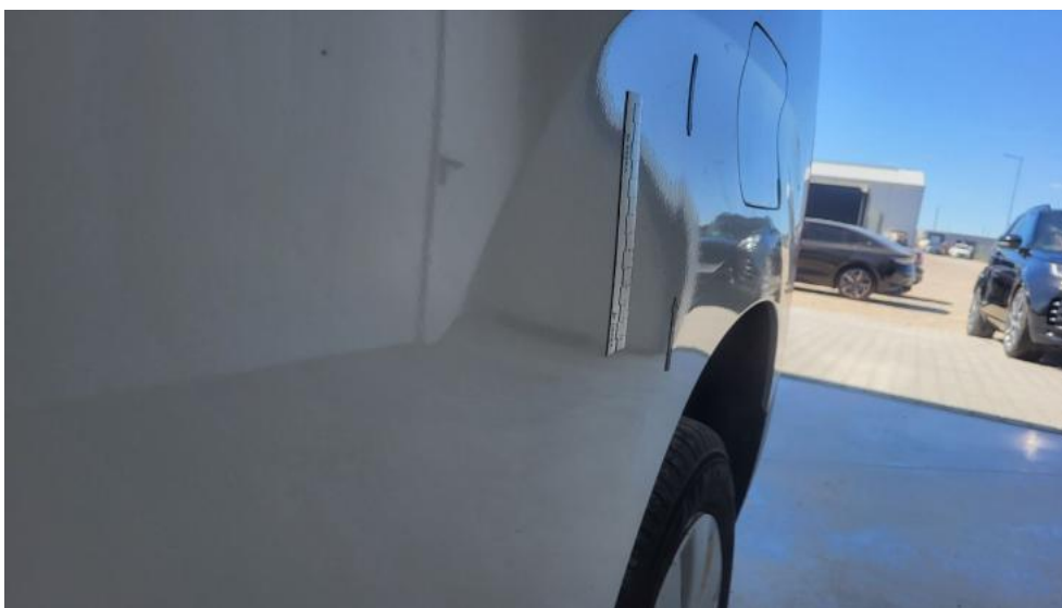
Fot. 49. Błotnik tylny L / Ściana boczna L - Wgniecenie/odkształcenie 2
