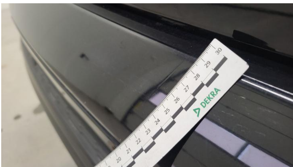
Fot. 52. Zderzak tylny - Wgniecenie/odkształcenie 1
