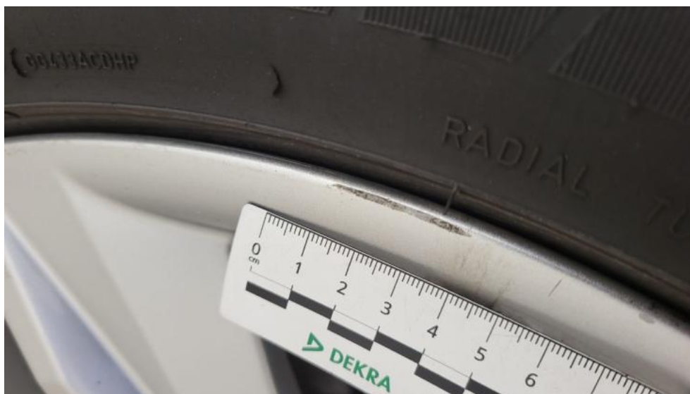
Fot. 47. Felga aluminiowa przednia P - Rysa/odprysk 1
