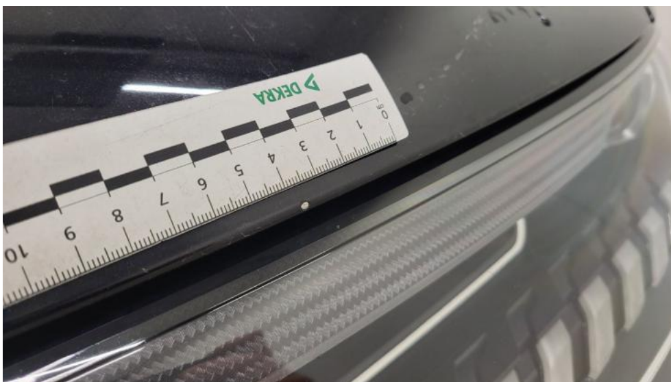
Fot. 44. Pokrywa komory silnika - Rysa/odprysk 1
