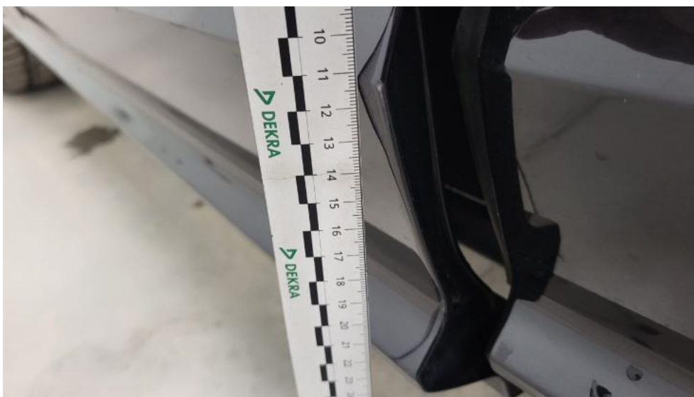
Fot. 55. Listwa drzwi przednich L - Rysa/odprysk 1
