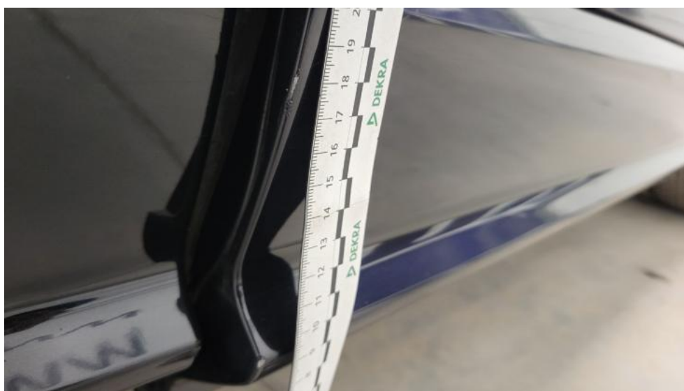
Fot. 48. Listwa drzwi przednich P - Rysa/odprysk 1
