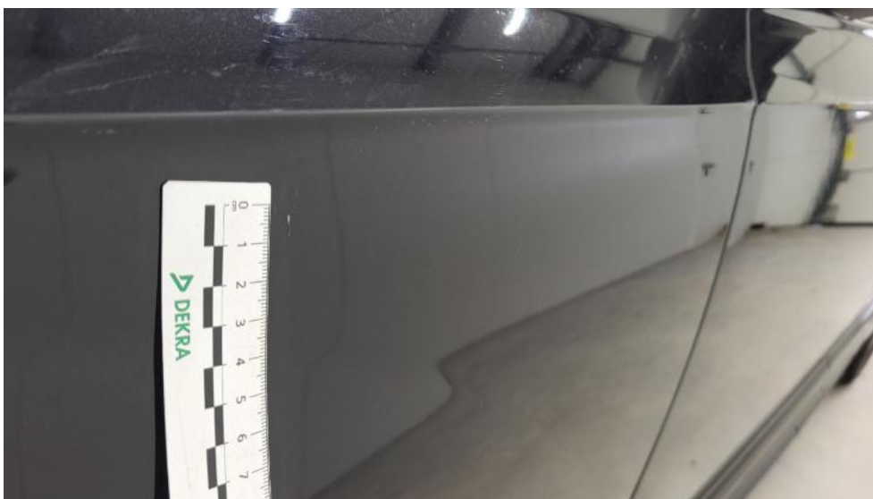
Fot. 58. Błotnik przedni L - Rysa/odprysk 1
