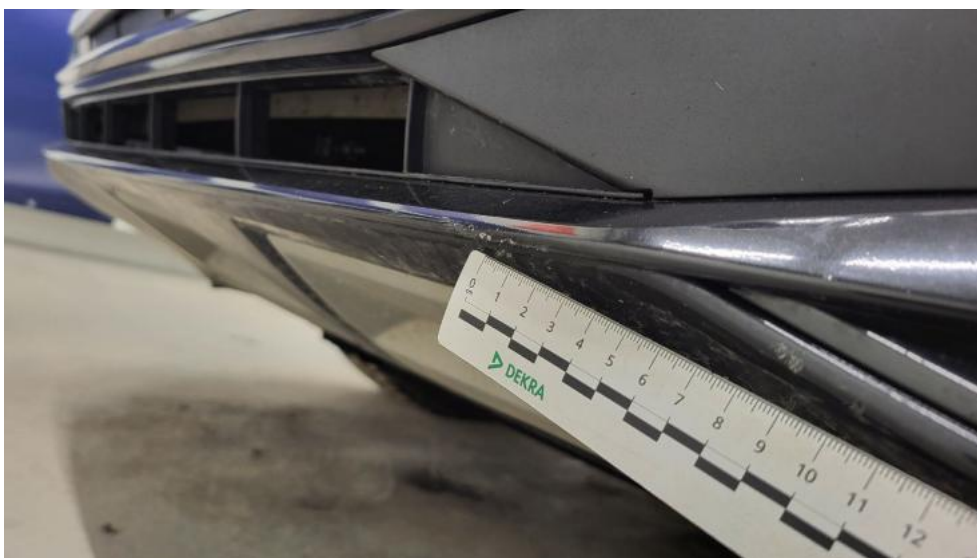
Fot. 46. Spoiler zderzaka przedniego - Rysa/odprysk 1
